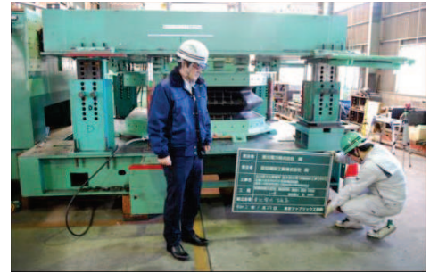
伸び変形後状況
