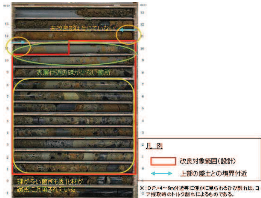
図 6.4-14 ボーリングコア写真 (⑤孔)
