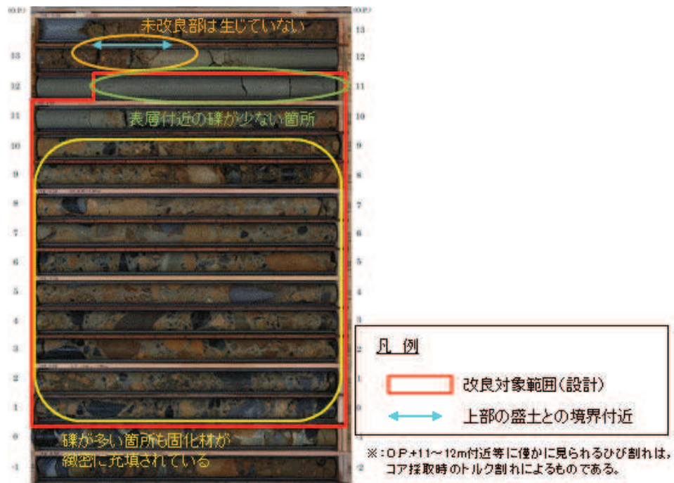
図 6.4-11 ボーリングコア写真 (②孔)
