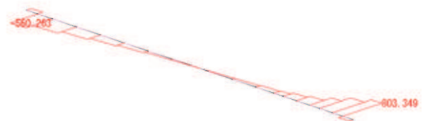
せん断力 Sz 図 角型鋼管 (kN)
