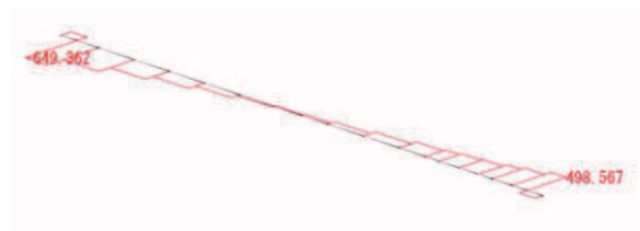
せん断力 Sz 図 角型鋼管 (kN)
