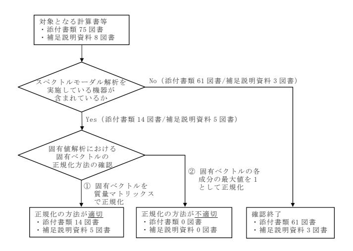
図1 固有値解析における固有ベクトルの正規化方法確認フロー
