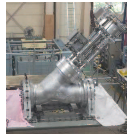
図5-2-4 主蒸気隔離弁の試験体
