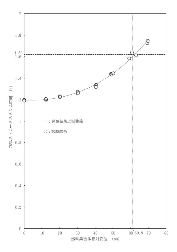
図 4-3 燃料集合体相対変位のスクラム時間に及ぼす影響 (ボロンカーバイド型制御棒)
