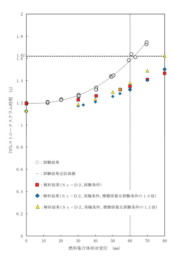
図 5-1 燃料集合体相対変位のスクラム時間に及ぼす影響 (制御棒挿入性解析よる解析結果)
