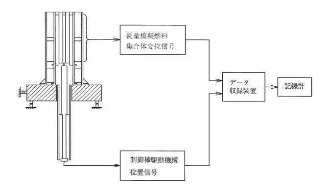
図 4-2 計測装置の概要
