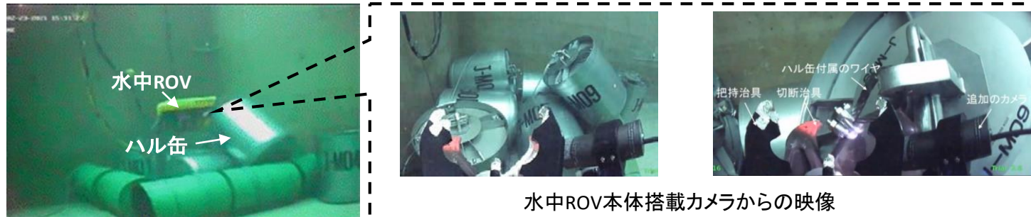
ハル缶ランダム配置を模擬した水中ROVによるワイヤの切断試験状況
