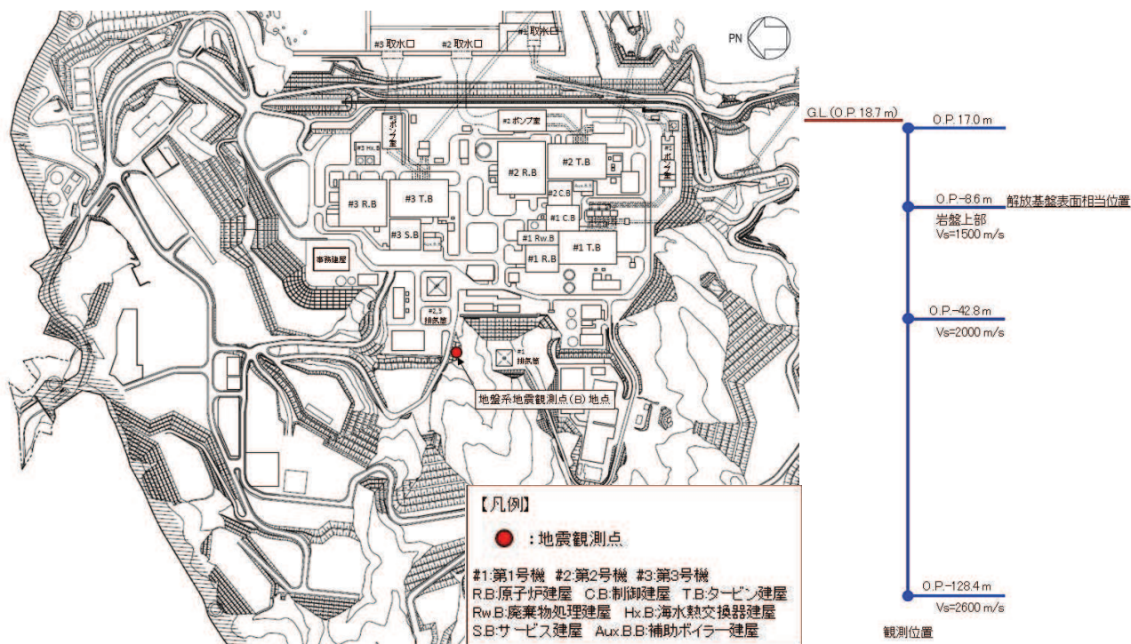
図 4-5 女川原子力発電所における地震観測点の位置
