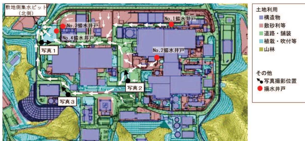
図9 南側幹線排水路及び支線排水路機能喪失時の各揚水井戸からの排水経路の例
