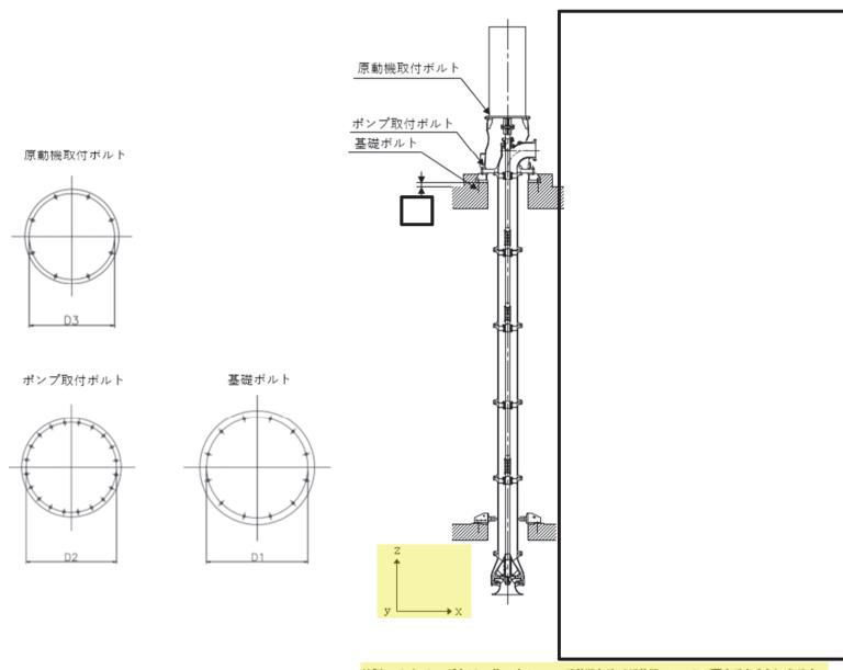
注記:ペデスタル系とは、ポンプベース、原動機台及び原動機フレーム(固定子を含む)を示す。
