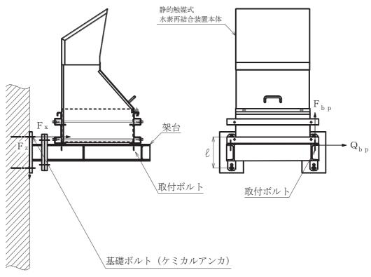
静的触媒式水素再結合装置 (その2)
