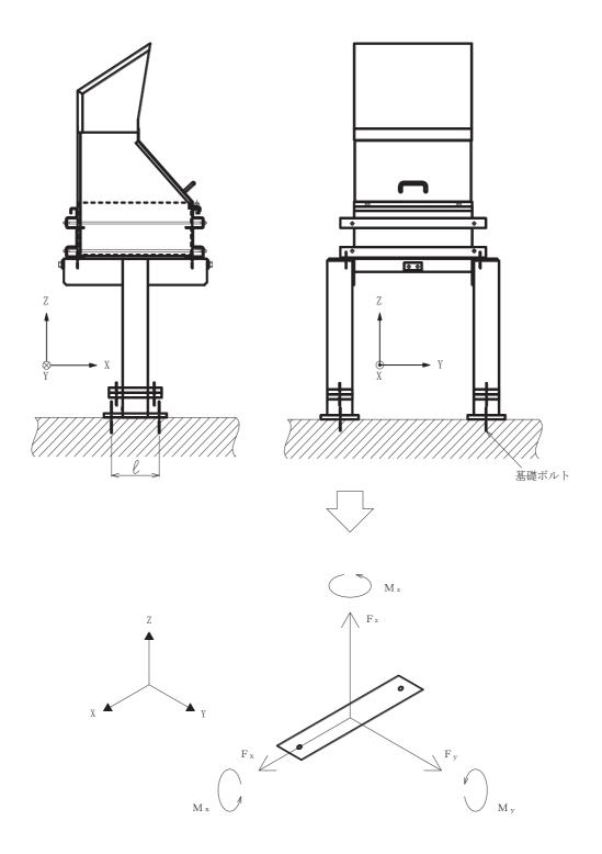
図 4-7 計算モデル (架台基礎ボルト部 (その1))
