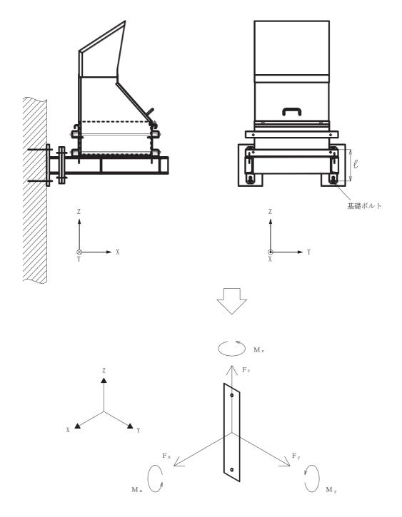
図 4-8 計算モデル (架台基礎ボルト部 (その 2))
