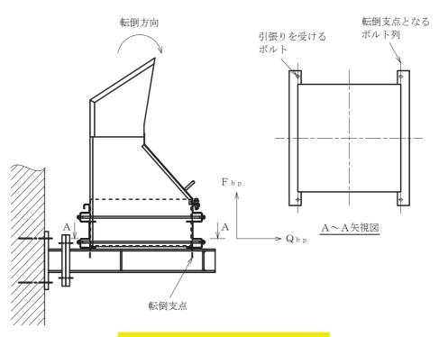
図 4-6 計算モデル (短辺方向転倒)
