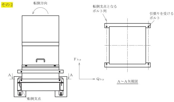
図 4-5 計算モデル(長辺方向転倒)
