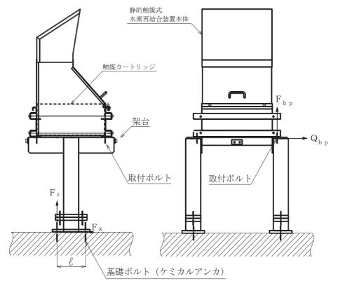
静的触媒式水素再結合装置(その1)
