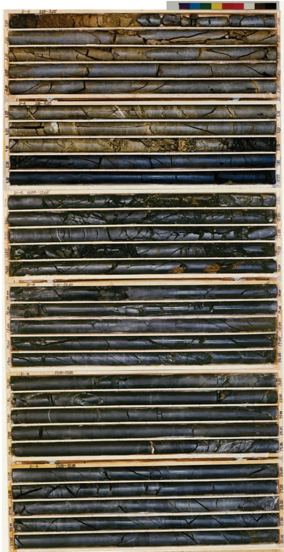
図 2-17(2) ボーリングコア写真 (D-4) (深度 0~30m)
