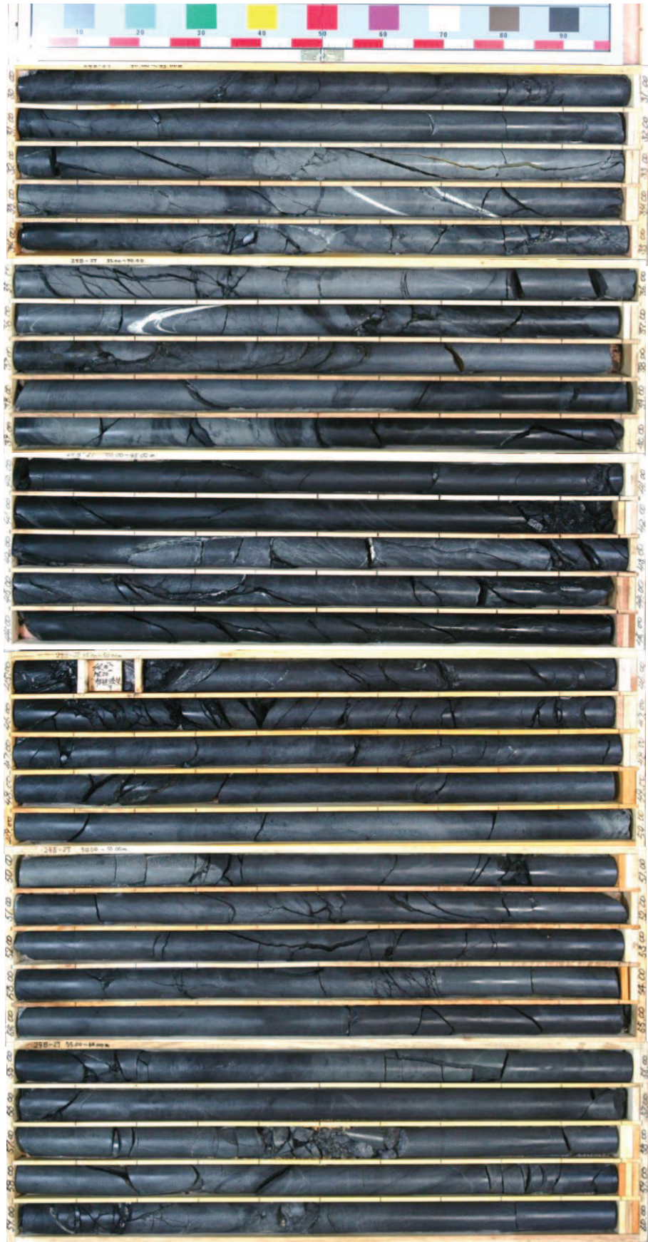
図 2-3(4) ボーリングコア写真 (24B-27) (深度 30~60m)
