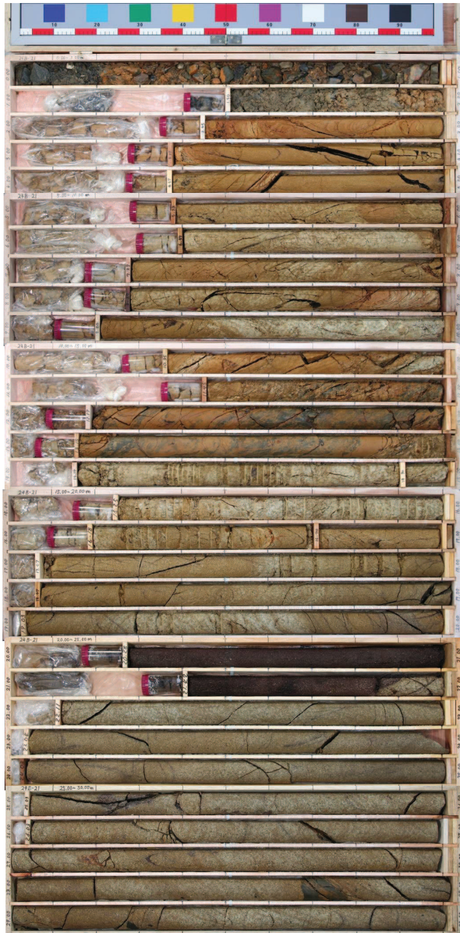
図 2-4(2) ボーリングコア写真 (24B-21) (深度 0~30m)
