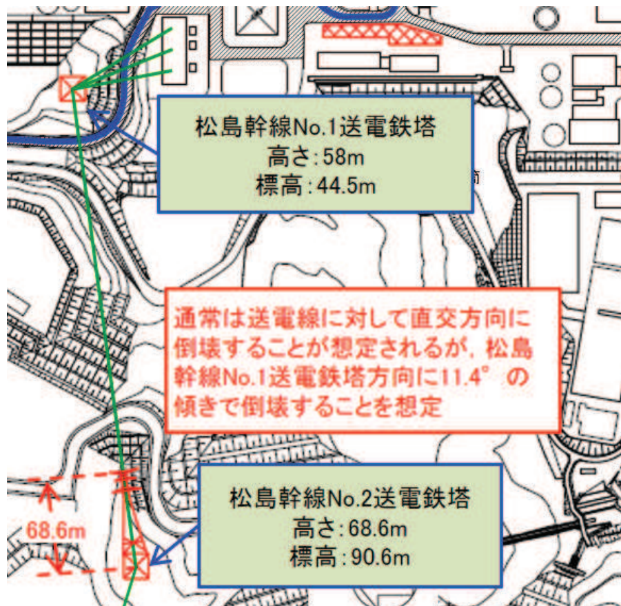
図 6. 2. 2-42 松島幹線 No. 2 送電鉄塔倒壊時の倒壊想定
