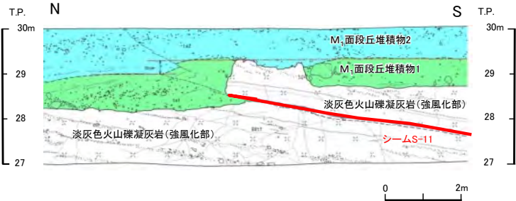
Ts-7トレンチ東側法面: 変状が認められる (見掛けの鉛直変位量約30cm[段丘堆積物中の層理面の段差]) (P.4-20参照)
