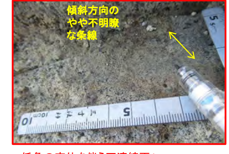
低角の変位を伴う不連続面i • 強風化部 • 走向・傾斜:N44° W, 18° E • 傾斜方向のやや不明瞭な条線有り(プランジ角17° N)
