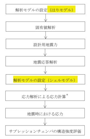
注記\*:スロッシング荷重を考慮 図 2-1 サプレッションチェンバの耐震評価フロー
