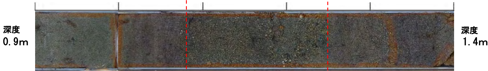
ボーリングコア写真
