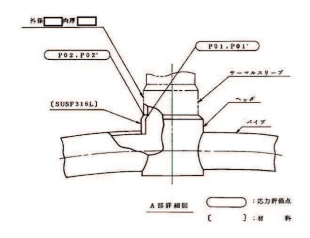
図 1-1(2) 形状・寸法・材料・応力評価点(高圧炉心スプレイ系配管) (単位:mm)
