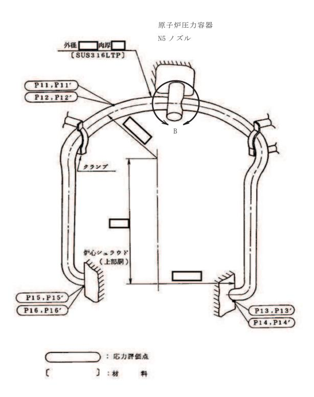
図 1-1(3) 形状・寸法・材料・応力評価点(低圧炉心スプレイ系配管) (単位:mm)
