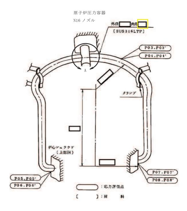
図 1-1(1) 形状・寸法・材料・応力評価点(高圧炉心スプレイ系配管) (単位:mm)
