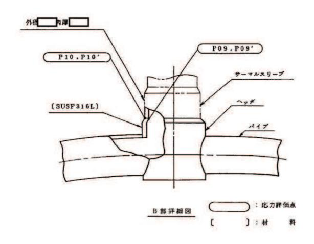
図 1-1(4) 形状・寸法・材料・応力評価点(低圧炉心スプレイ系配管) (単位:mm)
