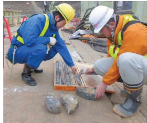
(岩ズリの外観目視・ハンマー打音から風化度を判定。併せて、近傍のボーリングコアと岩相等を対比している。)
