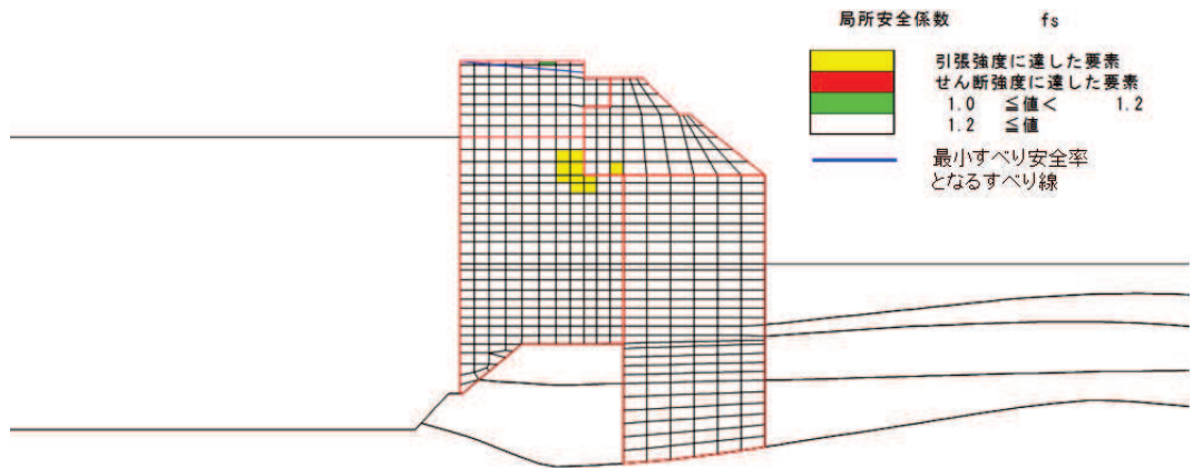
図 5-45 背面補強工の最小すべり安全率時刻における局所安全係数分布 (断面③, S d - D 2 ( - + ), t=13.58s)
