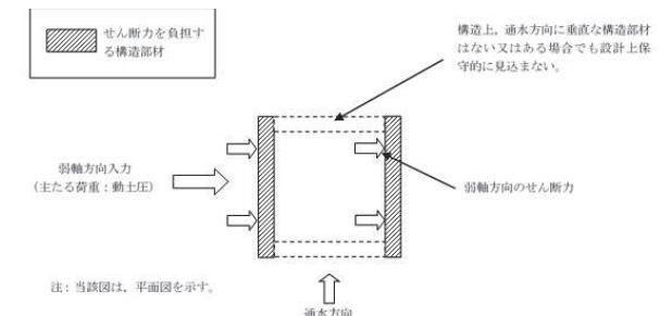
図4-4 従来設計手法の考え方
