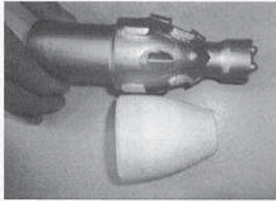
拡幅削孔用親子ビット
