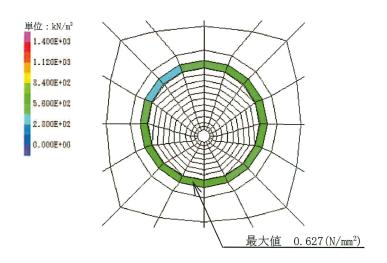
図 3-6 覆工部の引張<mark>破壊</mark>に対する照査値最大となる時刻の応力分布図 (Ss-F3 (-+), t=27.64s) (解析ケース①:基本ケース)
