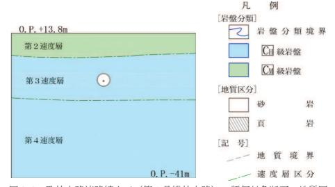
図 3-2 取放水路流路縮小工(第1号機放水路)の評価対象断面の地質図
