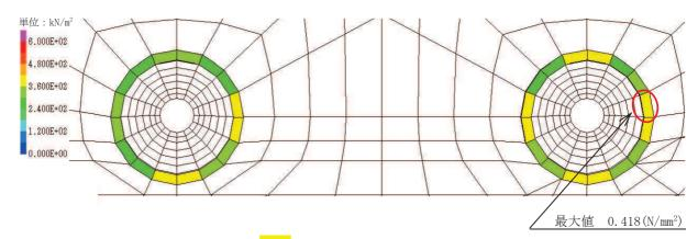
図 3-8 覆工部のせん断<mark>破壊</mark>に対する照査値最大となる時刻の応力分布図 (Ss-F3(-+), t=27.64s)
