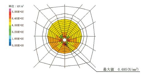
図 3-9 充填部のせん断<mark>破壊</mark>に対する照査値最大となる時刻の応力分布図 (Ss-F3 (++), t=27.64s) (解析ケース①:基本ケース)
