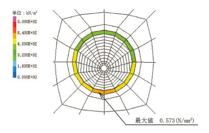
図 3-8 覆工部のせん断<mark>破壊</mark>に対する照査値最大となる時刻の応力分布図 (Ss-F3(++), t=27.64s) (解析ケース①:基本ケース)
