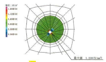
図 3-7 充填部の引張<mark>破壊</mark>に対する照査値最大となる時刻の応力分布図 (Ss-F3(-+), t=27.64s) (解析ケース①:基本ケース)
