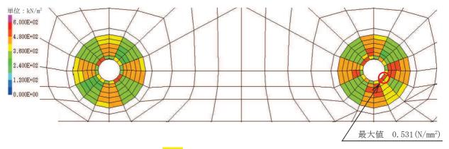
図 3-9 充填部のせん断<mark>破壊</mark>に対する照査値最大となる時刻の応力分布図 (Ss-F3 (-+), t=27.64s)
