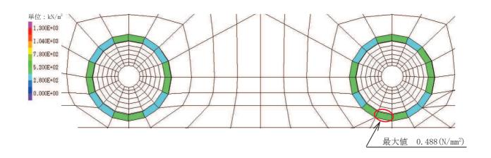
図 3-6 覆工部の引張<mark>破壊</mark>に対する照査値最大となる時刻の応力分布図 (Ss-F3 (-+), t=27.64s)
