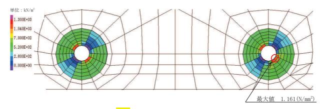
図 3-7 充填部の引張<mark>破壊</mark>に対する照査値最大となる時刻の応力分布図 (Ss-F3 (-+), t=27.64s)
