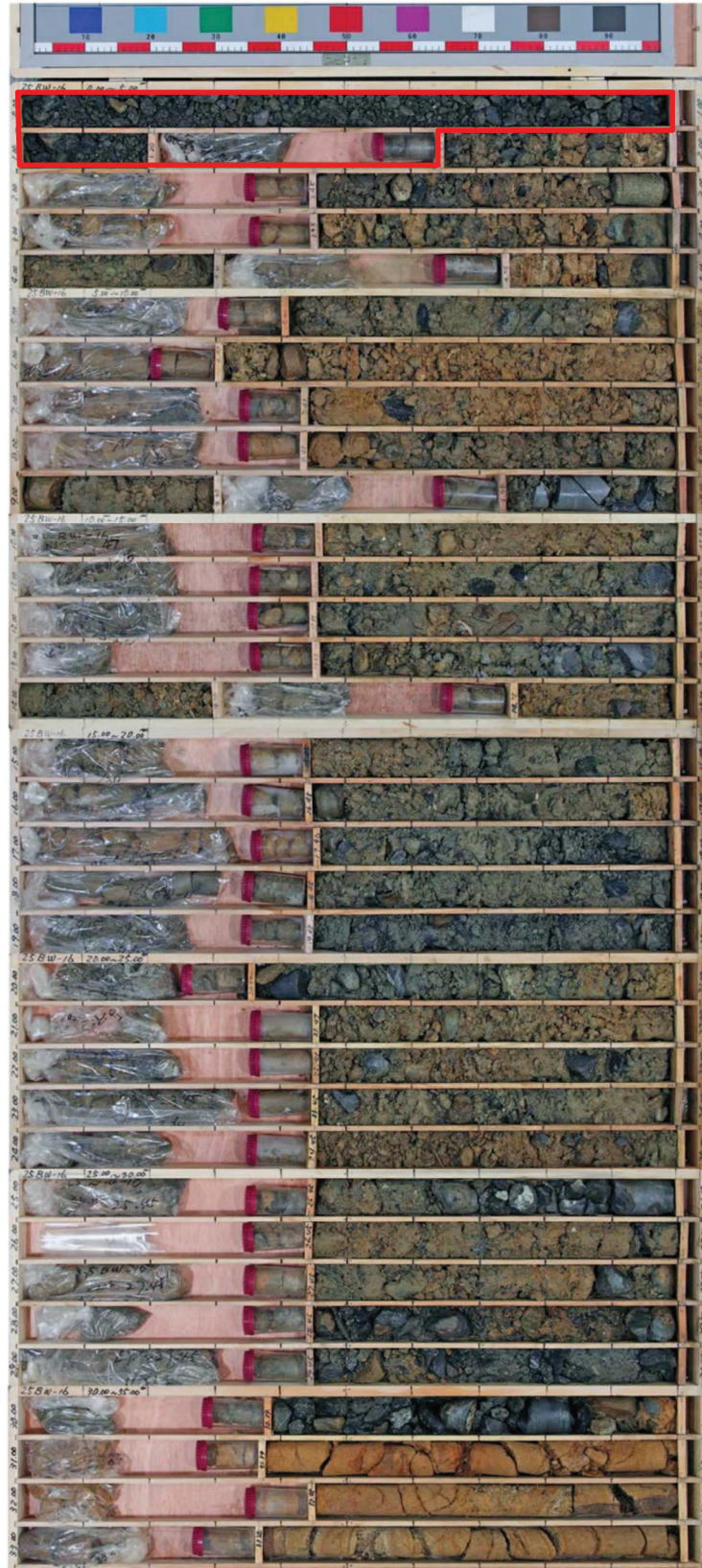
図 1-19(2) ボーリングコア写真 (25BW-16) (盛土：深度 0～31.05m)
