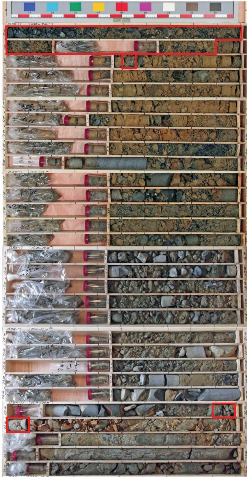
図 1-20(2) ボーリングコア写真 (25BW-17) (盛土：深度 0～26.08m)
