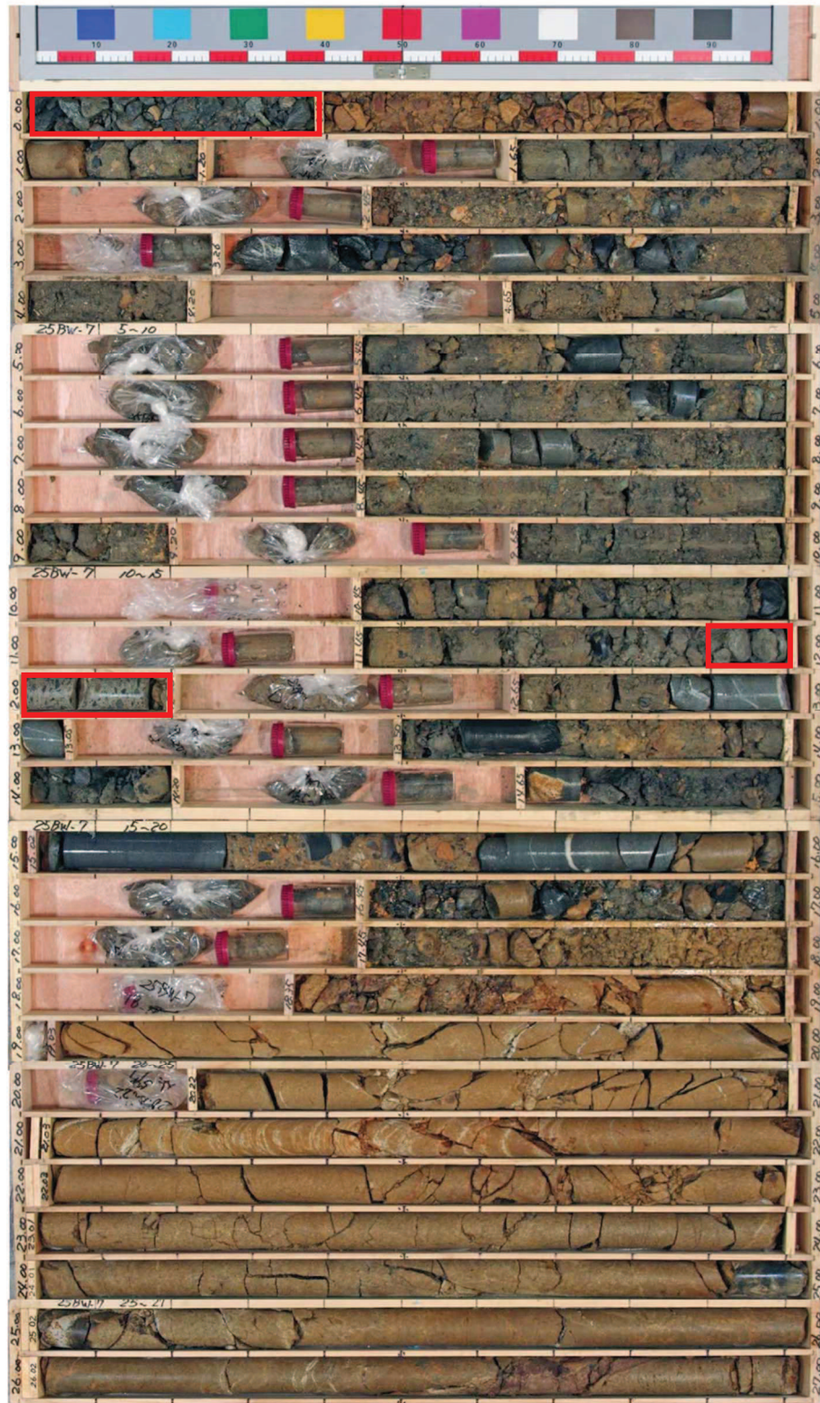
図 1-10(2) ボーリングコア写真 (25BW-7) (盛土：深度 0～17.83m)
