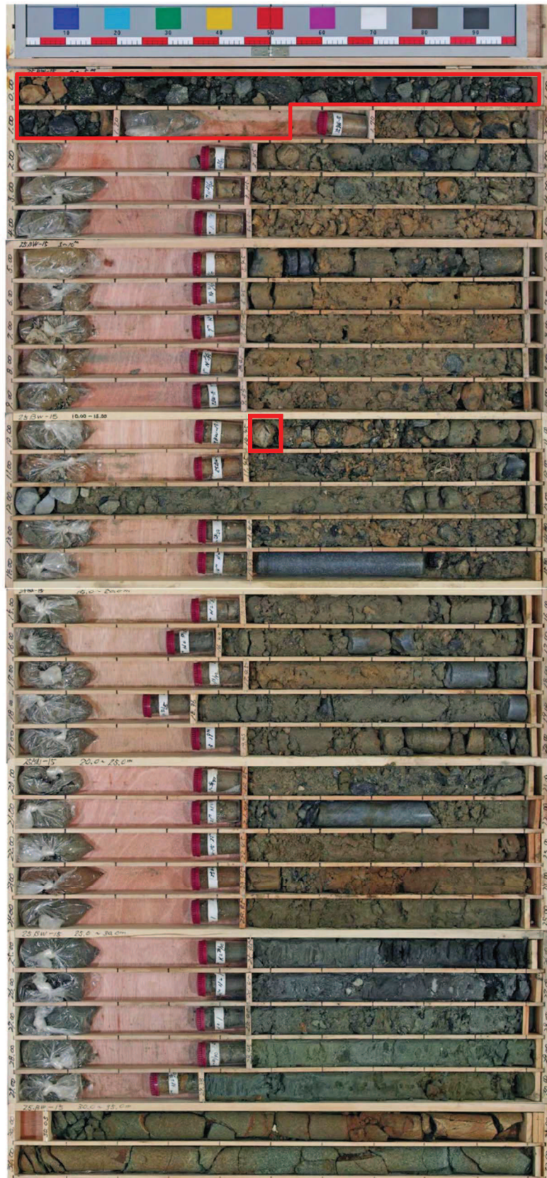
図 1-18(2) ボーリングコア写真 (25BW-15) (盛土：深度 0～30.00m)
