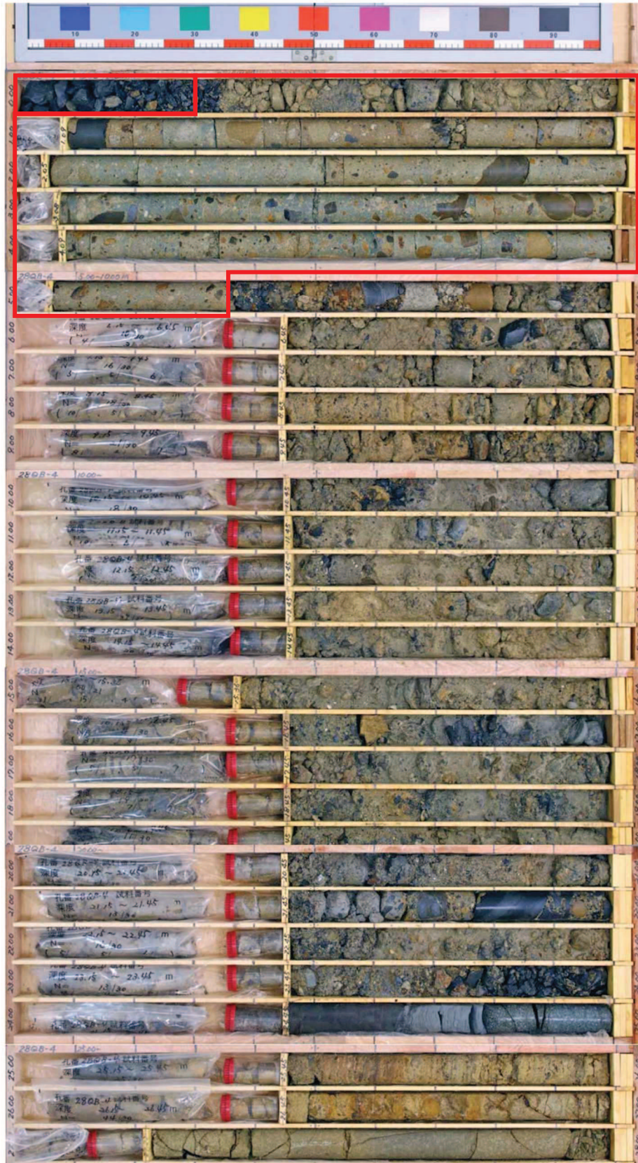
図 1-32(2) ボーリングコア写真 (28QB-4) (盛土: 深度 0~24.40m, 旧表土: 深度 24.40~26.80m)
