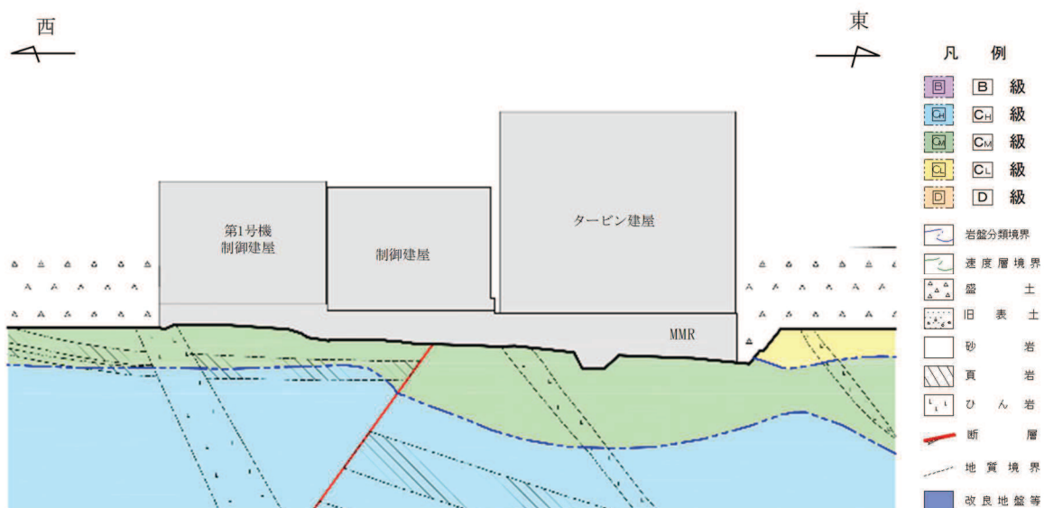
図 3.1-5 制御建屋の地質断面図 (③-③断面)
