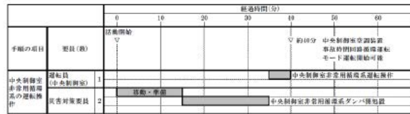
第1.16.2図 中央制御室非常用循環系の運転操作 タイムチャート
