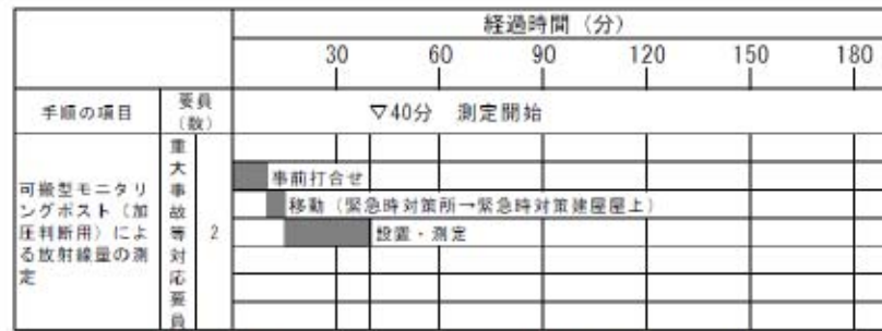
第1.17-5図 可搬型モニタリングポスト（加圧判断用）による放射線量の測定タイムチャート
