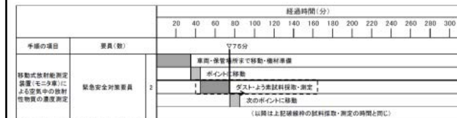
第1.17.7図 移動式放射能測定装置(モニタ車)による空気中の放射性物質の濃度測定タイムチャート
