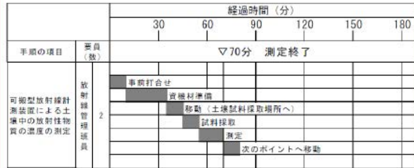
第1.17-11図 可搬型放射線計測装置による土壌中の放射性物質の濃度の測定のタイムチャート
