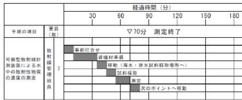
第1.17-10図 可搬型放射線計測装置による水中の放射性物質の濃度の測定のタイムチャート
