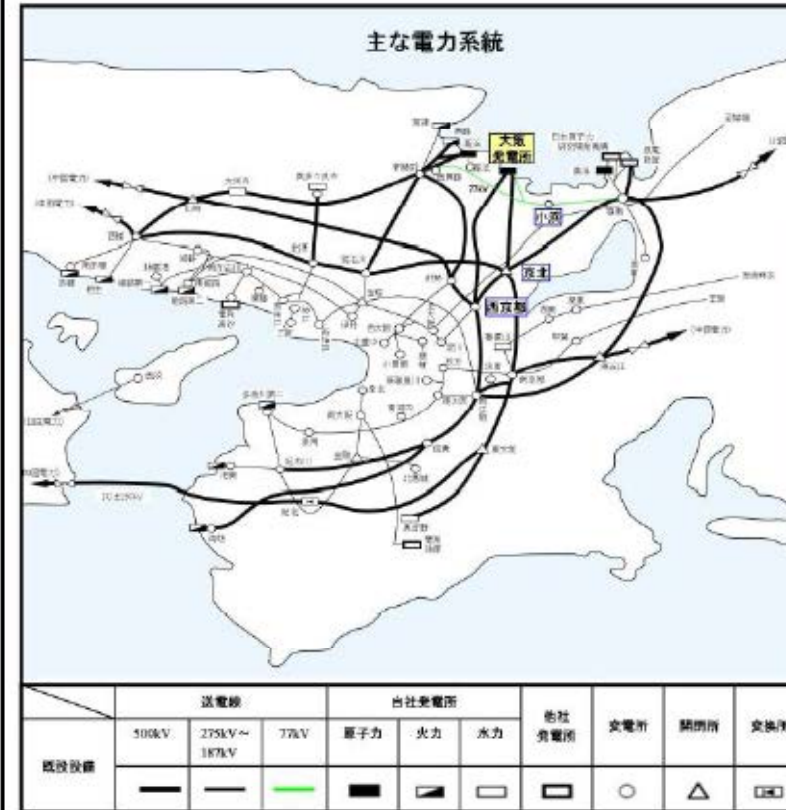
第10.3.1図 送電系統図（平成27年2月時点系統図）
