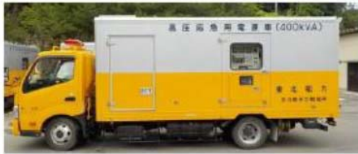
図4-4 電源車（緊急時対策所用） 外観
