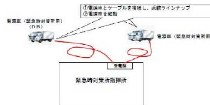
図4-3 緊急時対策所電源設備立上げ
