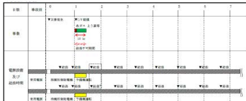
※：待機所側発電機は直ぐに給電が必要な状態ではないが、ブルーム通過後の給油回数削減のため、前機所側発電機と同時に給電する。発電機2台への給油時間の合計は、約12分と想定している。
