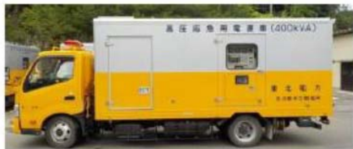
図4-4 電源車（緊急時対策所用） 外観
