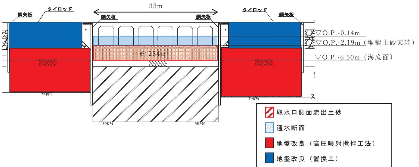
添付 6-10 図 取水口側面土砂堆積図
