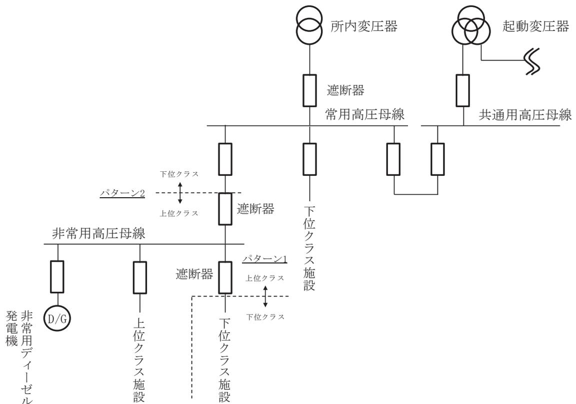
第 5.2-1 図 受電系統概念図（パターン 1, 2）
