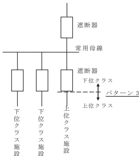
第 5.2-2 図 受電系統概念図 (パターン 3)
