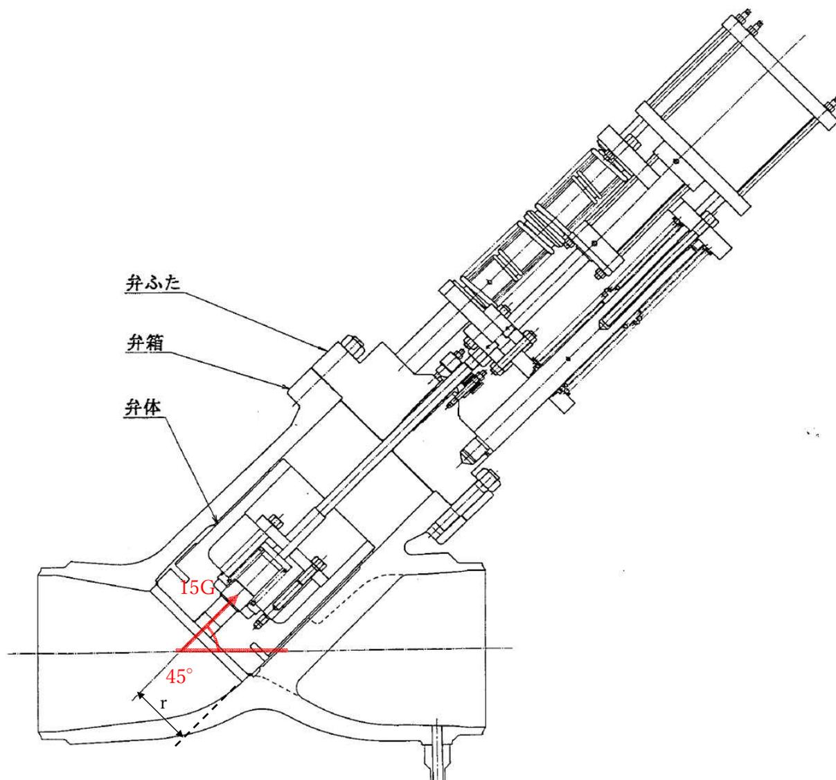
添付 8-7 図 主蒸気系境界弁構造図
