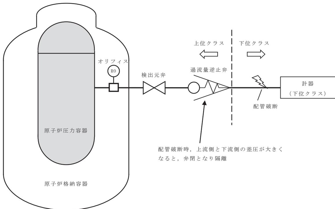
第 5.2-5 図 原子炉压力容器からの計装ライン構成概念図
