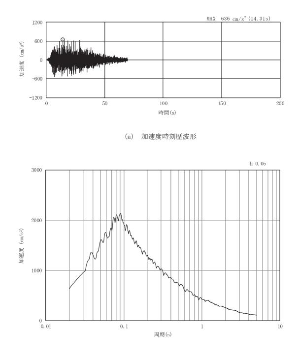
図3-16 土砂部(断面①)の入力地震動の加速度時刻歴波形及び加速度応答スペクトル(5/28) (水平成分: Ss-D3)
