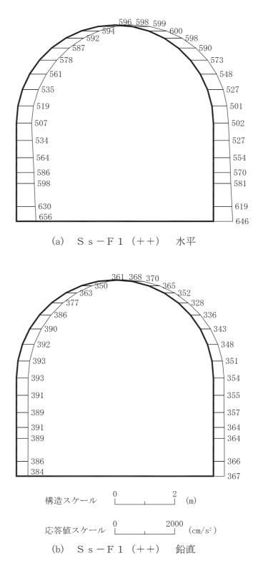
図 4-211 最大加速度分布図 (解析ケース④) (49/56)
