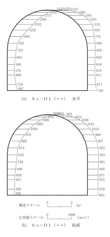
図 4-191 最大加速度分布図(解析ケース③)(29/56)
