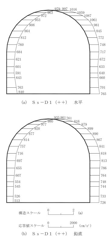
図 4-21 最大加速度分布図(解析ケース②)(1/42)
