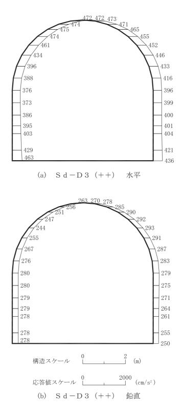
図 4-265 最大加速度分布図 (解析ケース④) (47/56)
