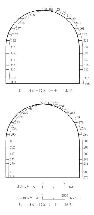
図 4-152 最大加速度分布図(解析ケース⑧)(4/14)
