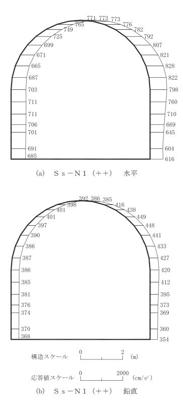
図 4-20 最大加速度分布図 (解析ケース④: せん断破壊に対する最大照査値ケース)(20/20)
