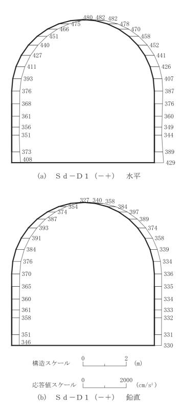
図 4-248 最大加速度分布図(解析ケース③)(30/56)
