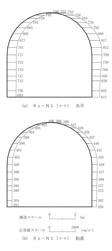
図 4-16 最大加速度分布図 (解析ケース②: せん断破壊に対する最大照査値ケース)(16/20)
