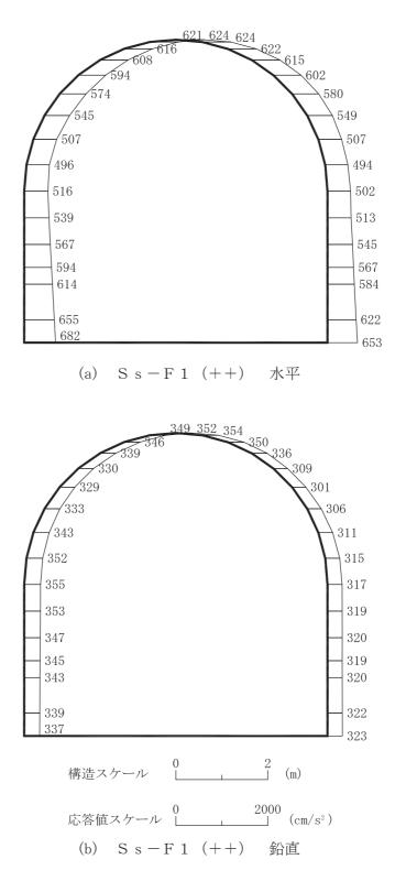
図 4-41 最大加速度分布図(解析ケース③)(21/42)
