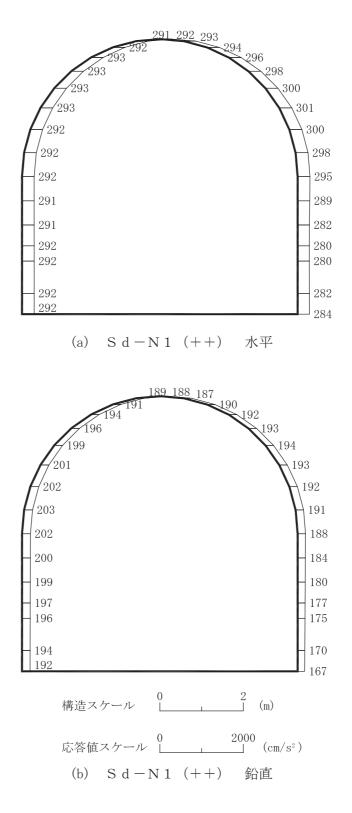
図 4-259 最大加速度分布図(解析ケース③)(41/56)
