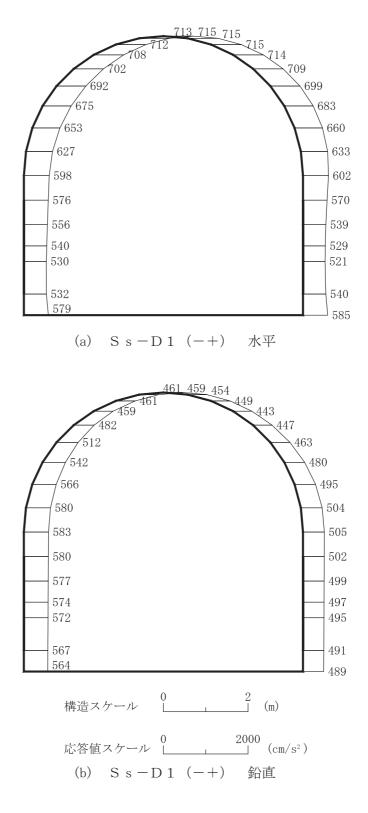
図 4-136 最大加速度分布図(解析ケース⑧)(2/14)
