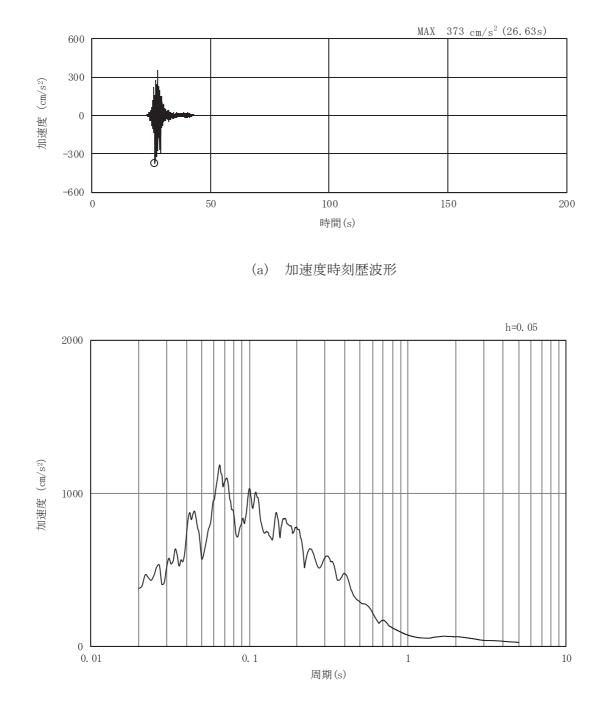
図3-92 岩盤部(断面⑤)の入力地震動の加速度時刻歴波形及び加速度応答スペクトル(25/28) (水平成分:Sd-F3)
