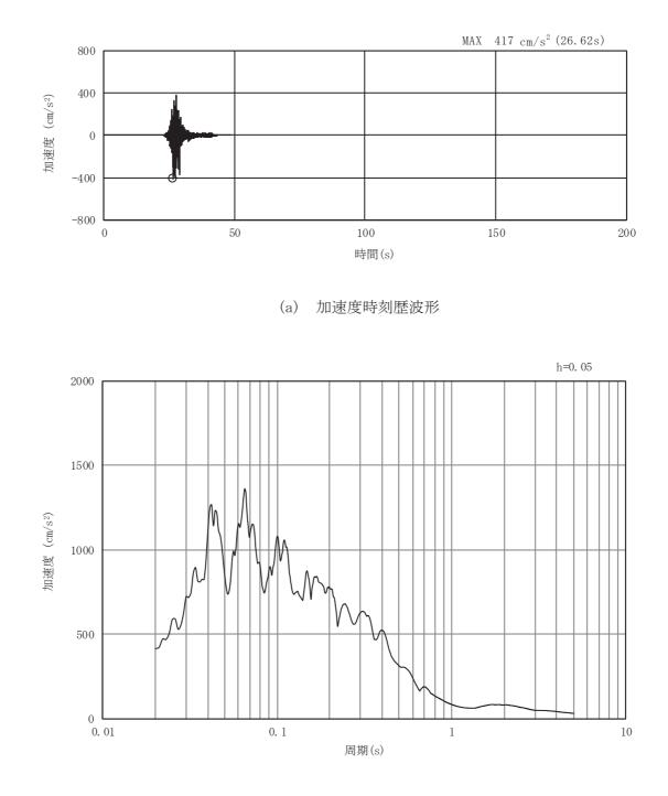
図3-51 土砂部(断面③)の入力地震動の加速度時刻歴波形及び加速度応答スペクトル(12/28) (鉛直成分:Ss-F3)
