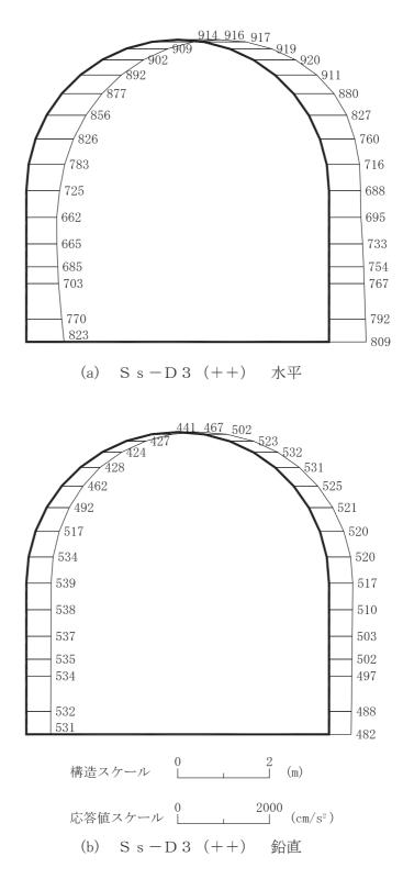
図 4-53 最大加速度分布図 (解析ケース④) (33/42)
