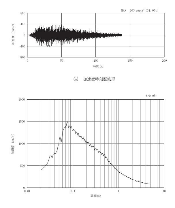
図3-69 岩盤部(断面⑤)の入力地震動の加速度時刻歴波形及び加速度応答スペクトル(2/28) (鉛直成分:Ss-D1)
