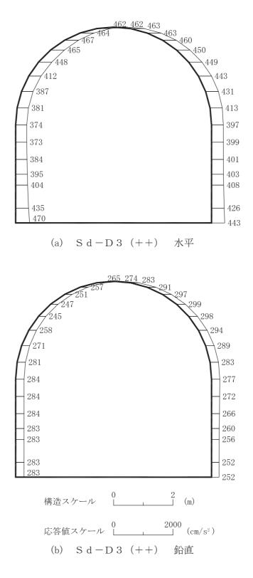
図 4-251 最大加速度分布図(解析ケース③)(33/56)
