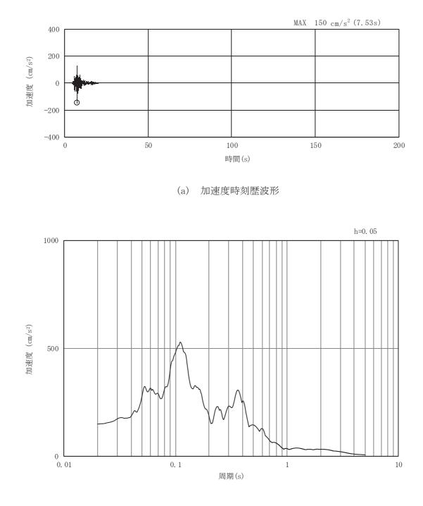
図3-95 岩盤部(断面⑤)の入力地震動の加速度時刻歴波形及び加速度応答スペクトル(28/28) (鉛直成分:Sd-N1)
