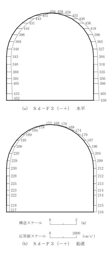
図 4-116 最大加速度分布図(解析ケース④)(54/56)
