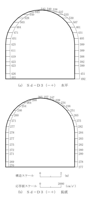
図 4-110 最大加速度分布図(解析ケース④)(48/56)
