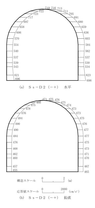
図 4-138 最大加速度分布図(解析ケース⑧)(4/14)
