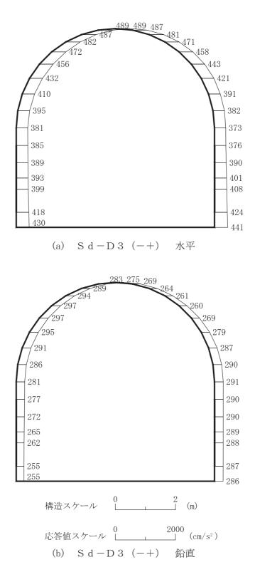
図 4-238 最大加速度分布図(解析ケース②)(20/56)
