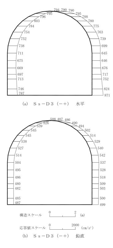
図 4-168 最大加速度分布図 (解析ケース①) (6/56)
