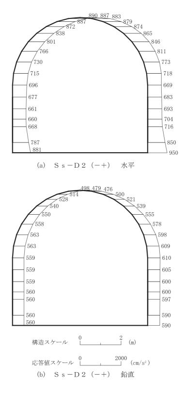
図 4-180 最大加速度分布図 (解析ケース②) (18/56)
