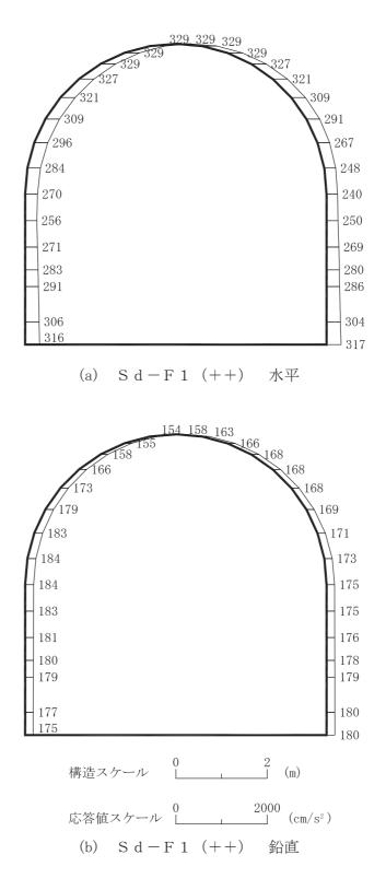
図 4-253 最大加速度分布図(解析ケース③)(35/56)
