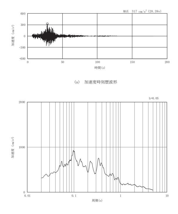
図3-34 土砂部(断面①)の入力地震動の加速度時刻歴波形及び加速度応答スペクトル(23/28) (水平成分: Sd-F2)
