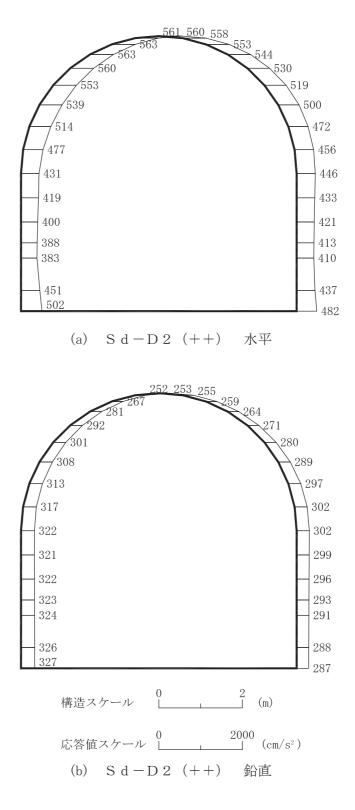
図 4-65 最大加速度分布図 (解析ケース①) (3/56)
