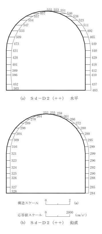
図 4-93 最大加速度分布図(解析ケース③)(31/56)
