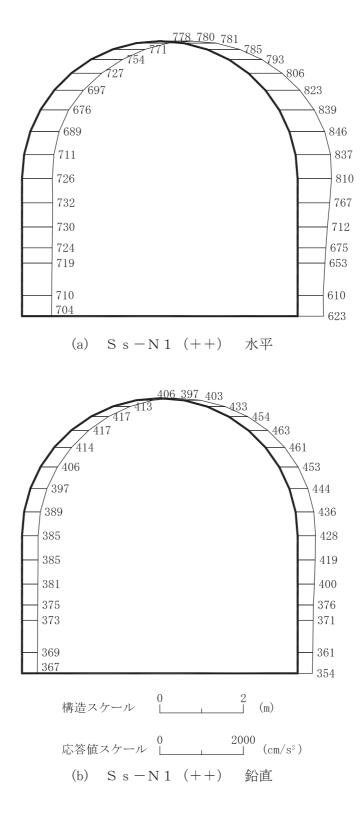
図 4-18 最大加速度分布図 (解析ケース③: せん断破壊に対する最大照査値ケース)(18/20)
