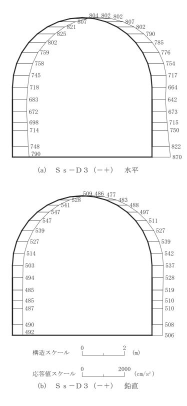
図 4-196 最大加速度分布図 (解析ケース③) (34/56)
