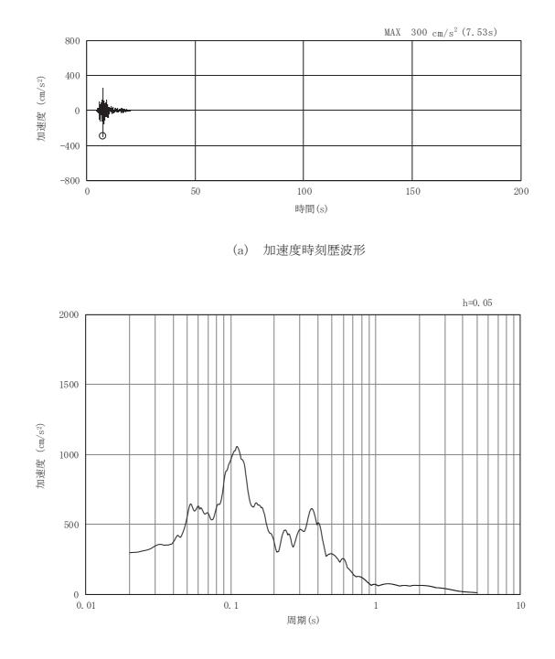
図3-81 岩盤部(断面⑤)の入力地震動の加速度時刻歴波形及び加速度応答スペクトル(14/28) (鉛直成分:Ss-N1)
