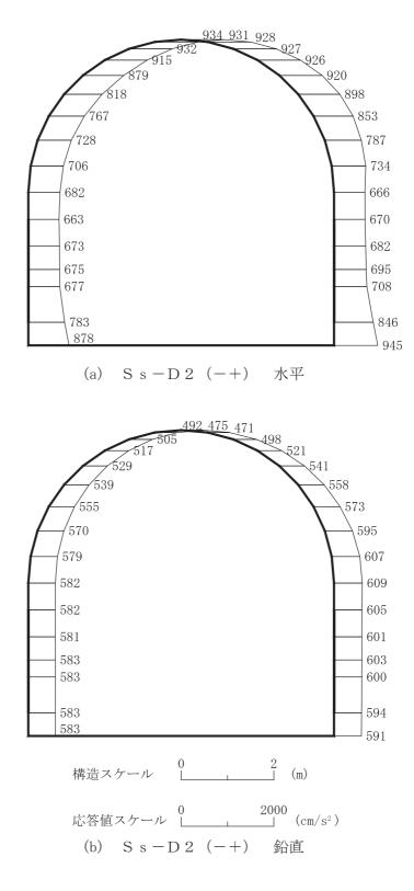
図 4-208 最大加速度分布図 (解析ケース④) (46/56)
