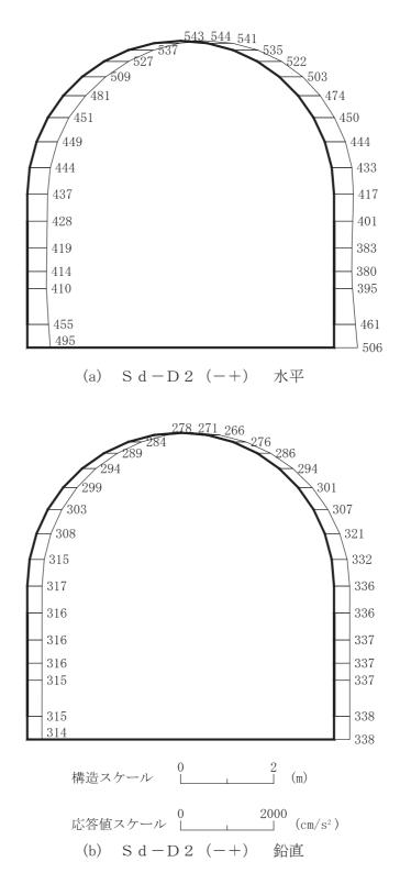
図 4-264 最大加速度分布図 (解析ケース④) (46/56)
