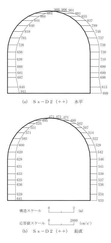
図 4-165 最大加速度分布図 (解析ケース①) (3/56)
