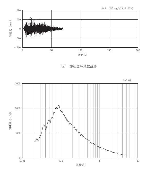
図3-72 岩盤部(断面⑤)の入力地震動の加速度時刻歴波形及び加速度応答スペクトル(5/28) (水平成分: Ss-D3)
