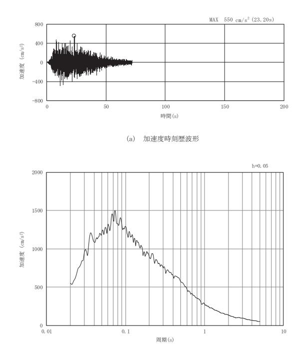
図3-43 土砂部(断面③)の入力地震動の加速度時刻歴波形及び加速度応答スペクトル(4/28) (鉛直成分: Ss-D2)
