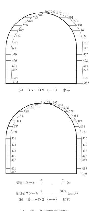
図 4-134 最大加速度分布図 (解析ケース⑧:曲げ・軸力系の破壊及びせん断破壊に対する最大照査値ケース)(16/16)
