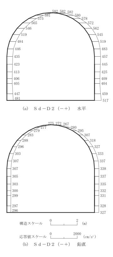
図 4-108 最大加速度分布図(解析ケース④)(46/56)
