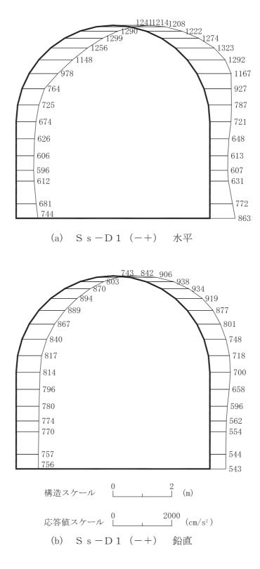
図 4-2 最大加速度分布図(解析ケース①)(2/20)
