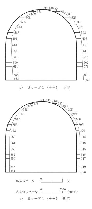
図 4-27 最大加速度分布図 (解析ケース②) (7/42)
