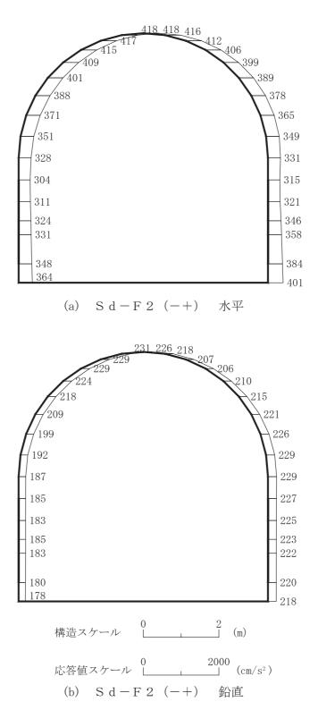
図 4-86 最大加速度分布図(解析ケース②)(24/56)
