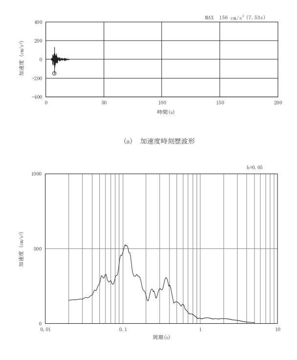
図3-39 土砂部(断面①)の入力地震動の加速度時刻歴波形及び加速度応答スペクトル(28/28) (鉛直成分: Sd-N1)
