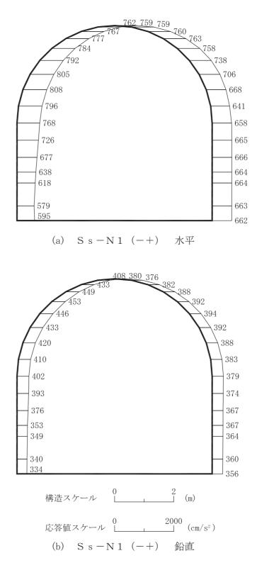
図 4-14 最大加速度分布図 (解析ケース①) (14/20)
