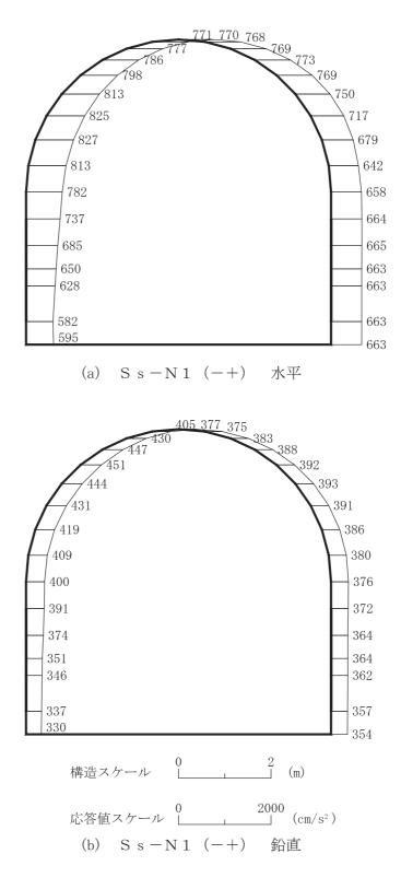
図 4-48 最大加速度分布図 (解析ケース③) (28/42)
