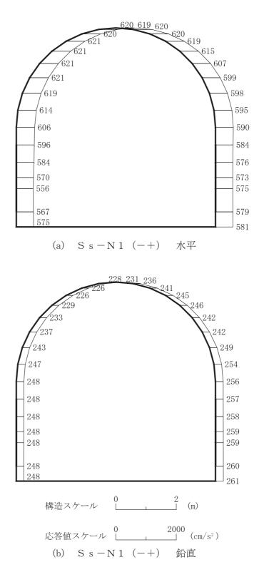
図 4-132 最大加速度分布図(解析ケース⑥)(14/16)
