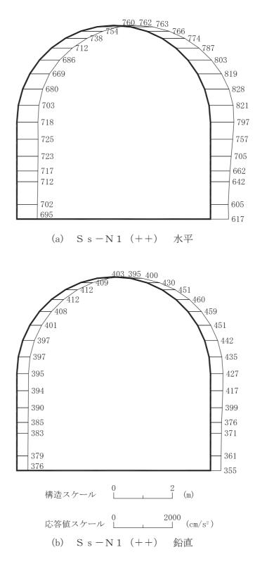
図 4-13 最大加速度分布図 (解析ケース①) (13/20)
