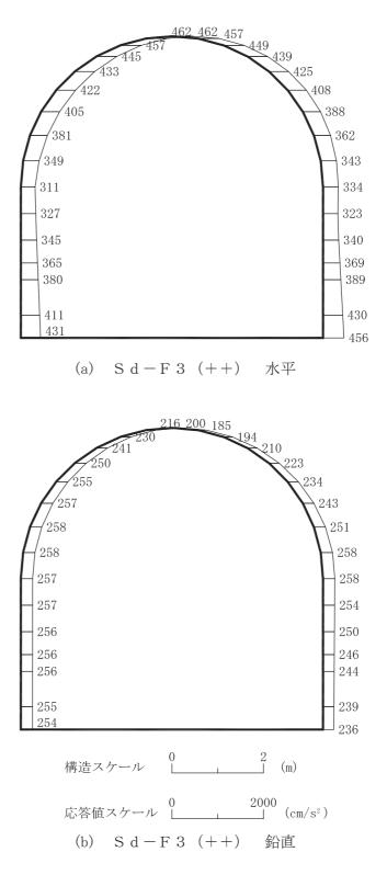
図 4-101 最大加速度分布図(解析ケース③)(39/56)
