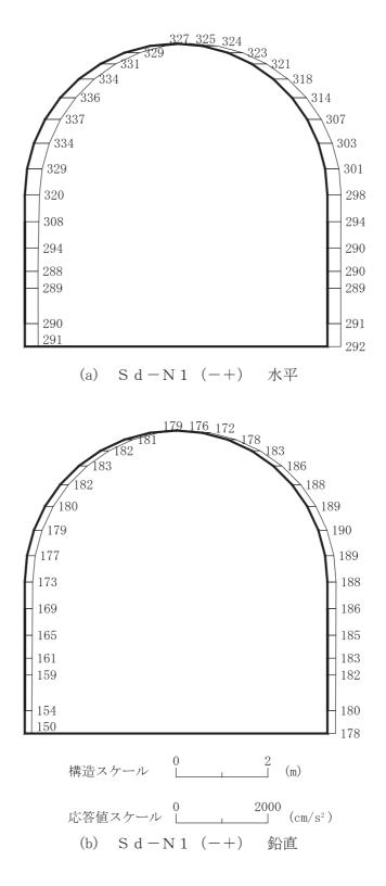
図 4-104 最大加速度分布図(解析ケース③)(42/56)
