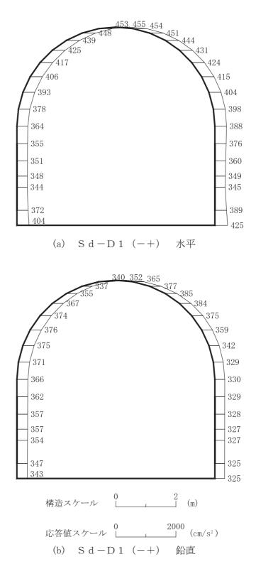
図 4-234 最大加速度分布図(解析ケース②)(16/56)
