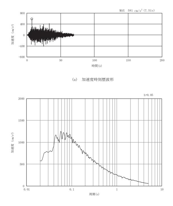
図3-45 土砂部(断面③)の入力地震動の加速度時刻歴波形及び加速度応答スペクトル(6/28) (鉛直成分: Ss-D3)
