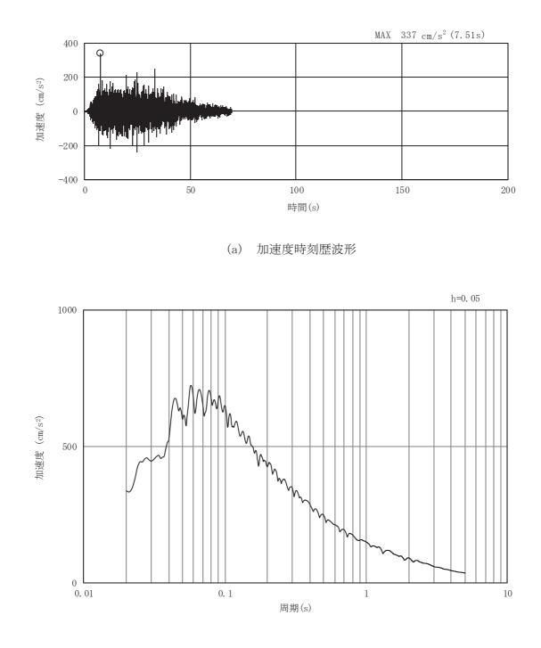
図3-31 土砂部(断面①)の入力地震動の加速度時刻歴波形及び加速度応答スペクトル(20/28) (鉛直成分: Sd-D3)
