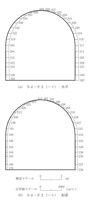
図 4-228 最大加速度分布図(解析ケース①)(10/56)
