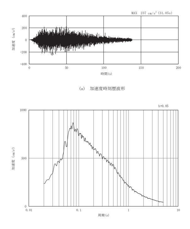
図3-27 土砂部(断面①)の入力地震動の加速度時刻歴波形及び加速度応答スペクトル(16/28) (鉛直成分: Sd-D1)
