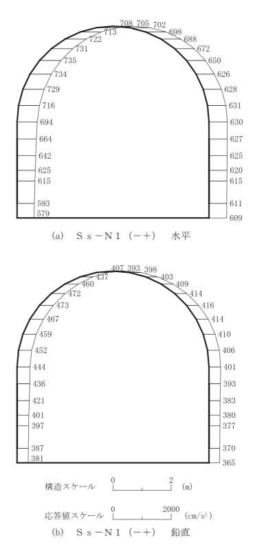
図 4-204 最大加速度分布図 (解析ケース③) (42/56)
