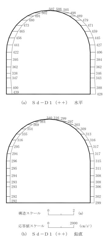
図 4-91 最大加速度分布図 (解析ケース③) (29/56)
