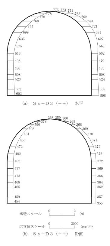
図 4-123 最大加速度分布図(解析ケース⑥)(5/16)
