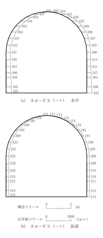
図 4-74 最大加速度分布図 (解析ケース①) (12/56)
