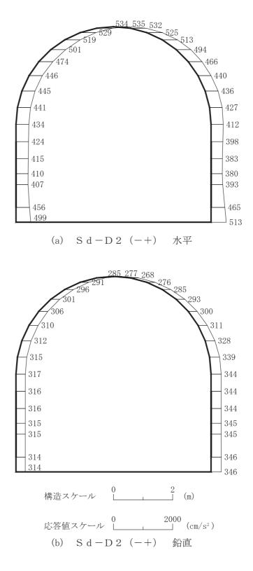
図 4-222 最大加速度分布図(解析ケース①)(4/56)
