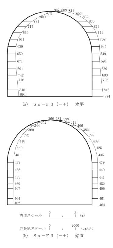
図 4-46 最大加速度分布図 (解析ケース③) (26/42)
