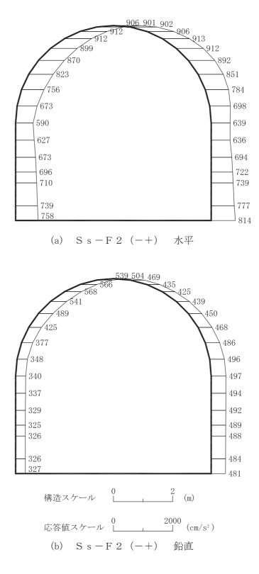
図 4-172 最大加速度分布図(解析ケース①)(10/56)
