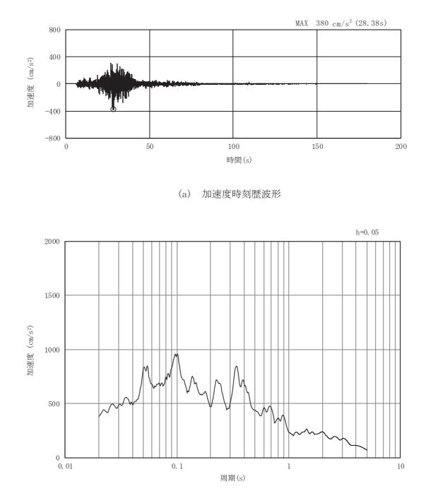
図3-49 土砂部(断面③)の入力地震動の加速度時刻歴波形及び加速度応答スペクトル(10/28) (鉛直成分:Ss-F2)
