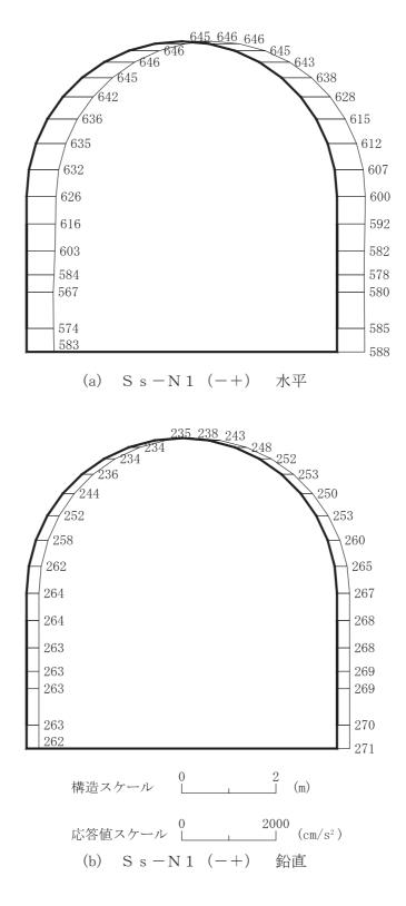
図4-148 最大加速度分布図(解析ケース⑧)(14/14)
