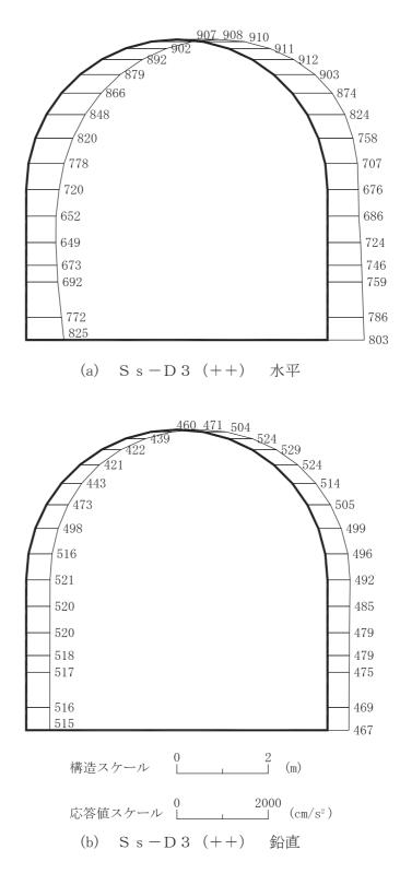
図 4-39 最大加速度分布図 (解析ケース③) (19/42)
