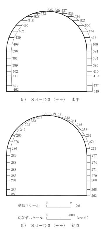
図 4-67 最大加速度分布図 (解析ケース①) (5/56)
