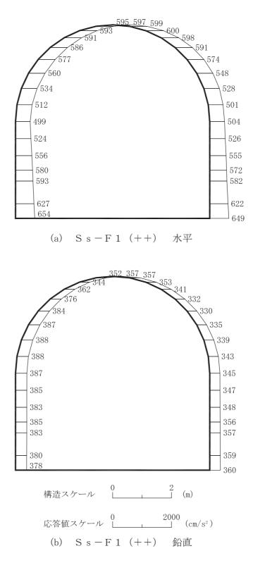
図 4-169 最大加速度分布図 (解析ケース①) (7/56)
