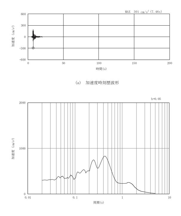
図3-66 土砂部(断面③)の入力地震動の加速度時刻歴波形及び加速度応答スペクトル(27/28) (水平成分: Sd-N1)
