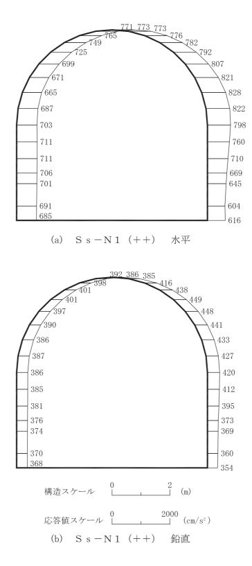
図 4-61 最大加速度分布図 (解析ケース④) (41/42)
