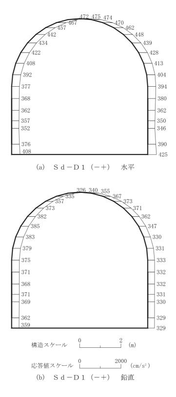
図 4-262 最大加速度分布図 (解析ケース④) (44/56)
