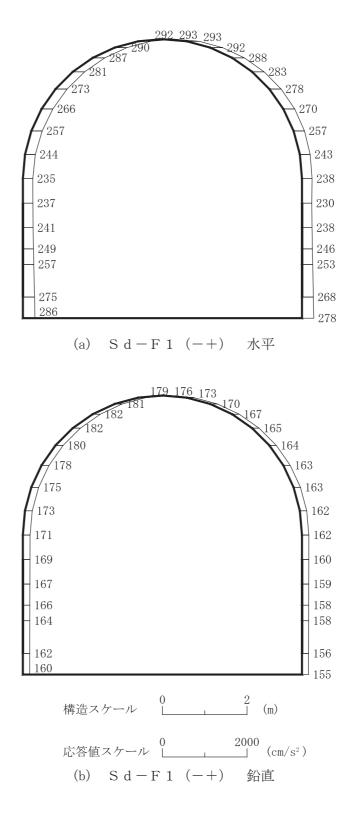
図 4-156 最大加速度分布図 (解析ケース⑧) (8/14)
