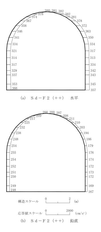
図 4-255 最大加速度分布図(解析ケース③)(37/56)
