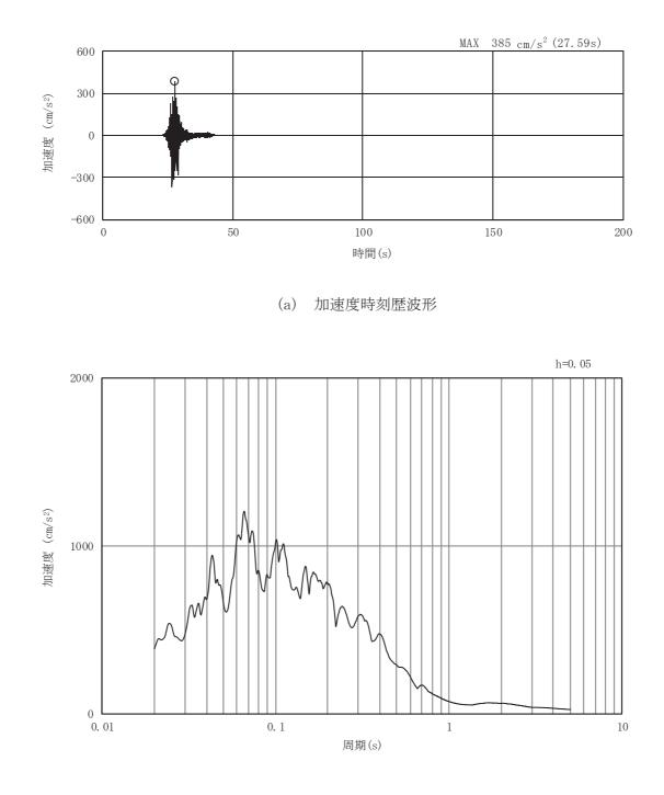
図3-64 土砂部(断面③)の入力地震動の加速度時刻歴波形及び加速度応答スペクトル(25/28) (水平成分: Sd-F3)
