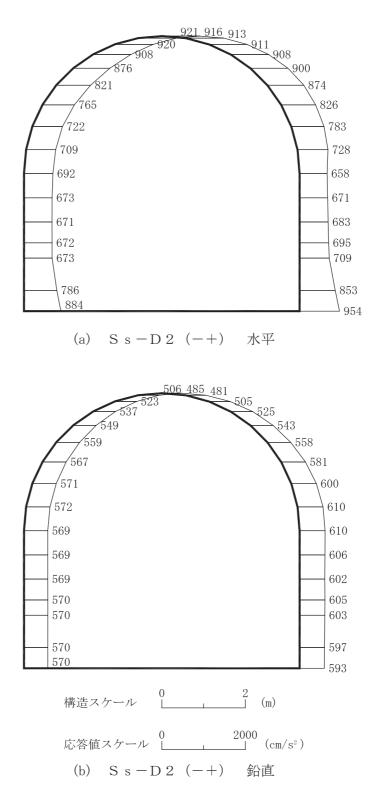
図 4-166 最大加速度分布図 (解析ケース①) (4/56)
