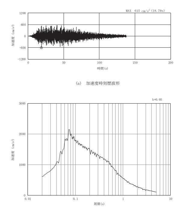
図3-40 土砂部(断面③)の入力地震動の加速度時刻歴波形及び加速度応答スペクトル(1/28) (水平成分: Ss-D1)
