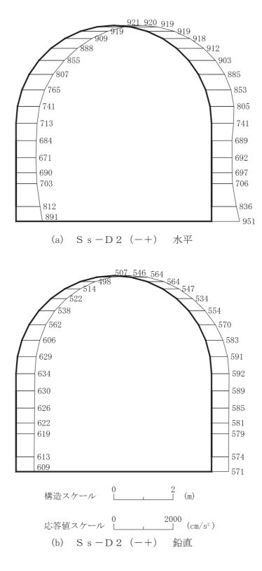
図 4-24 最大加速度分布図 (解析ケース②) (4/42)
