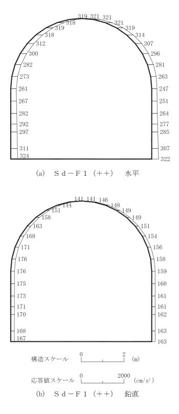
図 4-97 最大加速度分布図(解析ケース③)(35/56)
