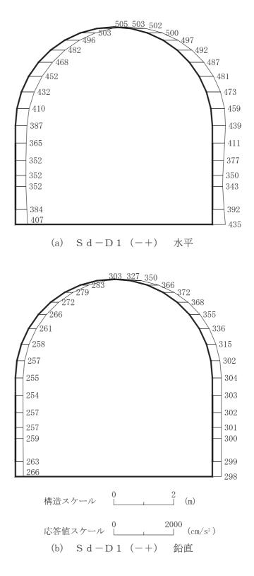
図 4-106 最大加速度分布図(解析ケース④)(44/56)
