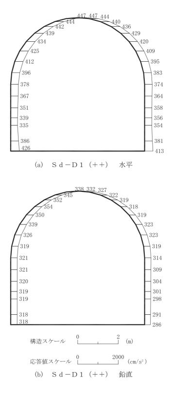
図 4-219 最大加速度分布図(解析ケース①)(1/56)
