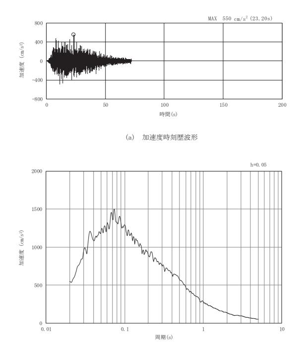
図3-15 土砂部(断面①)の入力地震動の加速度時刻歴波形及び加速度応答スペクトル(4/28) (鉛直成分: Ss-D2)
