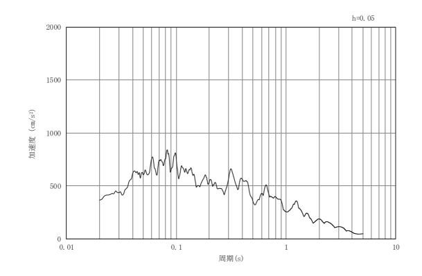
図3-75 岩盤部(断面⑤)の入力地震動の加速度時刻歴波形及び加速度応答スペクトル(8/28) (鉛直成分:Ss-F1)
