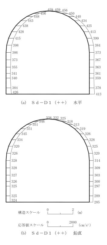
図 4-247 最大加速度分布図(解析ケース③)(29/56)
