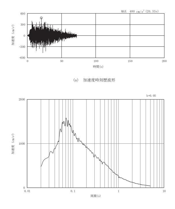
図3-56 土砂部(断面③)の入力地震動の加速度時刻歴波形及び加速度応答スペクトル(17/28) (水平成分: Sd-D2)
