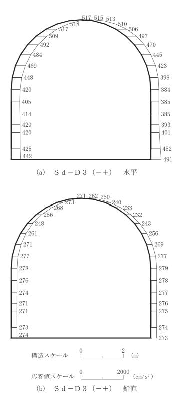
図 4-96 最大加速度分布図 (解析ケース③) (34/56)
