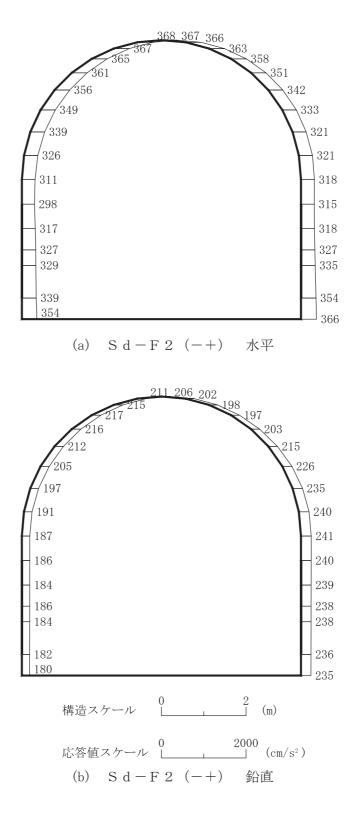
図 4-270 最大加速度分布図(解析ケース④)(52/56)
