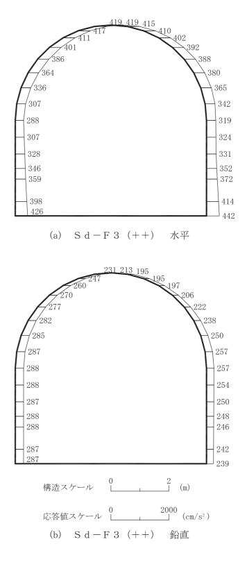
図 4-257 最大加速度分布図 (解析ケース③) (39/56)
