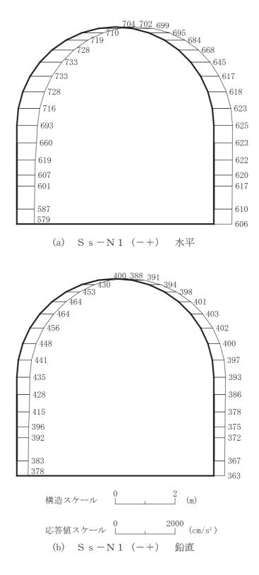
図 4-218 最大加速度分布図(解析ケース④)(56/56)
