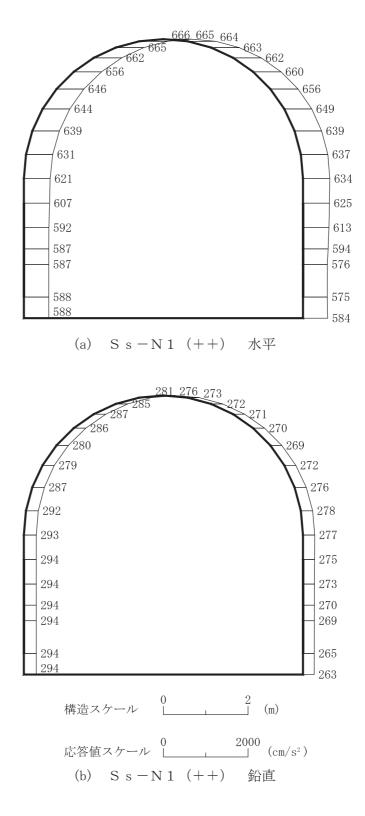
図 4-147 最大加速度分布図 (解析ケース⑧) (13/14)
