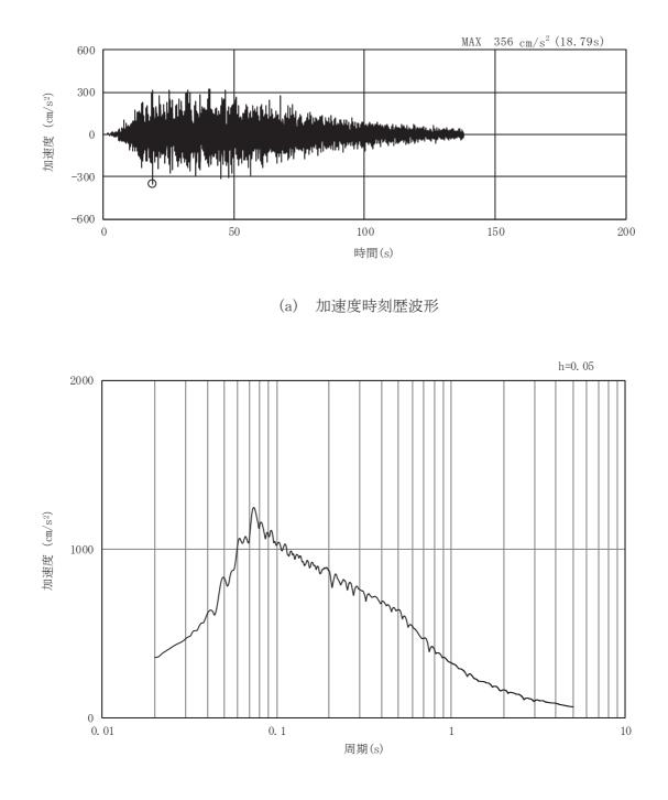
図3-26 土砂部(断面①)の入力地震動の加速度時刻歴波形及び加速度応答スペクトル(15/28) (水平成分: Sd-D1)
