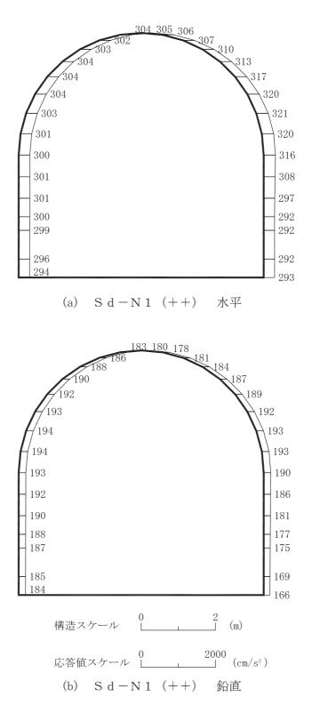
図 4-89 最大加速度分布図(解析ケース②)(27/56)
