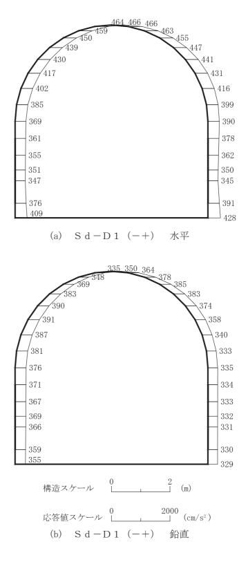
図 4-220 最大加速度分布図(解析ケース①)(2/56)
