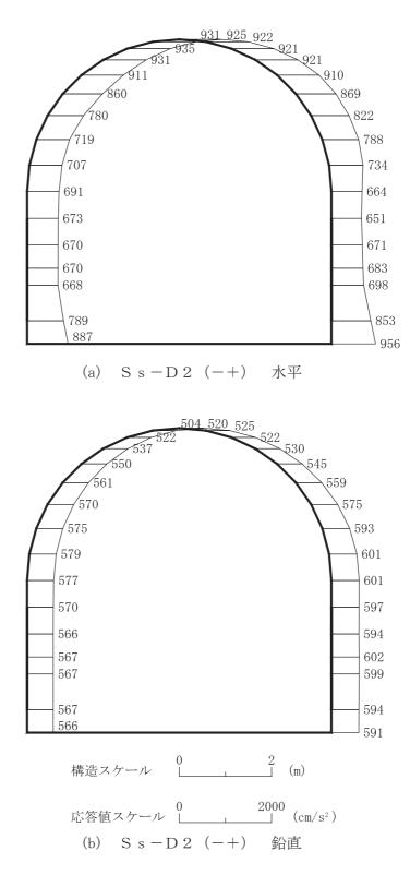
図 4-194 最大加速度分布図 (解析ケース③) (32/56)
