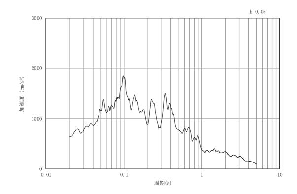
図3-48 土砂部(断面③)の入力地震動の加速度時刻歴波形及び加速度応答スペクトル(9/28) (水平成分:Ss-F2)
