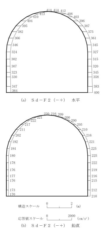
図 4-100 最大加速度分布図(解析ケース③)(38/56)
