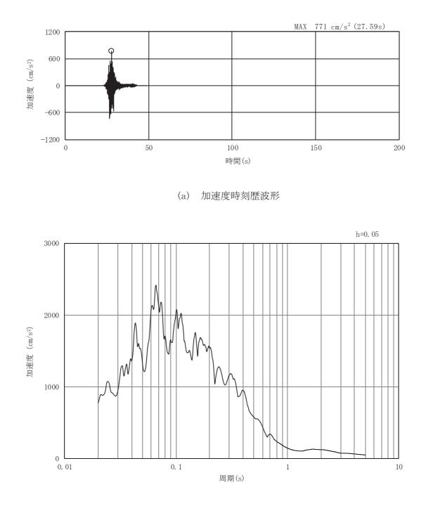
図3-22 土砂部(断面①)の入力地震動の加速度時刻歴波形及び加速度応答スペクトル(11/28) (水平成分:Ss-F3)
