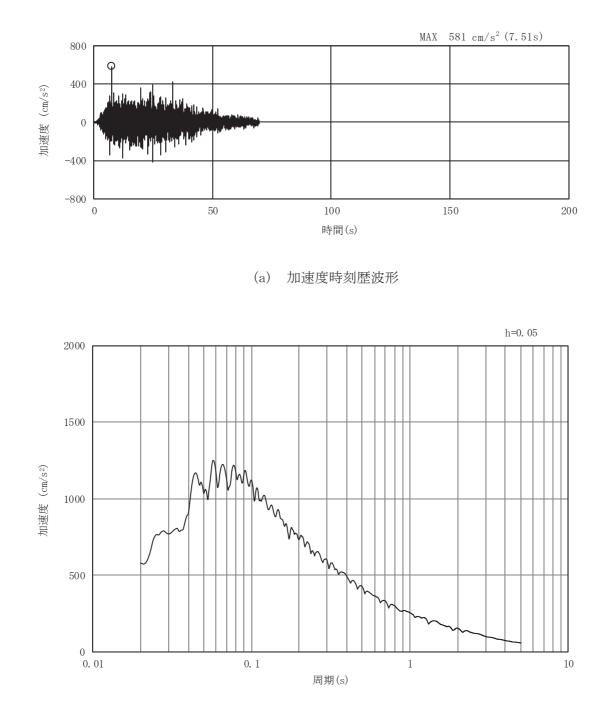
図3-17 土砂部(断面①)の入力地震動の加速度時刻歴波形及び加速度応答スペクトル(6/28) (鉛直成分: Ss-D3)
