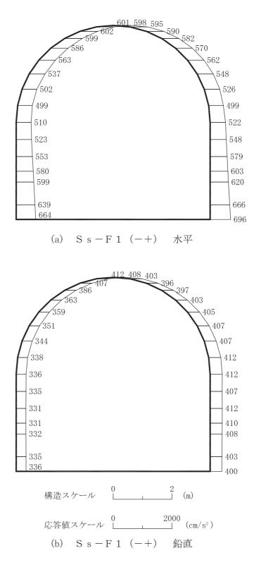
図 4-8 最大加速度分布図(解析ケース①)(8/20)
