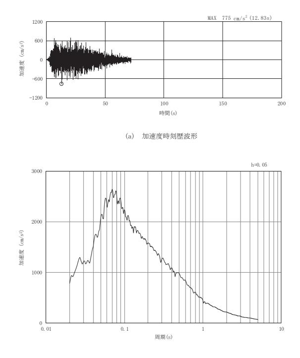
図3-70 岩盤部(断面⑤)の入力地震動の加速度時刻歴波形及び加速度応答スペクトル(3/28) (水平成分: Ss-D2)
