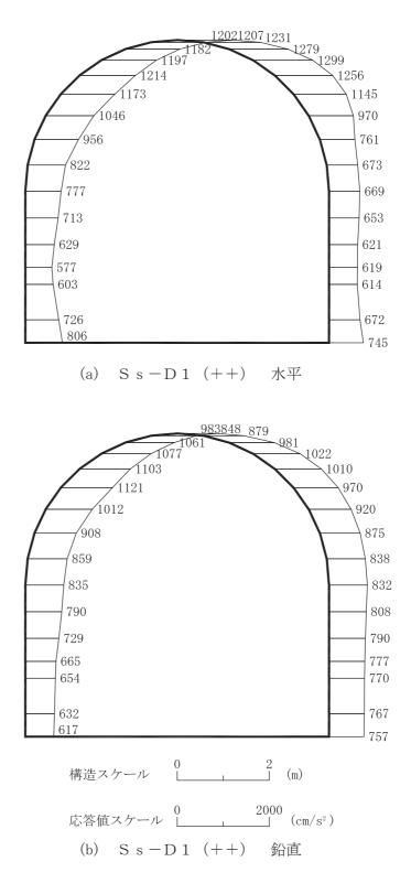
図 4-163 最大加速度分布図 (解析ケース①) (1/56)
