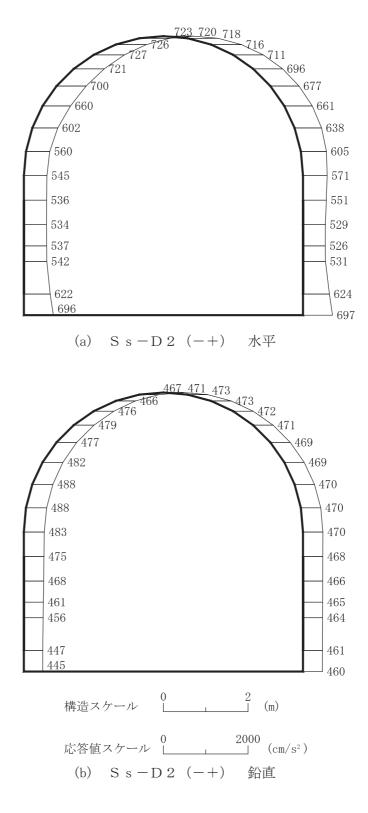
図 4-122 最大加速度分布図(解析ケース⑥)(4/16)
