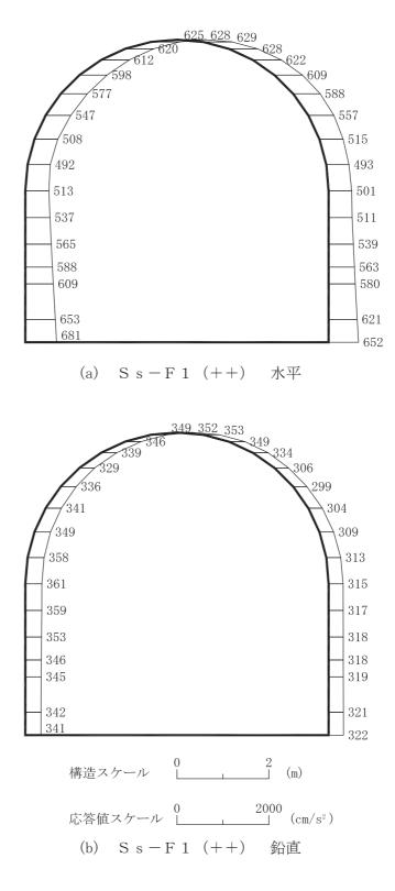
図 4-7 最大加速度分布図(解析ケース①)(7/20)
