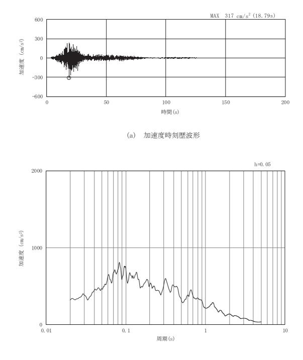
図3-88 岩盤部(断面⑤)の入力地震動の加速度時刻歴波形及び加速度応答スペクトル(21/28) (水平成分:Sd-F1)
