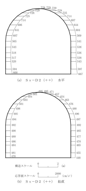
図 4-121 最大加速度分布図(解析ケース⑥)(3/16)
