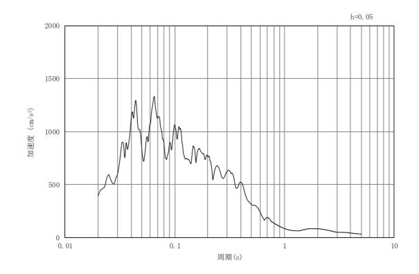
図3-79 岩盤部(断面⑤)の入力地震動の加速度時刻歴波形及び加速度応答スペクトル(12/28) (鉛直成分:Ss-F3)
