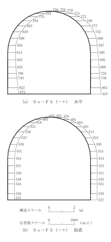
図 4-202 最大加速度分布図(解析ケース③)(40/56)
