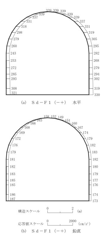
図 4-254 最大加速度分布図 (解析ケース③) (36/56)
