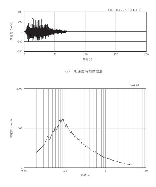
図3-58 土砂部(断面③)の入力地震動の加速度時刻歴波形及び加速度応答スペクトル(19/28) (水平成分: Sd-D3)
