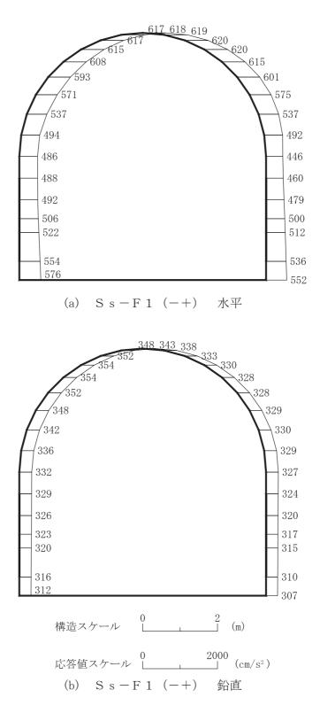
図 4-142 最大加速度分布図 (解析ケース⑧) (8/14)
