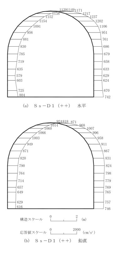
図 4-205 最大加速度分布図(解析ケース④)(43/56)
