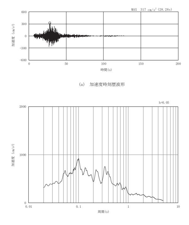
図3-90 岩盤部(断面⑤)の入力地震動の加速度時刻歴波形及び加速度応答スペクトル(23/28) (水平成分:Sd-F2)
