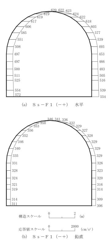
図 4-126 最大加速度分布図(解析ケース⑥)(8/16)
