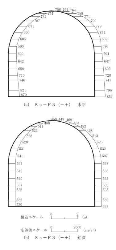
図 4-216 最大加速度分布図 (解析ケース④) (54/56)
