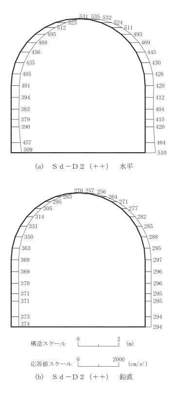
図 4-249 最大加速度分布図(解析ケース③)(31/56)
