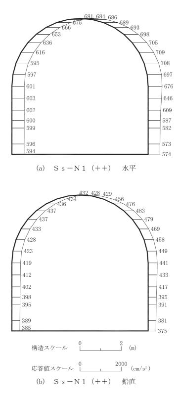
図 4-175 最大加速度分布図(解析ケース①)(13/56)
