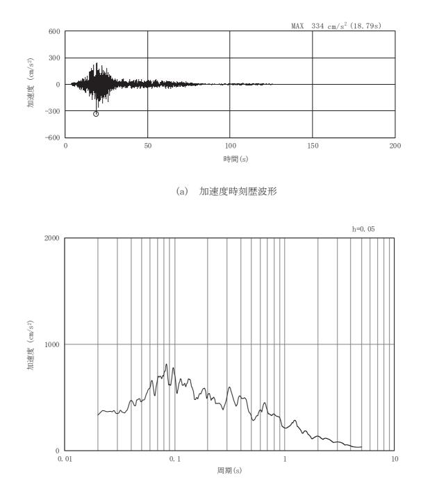
図3-60 土砂部(断面③)の入力地震動の加速度時刻歴波形及び加速度応答スペクトル(21/28) (水平成分: Sd-F1)
