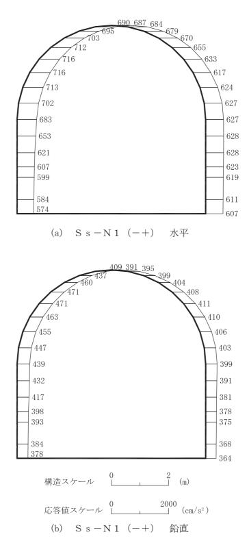
図 4-176 最大加速度分布図 (解析ケース①) (14/56)
