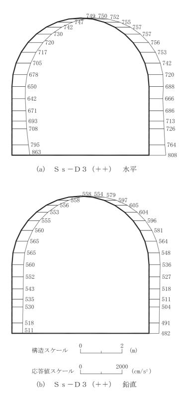
図 4-181 最大加速度分布図(解析ケース②)(19/56)
