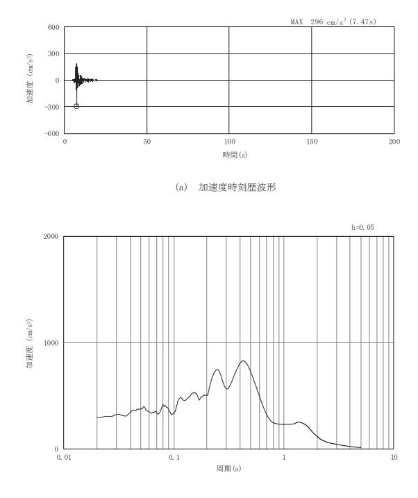
図3-94 岩盤部(断面⑤)の入力地震動の加速度時刻歴波形及び加速度応答スペクトル(27/28) (水平成分: Sd-N1)
