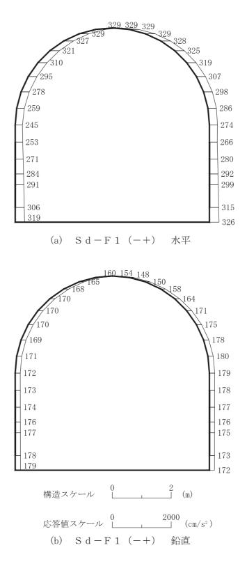
図 4-268 最大加速度分布図 (解析ケース④) (50/56)
