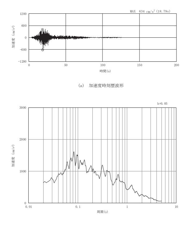
図3-74 岩盤部(断面⑤)の入力地震動の加速度時刻歴波形及び加速度応答スペクトル(7/28) (水平成分:Ss-F1)
