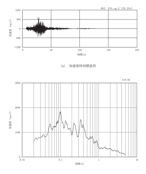
図3-76 岩盤部(断面⑤)の入力地震動の加速度時刻歴波形及び加速度応答スペクトル(9/28) (水平成分:Ss-F2)
