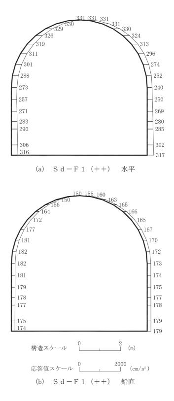
図 4-225 最大加速度分布図(解析ケース①)(7/56)
