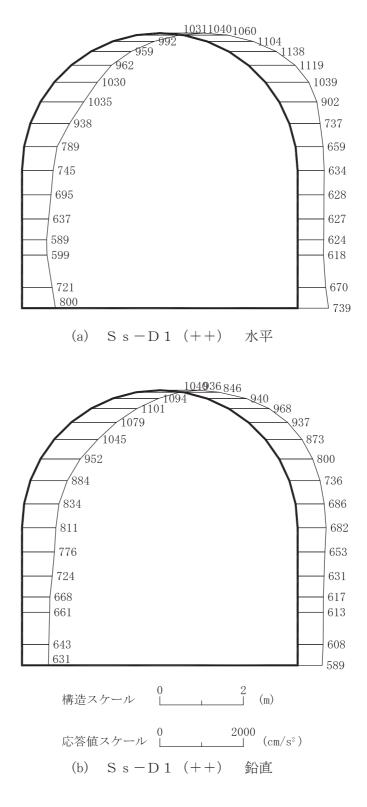
図 4-177 最大加速度分布図(解析ケース②)(15/56)
