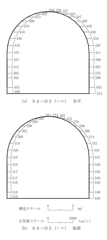
図 4-250 最大加速度分布図(解析ケース③)(32/56)
