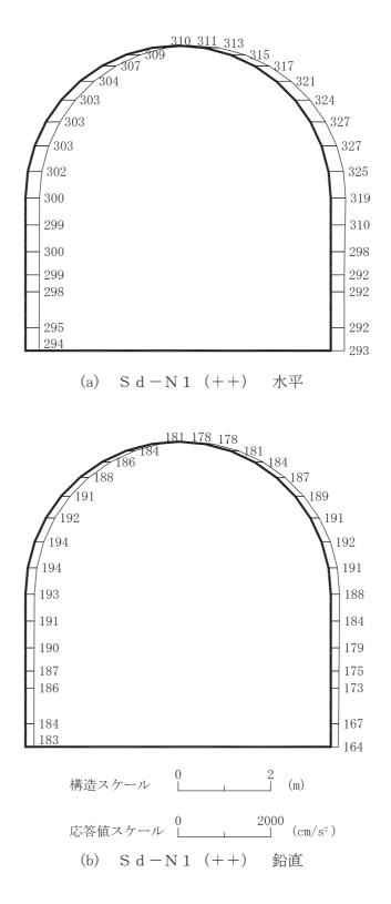
図 4-75 最大加速度分布図 (解析ケース①) (13/56)
