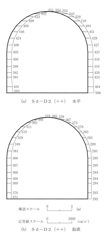
図 4-221 最大加速度分布図(解析ケース①)(3/56)
