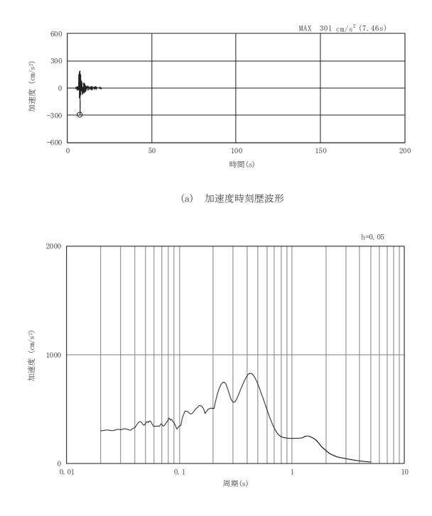
図3-38 土砂部(断面①)の入力地震動の加速度時刻歴波形及び加速度応答スペクトル(27/28) (水平成分: Sd-N1)
