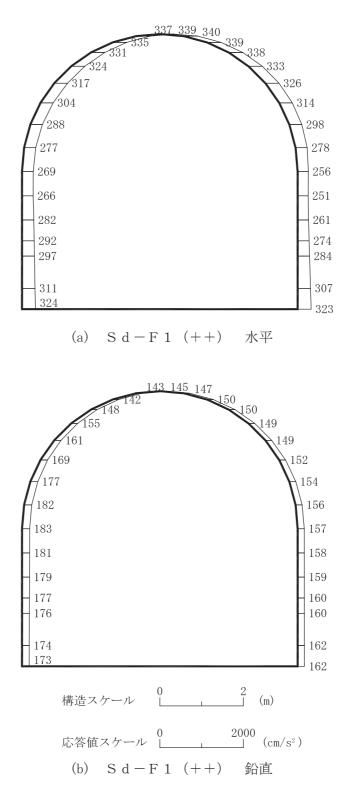
図 4-83 最大加速度分布図(解析ケース②)(21/56)
