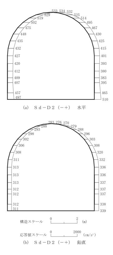
図 4-236 最大加速度分布図(解析ケース②)(18/56)
