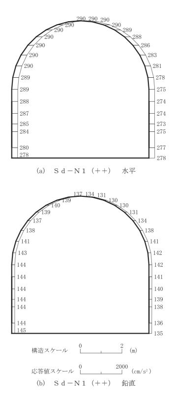
図 4-161 最大加速度分布図(解析ケース⑧)(13/14)
