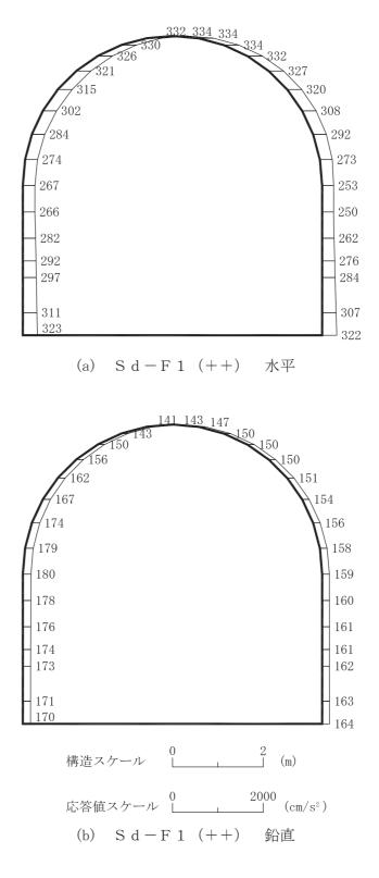
図 4-69 最大加速度分布図 (解析ケース①) (7/56)
