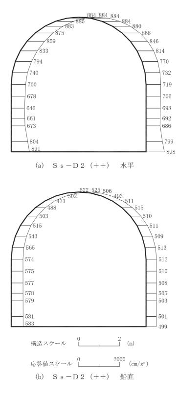
図 4-37 最大加速度分布図 (解析ケース③) (17/42)
