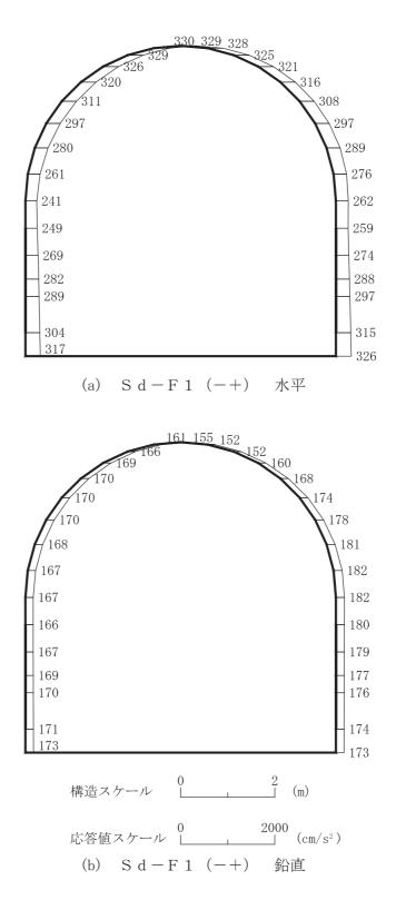
図 4-240 最大加速度分布図(解析ケース②)(22/56)
