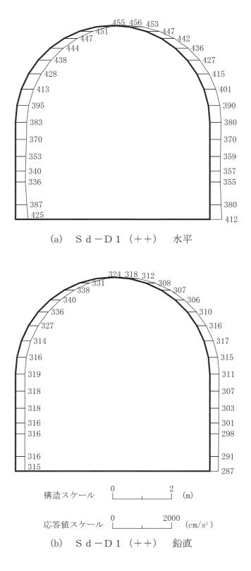
図 4-261 最大加速度分布図 (解析ケース④) (43/56)
