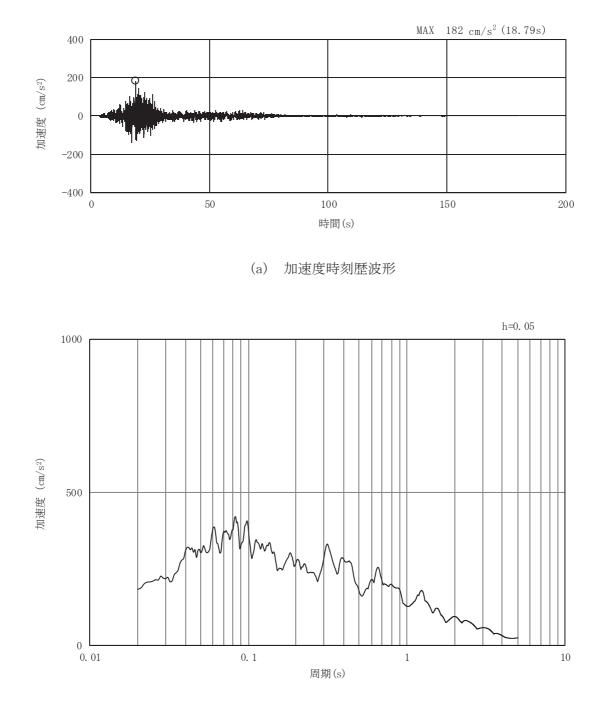
図3-89 岩盤部(断面⑤)の入力地震動の加速度時刻歴波形及び加速度応答スペクトル(22/28) (鉛直成分:Sd-F1)
