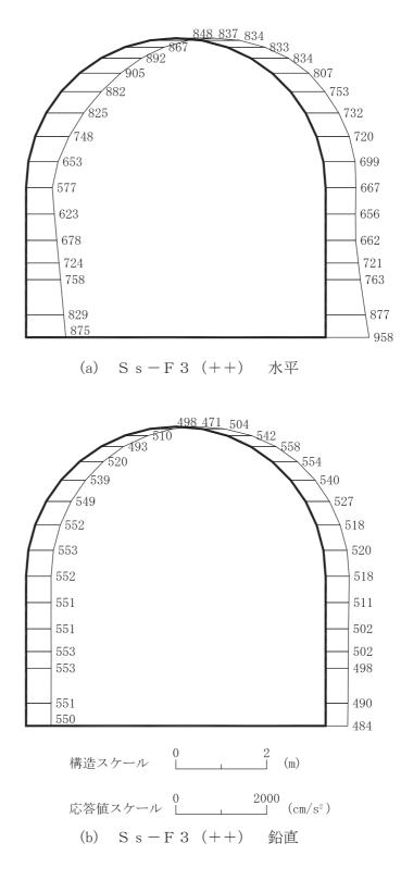
図 4-11 最大加速度分布図 (解析ケース①) (11/20)
