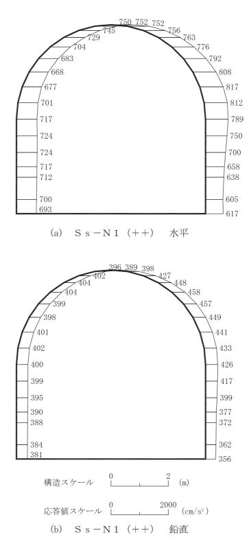
図 4-33 最大加速度分布図(解析ケース②)(13/42)
