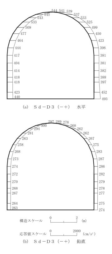
図 4-82 最大加速度分布図 (解析ケース②) (20/56)
