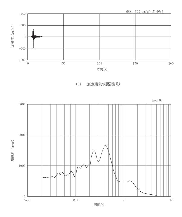
図3-52 土砂部(断面③)の入力地震動の加速度時刻歴波形及び加速度応答スペクトル(13/28) (水平成分:Ss-N1)
