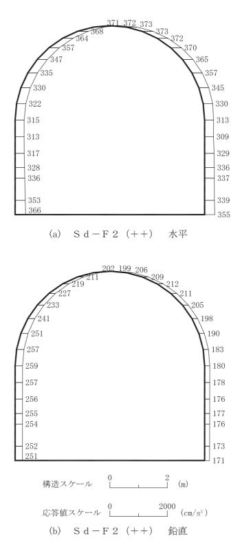
図 4-227 最大加速度分布図(解析ケース①)(9/56)
