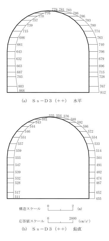
図 4-195 最大加速度分布図(解析ケース③)(33/56)
