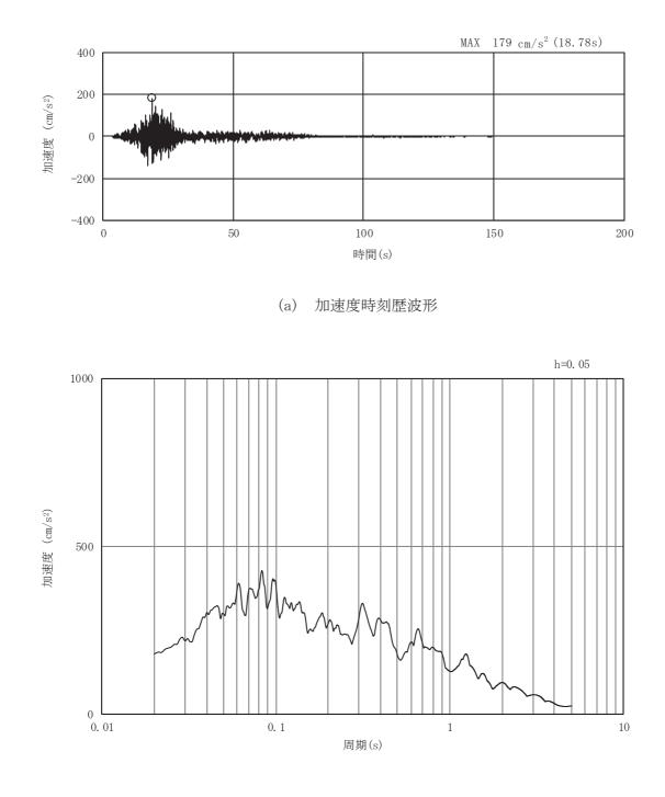
図3-33 土砂部(断面①)の入力地震動の加速度時刻歴波形及び加速度応答スペクトル(22/28) (鉛直成分:Sd-F1)
