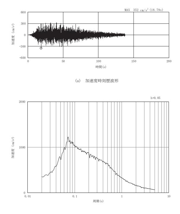
図3-82 岩盤部(断面⑤)の入力地震動の加速度時刻歴波形及び加速度応答スペクトル(15/28) (水平成分:Sd-D1)
