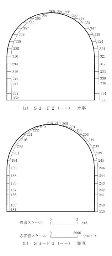
図 4-242 最大加速度分布図(解析ケース②)(24/56)
