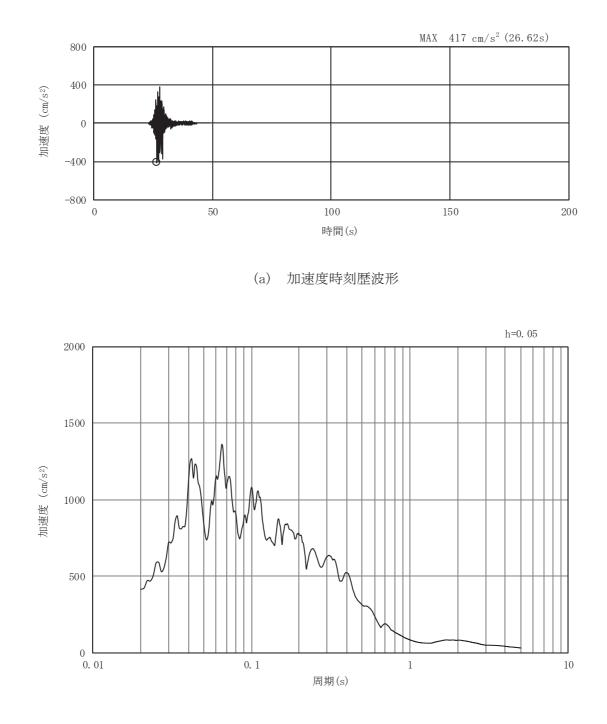
図3-23 土砂部(断面①)の入力地震動の加速度時刻歴波形及び加速度応答スペクトル(12/28) (鉛直成分:Ss-F3)
