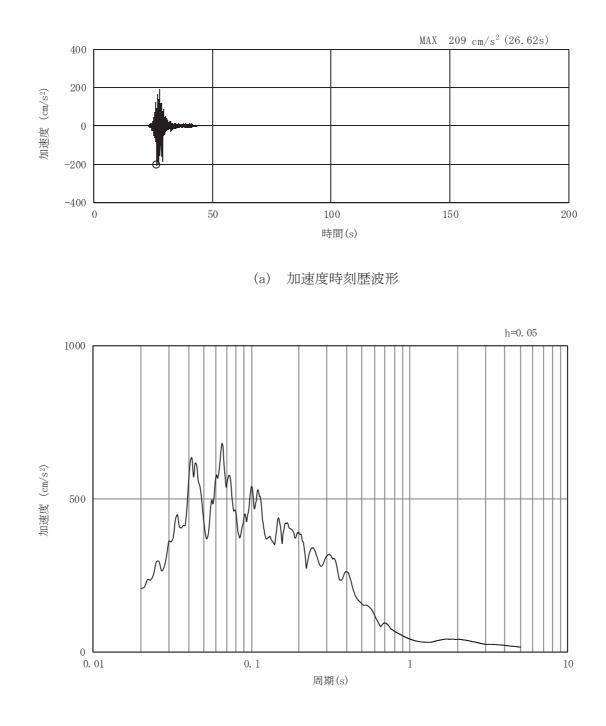
図3-65 土砂部(断面③)の入力地震動の加速度時刻歴波形及び加速度応答スペクトル(26/28) (鉛直成分:Sd-F3)
