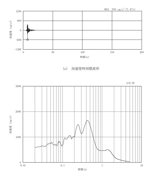
図3-80 岩盤部(断面⑤)の入力地震動の加速度時刻歴波形及び加速度応答スペクトル(13/28) (水平成分:Ss-N1)
