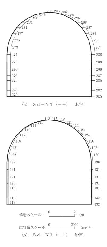
図4-162 最大加速度分布図(解析ケース⑧)(14/14)
