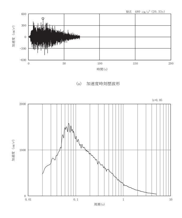
図3-28 土砂部(断面①)の入力地震動の加速度時刻歴波形及び加速度応答スペクトル(17/28) (水平成分: Sd-D2)
