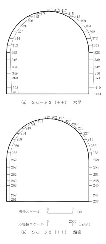
図 4-243 最大加速度分布図(解析ケース②)(25/56)
