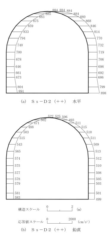
図 4-17 最大加速度分布図 (解析ケース③:曲げ・軸力系の破壊に対する最大照査値ケース)(17/20)
