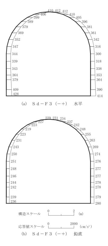
図 4-272 最大加速度分布図(解析ケース④)(54/56)
