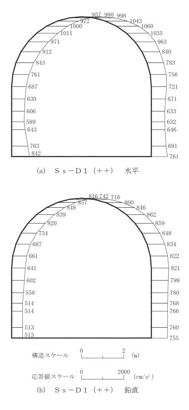
図 4-49 最大加速度分布図 (解析ケース④ (29/42))
