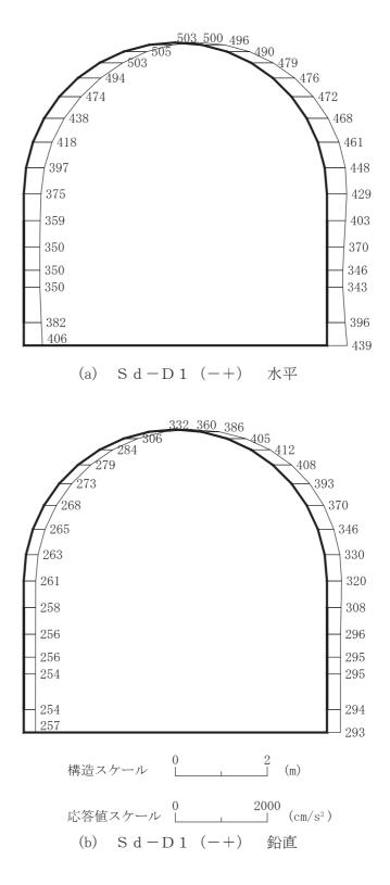
図 4-78 最大加速度分布図 (解析ケース②) (16/56)
