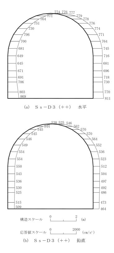
図 4-209 最大加速度分布図(解析ケース④)(47/56)
