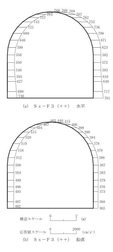
図 4-129 最大加速度分布図(解析ケース⑥)(11/16)
