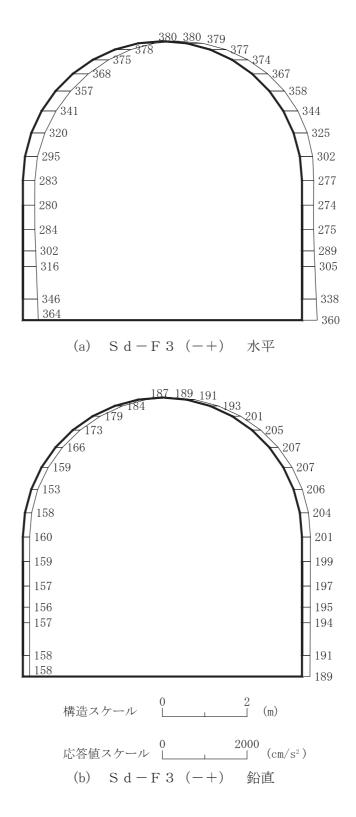
図 4-160 最大加速度分布図(解析ケース⑧)(12/14)
