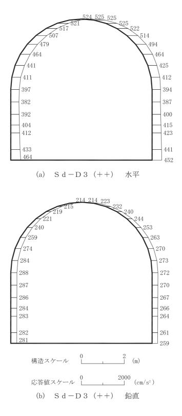
図 4-95 最大加速度分布図 (解析ケース③) (33/56)
