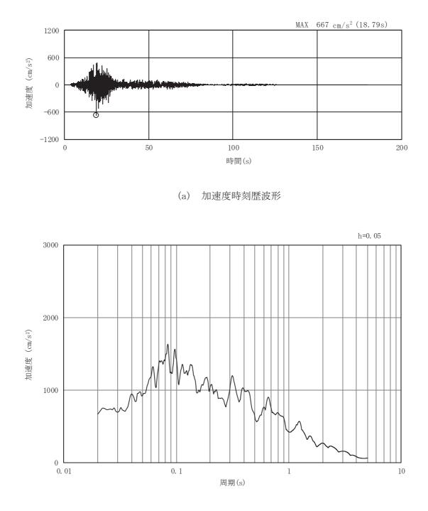
図3-18 土砂部(断面①)の入力地震動の加速度時刻歴波形及び加速度応答スペクトル(7/28) (水平成分:Ss-F1)
