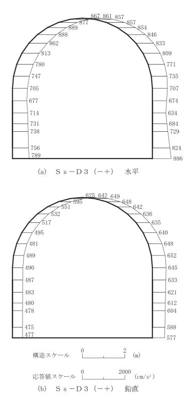
図 4-26 最大加速度分布図 (解析ケース②) (6/42)
