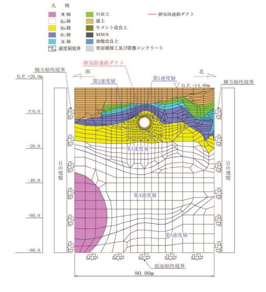
図 3-98 排気筒連絡ダクトの地震応答解析モデル図(岩盤部(断面⑤))
