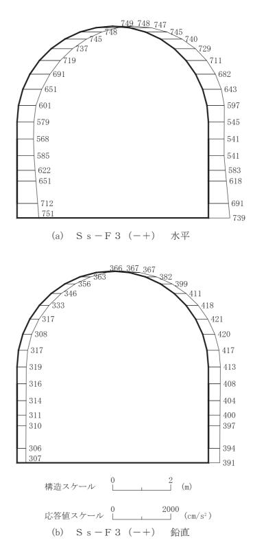
図 4-146 最大加速度分布図(解析ケース⑧)(12/14)
