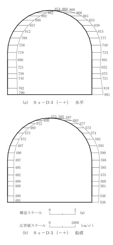
図 4-54 最大加速度分布図 (解析ケース④) (34/42)
