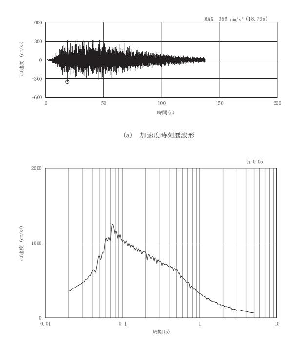
図3-54 土砂部(断面③)の入力地震動の加速度時刻歴波形及び加速度応答スペクトル(15/28) (水平成分: Sd-D1)
