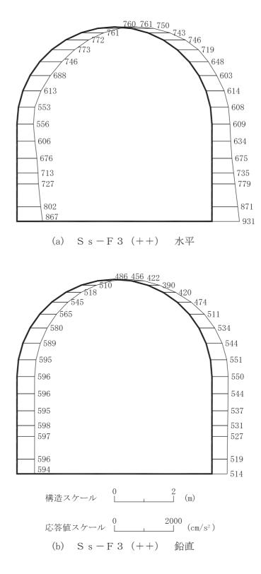
図 4-187 最大加速度分布図(解析ケース②)(25/56)
