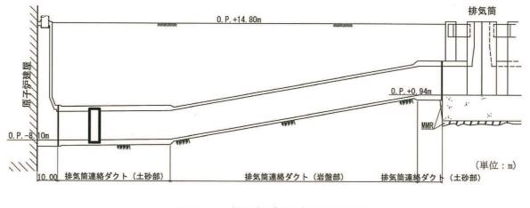
図 2-5 排気筒連絡ダクト縦断図
