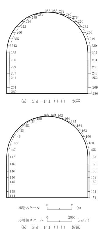
図 4-155 最大加速度分布図(解析ケース⑧)(7/14)
