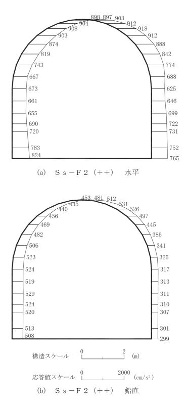
図 4-185 最大加速度分布図(解析ケース②)(23/56)
