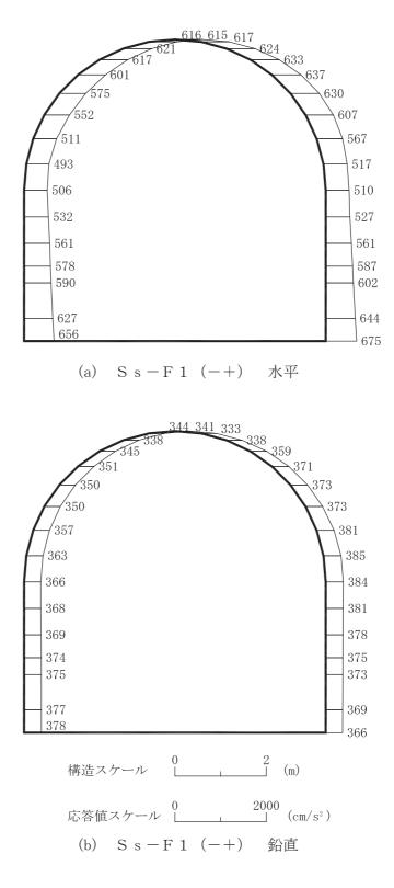
図 4-170 最大加速度分布図 (解析ケース①) (8/56)
