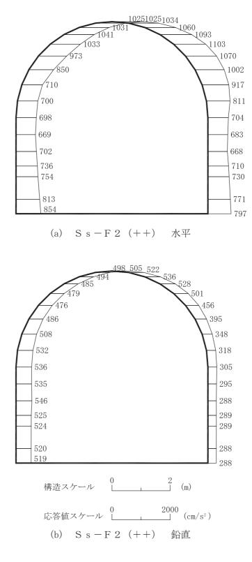
図 4-57 最大加速度分布図 (解析ケース④) (37/42)
