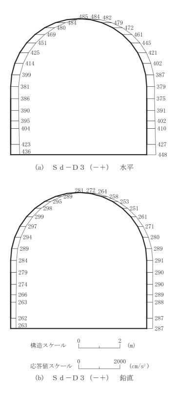
図 4-224 最大加速度分布図 (解析ケース①) (6/56)
