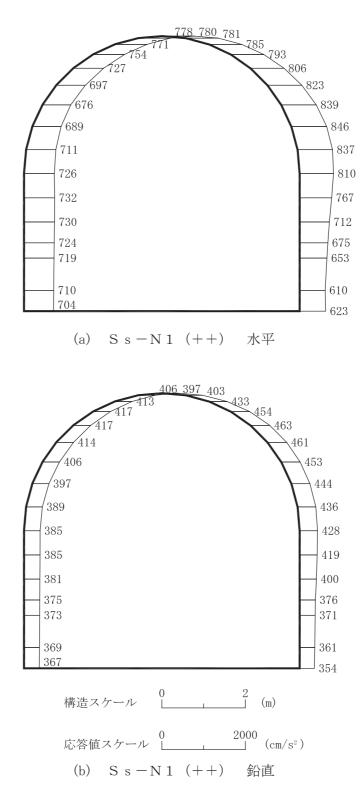
図 4-47 最大加速度分布図 (解析ケース③) (27/42)
