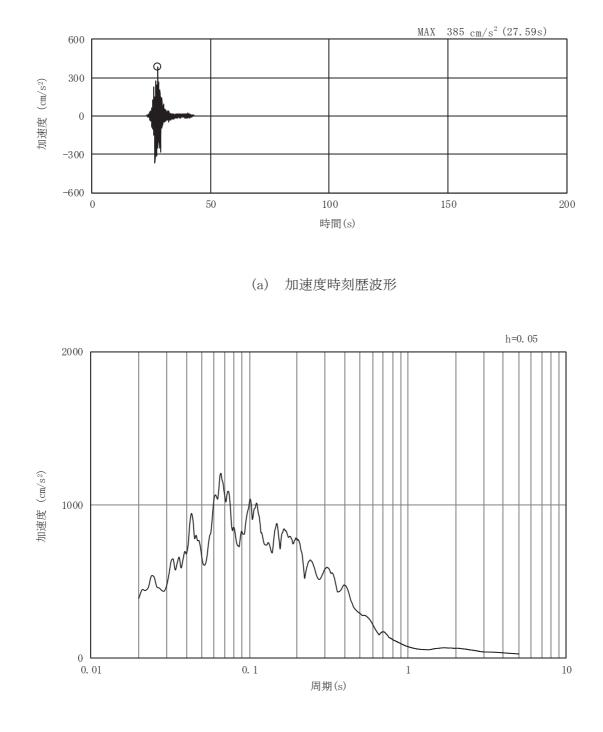
図3-36 土砂部(断面①)の入力地震動の加速度時刻歴波形及び加速度応答スペクトル(25/28) (水平成分: Sd-F3)
