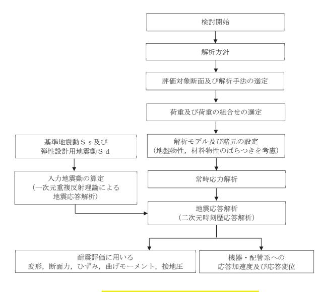
図 2-6 排気筒連絡ダクトの地震応答解析フロー
