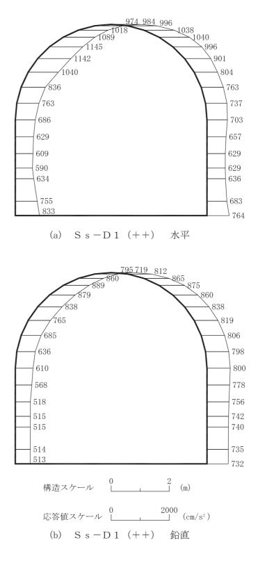
図 4-35 最大加速度分布図 (解析ケース③) (15/42)
