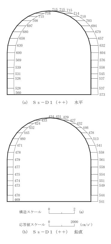
図 4-135 最大加速度分布図(解析ケース⑧)(1/14)
