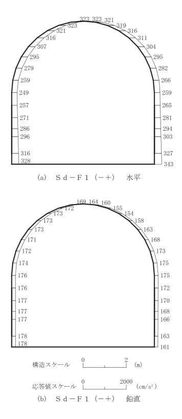
図 4-98 最大加速度分布図 (解析ケース③) (36/56)
