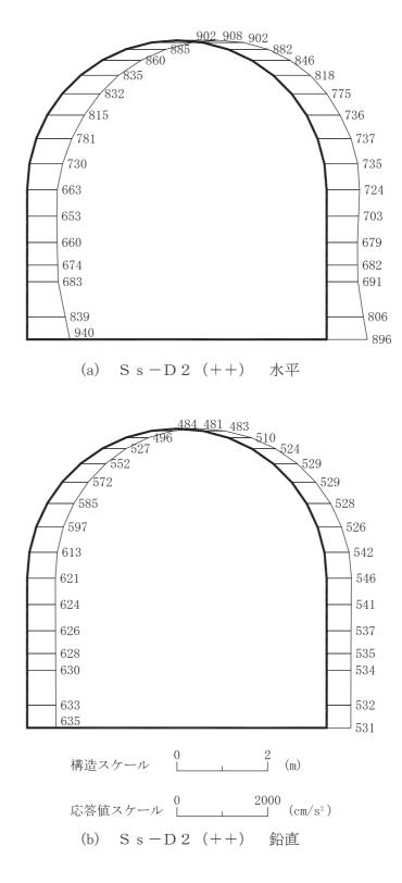
図 4-179 最大加速度分布図 (解析ケース②) (17/56)
