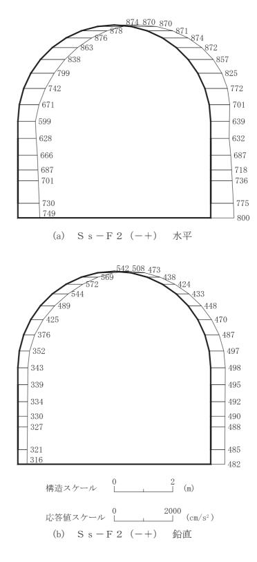
図 4-186 最大加速度分布図(解析ケース②)(24/56)
