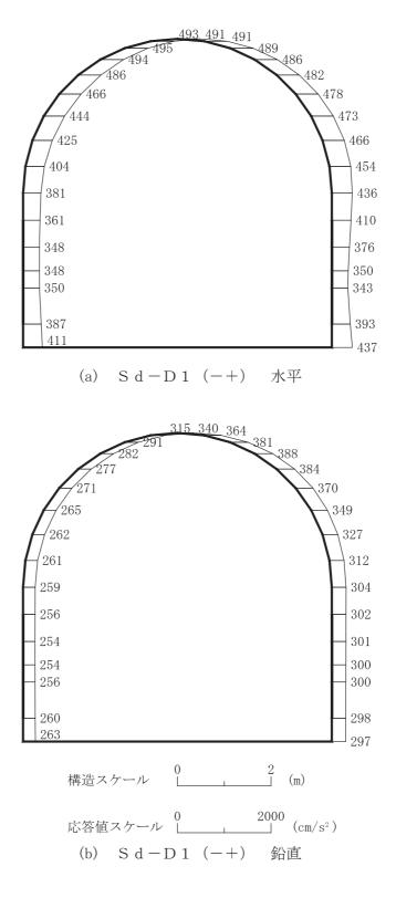
図 4-64 最大加速度分布図 (解析ケース①) (2/56)
