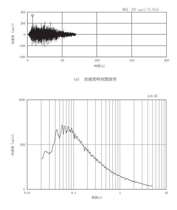
図3-87 岩盤部(断面⑤)の入力地震動の加速度時刻歴波形及び加速度応答スペクトル(20/28) (鉛直成分:Sd-D3)
