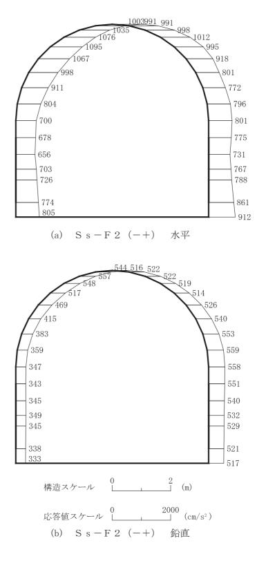
図 4-44 最大加速度分布図 (解析ケース③) (24/42)
