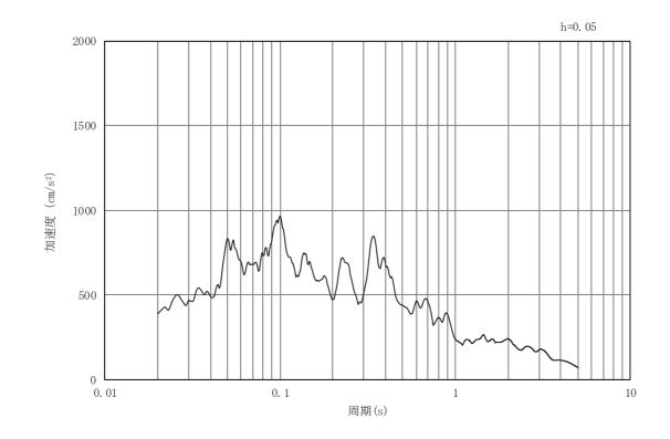
図3-77 岩盤部(断面⑤)の入力地震動の加速度時刻歴波形及び加速度応答スペクトル(10/28) (鉛直成分:Ss-F2)
