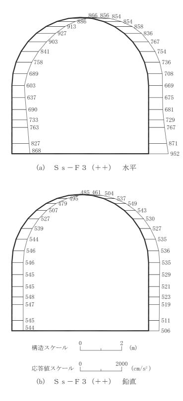
図 4-59 最大加速度分布図 (解析ケース④) (39/42)
