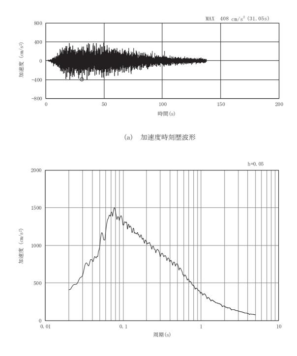
図3-41 土砂部(断面③)の入力地震動の加速度時刻歴波形及び加速度応答スペクトル(2/28) (鉛直成分: Ss-D1)
