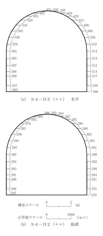
図 4-151 最大加速度分布図(解析ケース⑧)(3/14)
