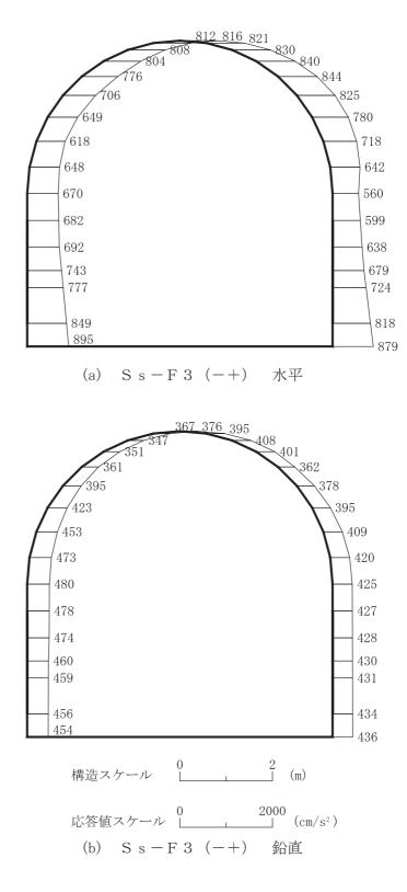
図 4-32 最大加速度分布図(解析ケース②)(12/42)
