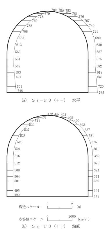
図 4-145 最大加速度分布図(解析ケース⑧)(11/14)
