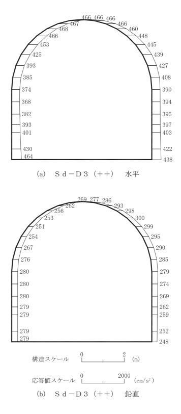
図 4-223 最大加速度分布図(解析ケース①)(5/56)
