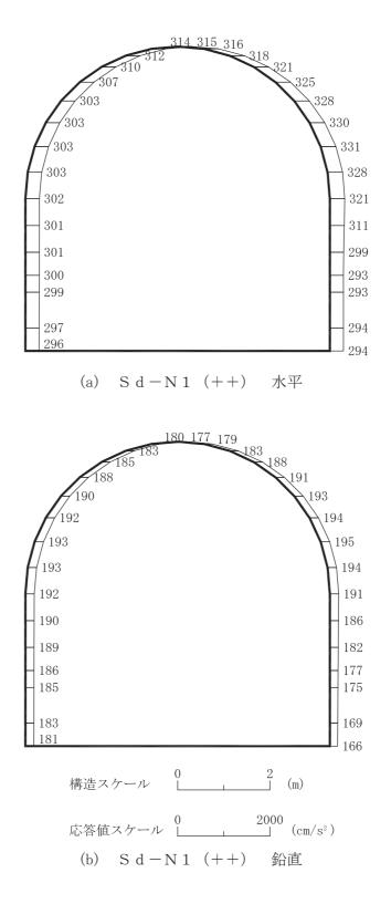
図 4-103 最大加速度分布図 (解析ケース③) (41/56)
