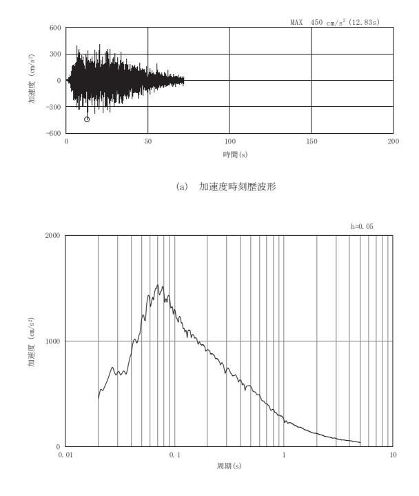
図3-84 岩盤部(断面⑤)の入力地震動の加速度時刻歴波形及び加速度応答スペクトル(17/28) (水平成分:Sd-D2)
