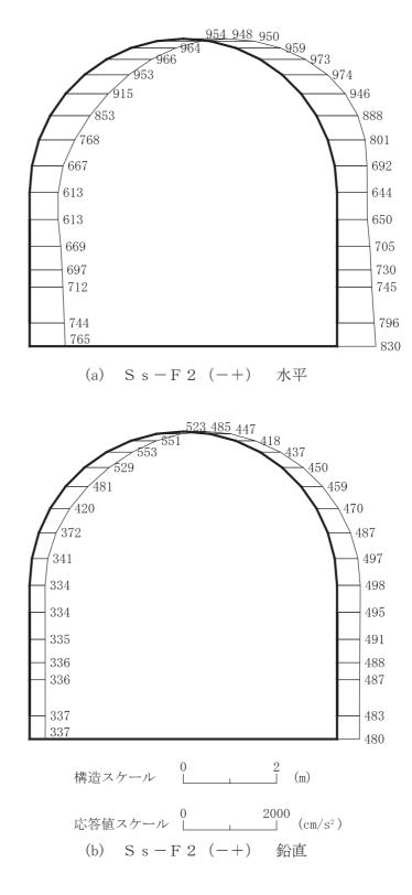
図 4-200 最大加速度分布図(解析ケース③)(38/56)
