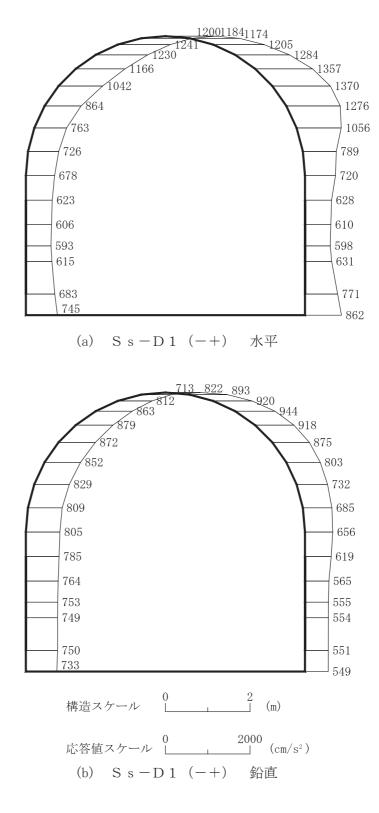
図 4-36 最大加速度分布図(解析ケース③)(16/42)
