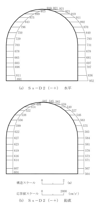
図 4-4 最大加速度分布図 (解析ケース①) (4/20)
