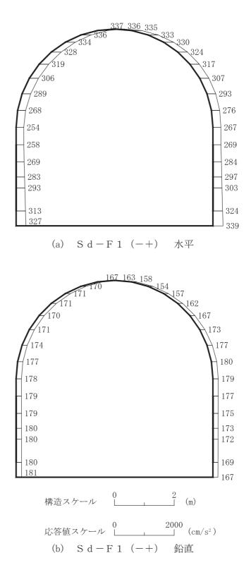
図 4-112 最大加速度分布図(解析ケース④)(50/56)
