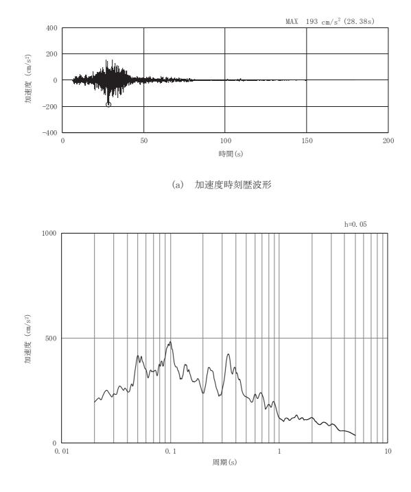
図3-91 岩盤部(断面⑤)の入力地震動の加速度時刻歴波形及び加速度応答スペクトル(24/28) (鉛直成分:Sd-F2)
