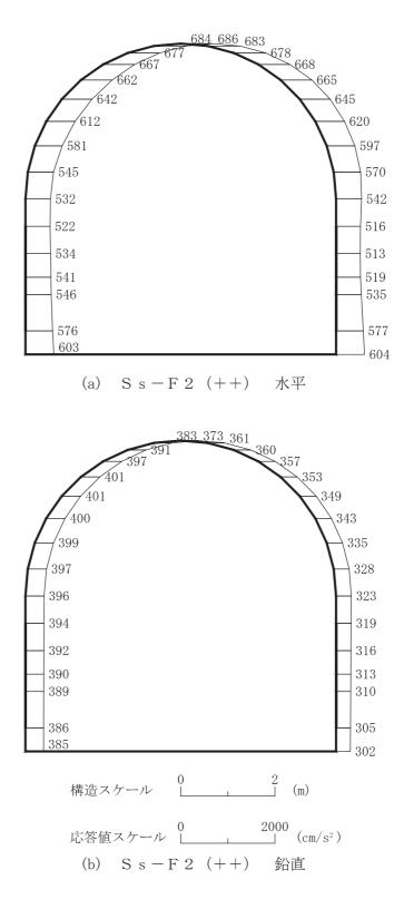
図 4-127 最大加速度分布図 (解析ケース⑥) (9/16)
