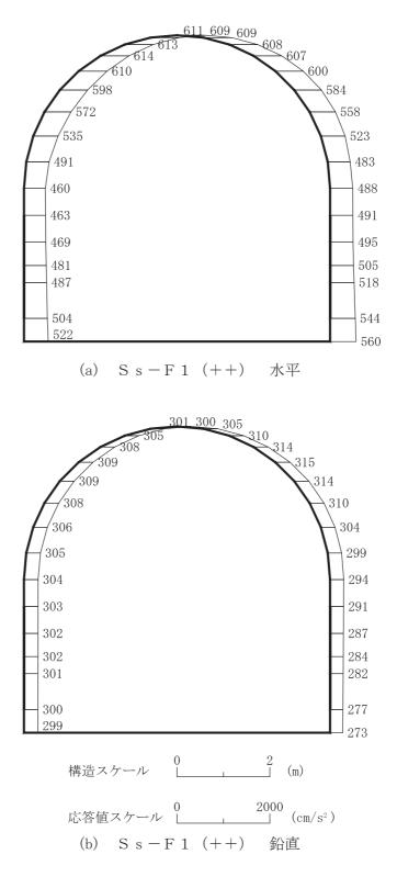
図 4-141 最大加速度分布図(解析ケース⑧)(7/14)
