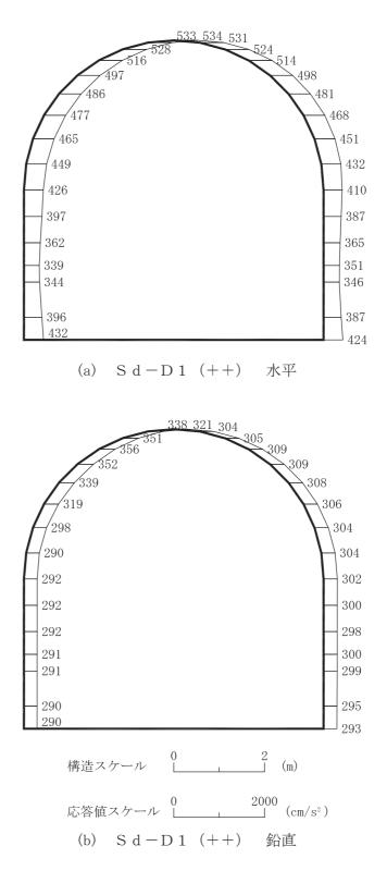
図 4-105 最大加速度分布図(解析ケース④)(43/56)
