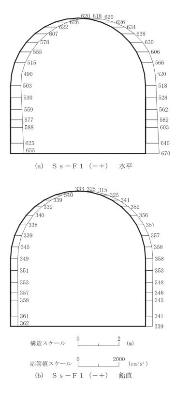
図 4-184 最大加速度分布図 (解析ケース②) (22/56)
