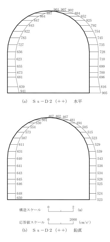
図 4-193 最大加速度分布図(解析ケース③)(31/56)
