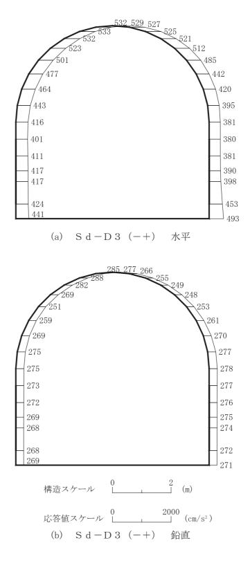
図 4-68 最大加速度分布図 (解析ケース①) (6/56)
