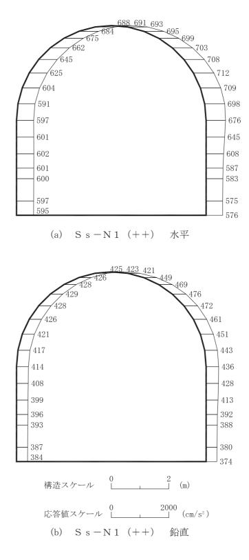
図 4-217 最大加速度分布図(解析ケース④)(55/56)
