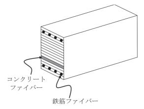
図 3-5 ファイバーモデルの概念図
