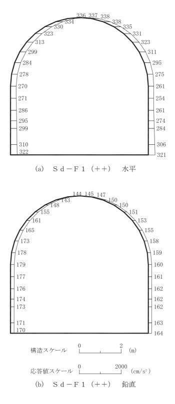
図 4-111 最大加速度分布図(解析ケース④)(49/56)
