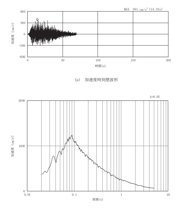
図3-86 岩盤部(断面⑤)の入力地震動の加速度時刻歴波形及び加速度応答スペクトル(19/28) (水平成分:Sd-D3)
