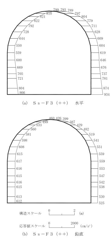
図 4-215 最大加速度分布図(解析ケース④)(53/56)
