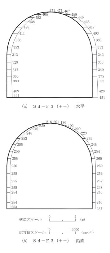
図 4-115 最大加速度分布図(解析ケース④)(53/56)
