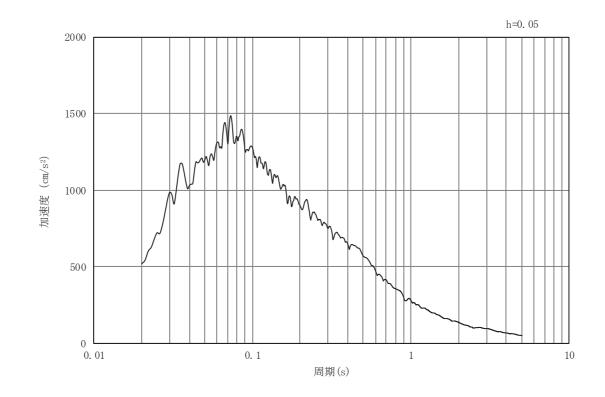
図3-71 岩盤部(断面⑤)の入力地震動の加速度時刻歴波形及び加速度応答スペクトル(4/28) (鉛直成分: Ss-D2)
