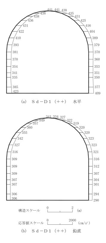
図 4-233 最大加速度分布図(解析ケース②)(15/56)
