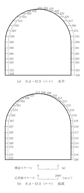
図 4-153 最大加速度分布図(解析ケース⑧)(5/14)
