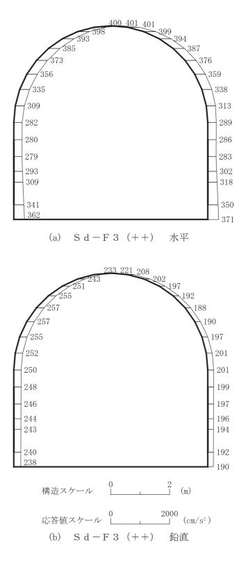
図 4-159 最大加速度分布図 (解析ケース⑧) (11/14)
