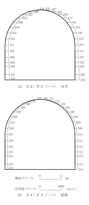
図 4-102 最大加速度分布図 (解析ケース③) (40/56)
