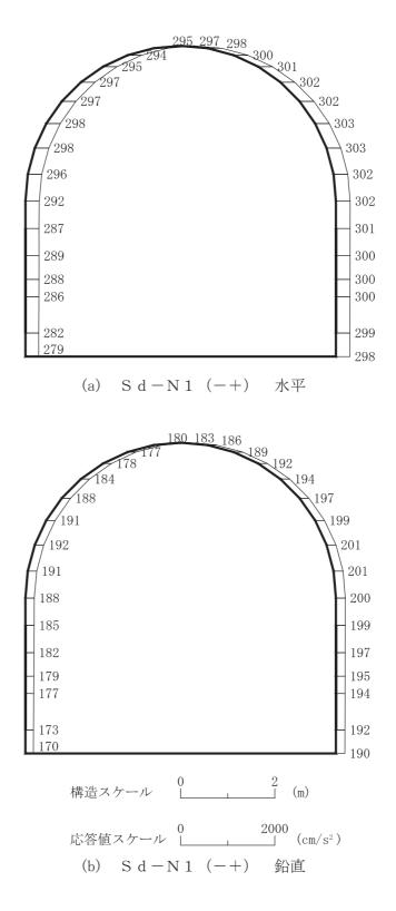
図 4-232 最大加速度分布図(解析ケース①)(14/56)
