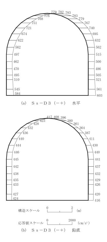
図 4-133 最大加速度分布図
