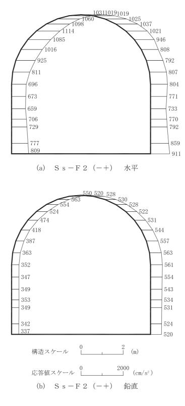
図 4-10 最大加速度分布図(解析ケース①)(10/20)
