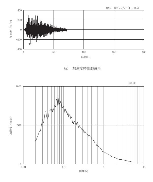
図3-85 岩盤部(断面⑤)の入力地震動の加速度時刻歴波形及び加速度応答スペクトル(18/28) (鉛直成分:Sd-D2)
