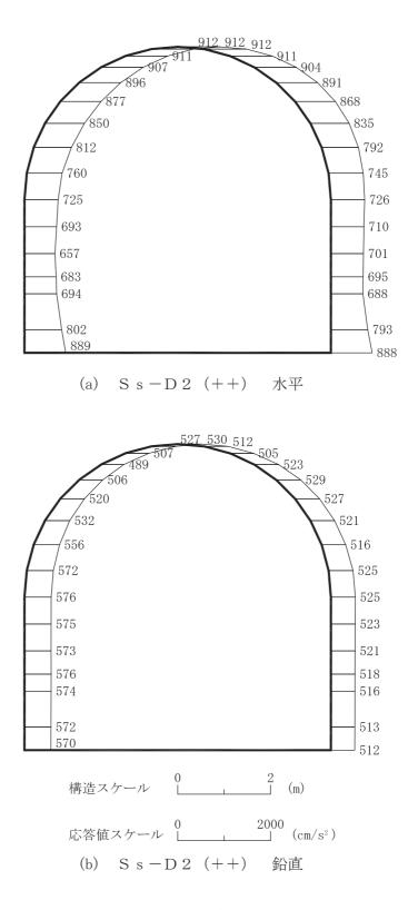
図 4-19 最大加速度分布図 (解析ケース④:曲げ・軸力系の破壊に対する最大照査値ケース)(19/20)
