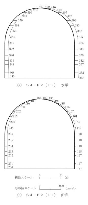
図 4-85 最大加速度分布図 (解析ケース②) (23/56)
