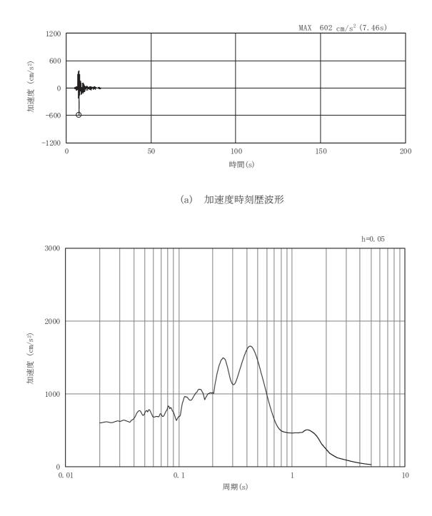
図3-24 土砂部(断面①)の入力地震動の加速度時刻歴波形及び加速度応答スペクトル(13/28) (水平成分:Ss-N1)
