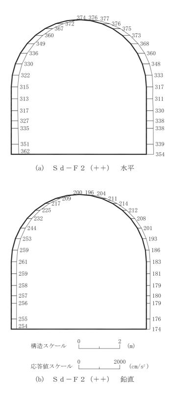
図 4-241 最大加速度分布図(解析ケース②)(23/56)
