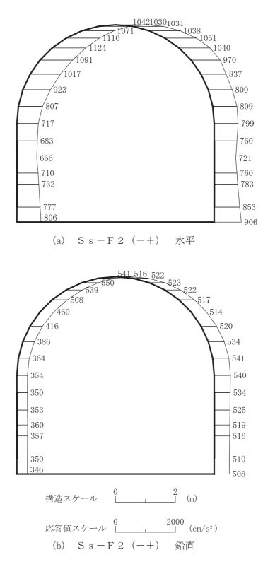
図 4-58 最大加速度分布図 (解析ケース④) (38/42)
