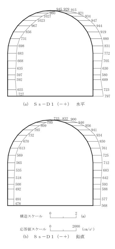
図 4-206 最大加速度分布図 (解析ケース④) (44/56)
