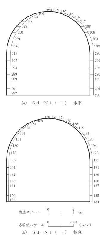
図 4-76 最大加速度分布図 (解析ケース①) (14/56)
