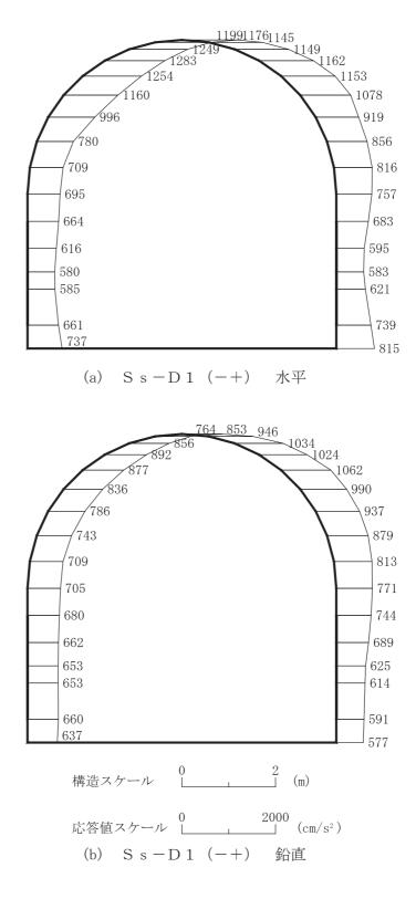
図 4-192 最大加速度分布図(解析ケース③)(30/56)
