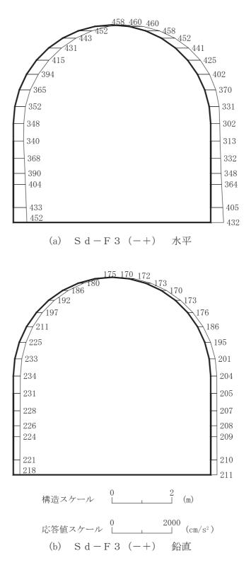
図 4-88 最大加速度分布図(解析ケース②)(26/56)
