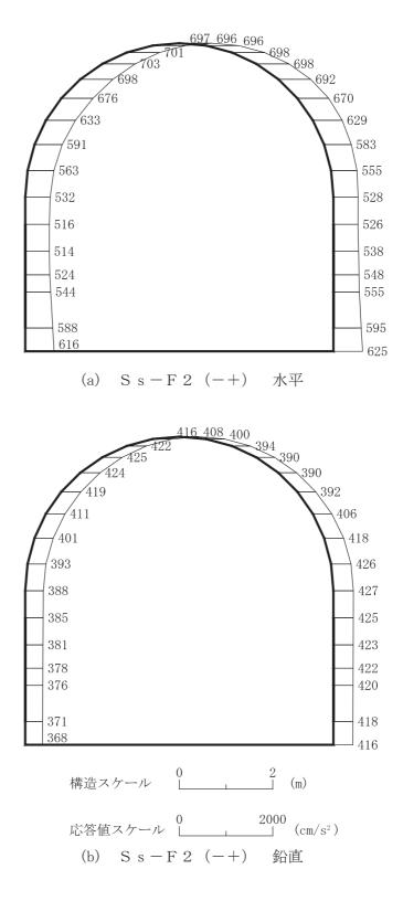
図 4-144 最大加速度分布図(解析ケース⑧)(10/14)
