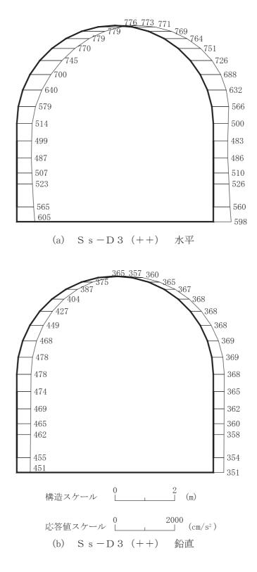
図 4-139 最大加速度分布図(解析ケース⑧)(5/14)
