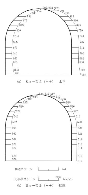
図 4-3 最大加速度分布図 (解析ケース①) (3/20)
