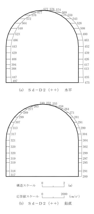
図 4-107 最大加速度分布図 (解析ケース④) (45/56)
