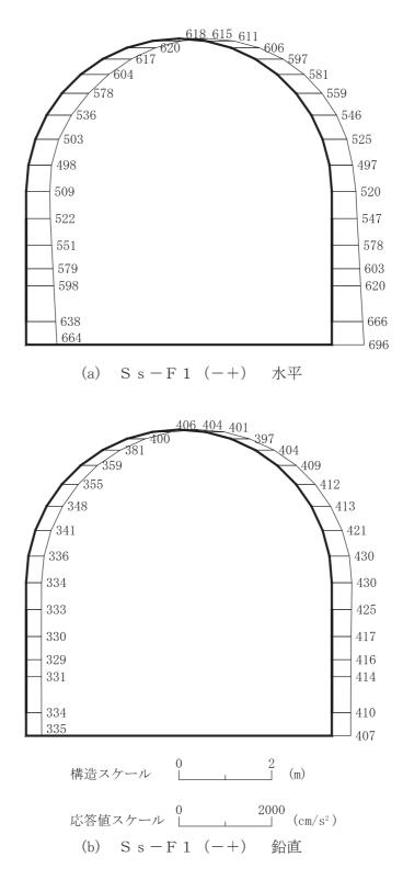
図 4-28 最大加速度分布図(解析ケース②)(8/42)
