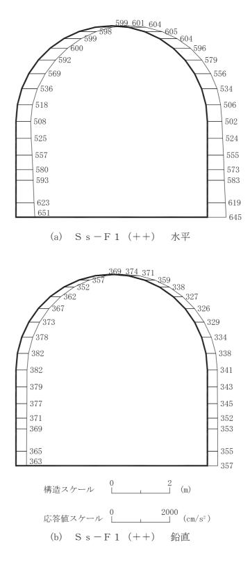
図 4-183 最大加速度分布図(解析ケース②)(21/56)
