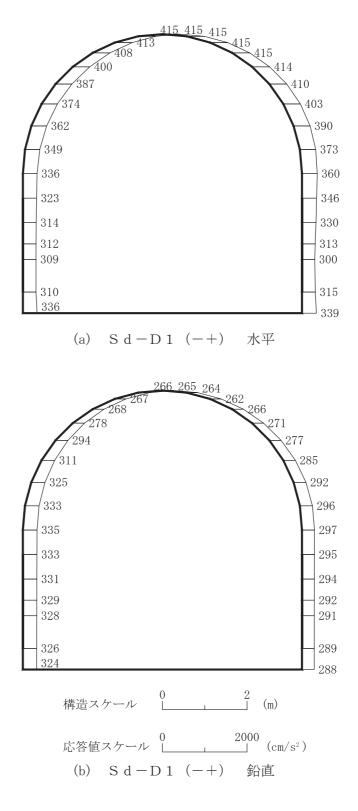
図 4-150 最大加速度分布図(解析ケース⑧)(2/14)
