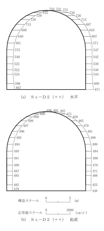
図 4-137 最大加速度分布図 (解析ケース⑧) (3/14)
