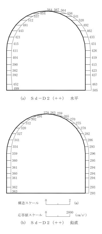
図 4-263 最大加速度分布図 (解析ケース④) (45/56)
