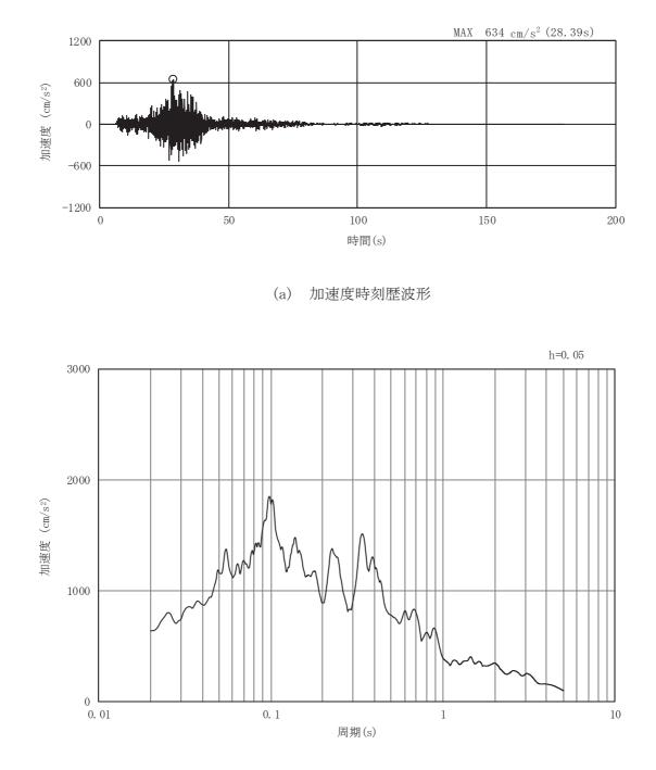
図3-20 土砂部(断面①)の入力地震動の加速度時刻歴波形及び加速度応答スペクトル(9/28) (水平成分: Ss-F2)
