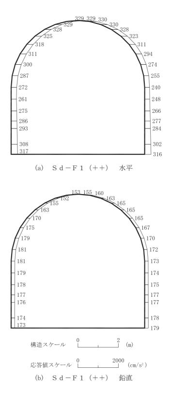
図 4-267 最大加速度分布図 (解析ケース④) (49/56)
