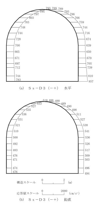
図 4-182 最大加速度分布図 (解析ケース②) (20/56)
