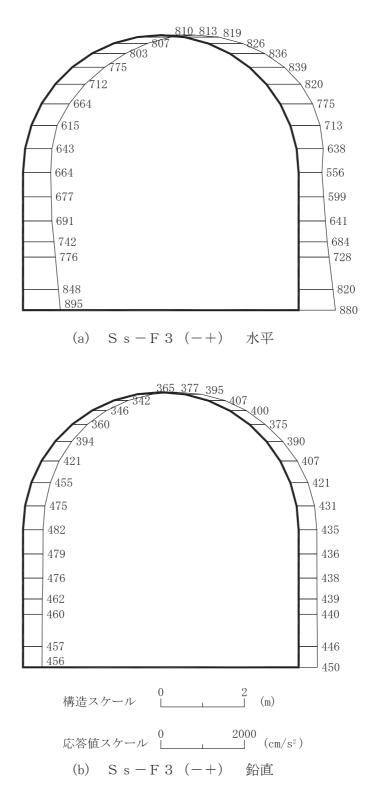
図 4-12 最大加速度分布図(解析ケース①)(12/20)
