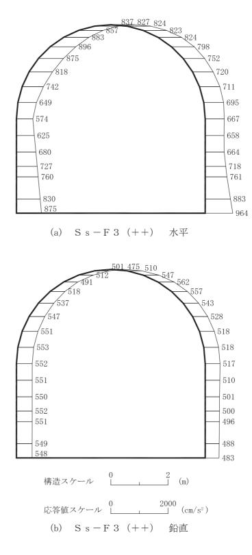
図 4-45 最大加速度分布図 (解析ケース③) (25/42)
