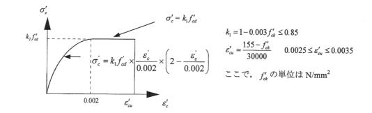
図 3-9 構造部材の非線形特性(M-φ モデルに用いるコンクリートの応力-ひずみ関係) (コンクリート標準示方書より引用)
