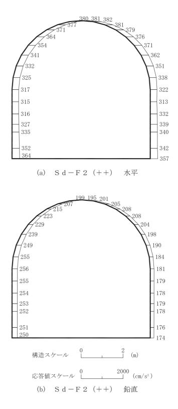
図 4-269 最大加速度分布図 (解析ケース④) (51/56)
