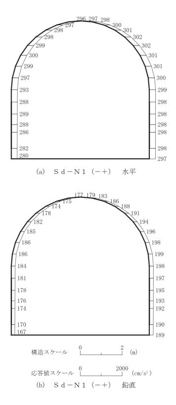
図 4-274 最大加速度分布図 (解析ケース④) (56/56)
