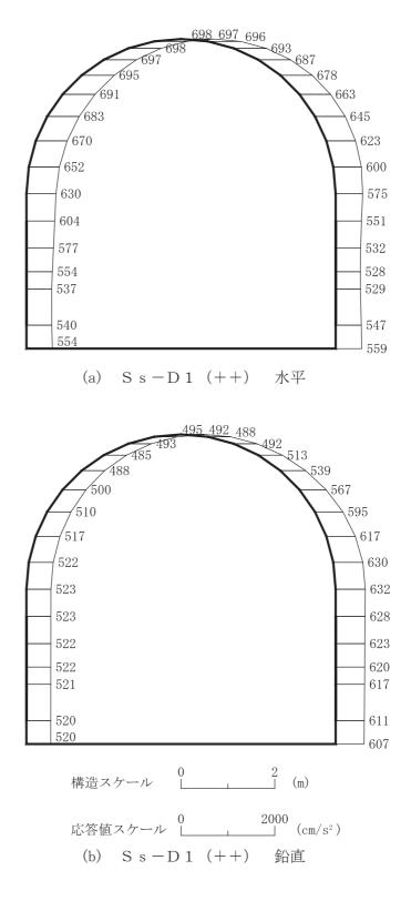
図 4-275 最大加速度分布図 (解析ケース⑧) (1/14)
