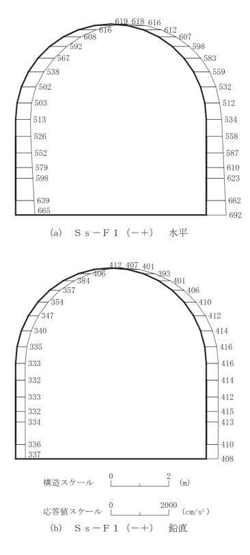
図 4-56 最大加速度分布図 (解析ケース④) (36/42)
