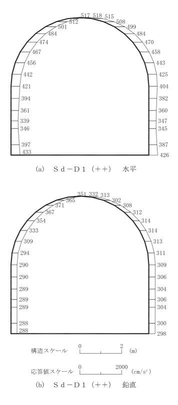
図 4-63 最大加速度分布図 (解析ケース①) (1/56)
