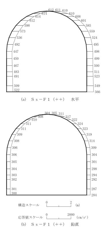
図 4-125 最大加速度分布図(解析ケース⑥)(7/16)
