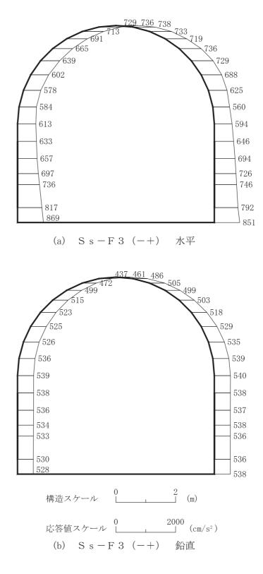
図 4-188 最大加速度分布図(解析ケース②)(26/56)
