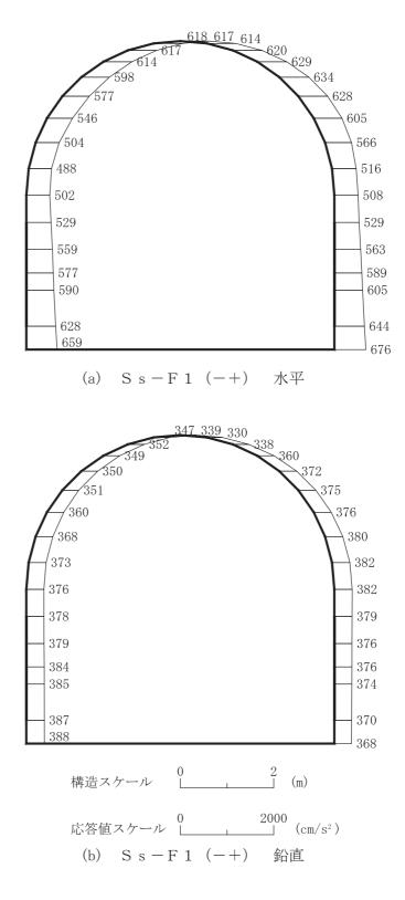
図 4-198 最大加速度分布図(解析ケース③)(36/56)
