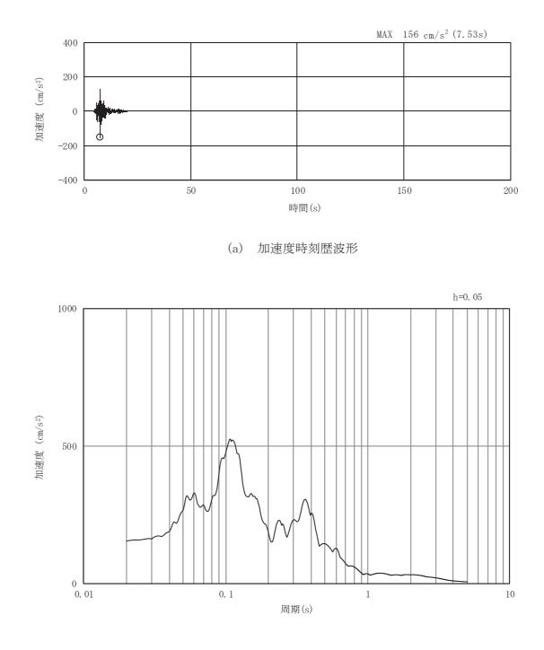
図3-67 土砂部(断面③)の入力地震動の加速度時刻歴波形及び加速度応答スペクトル(28/28) (鉛直成分: Sd-N1)
