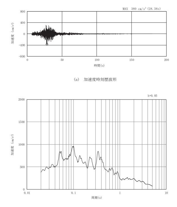
図3-21 土砂部(断面①)の入力地震動の加速度時刻歴波形及び加速度応答スペクトル(10/28) (鉛直成分:Ss-F2)
