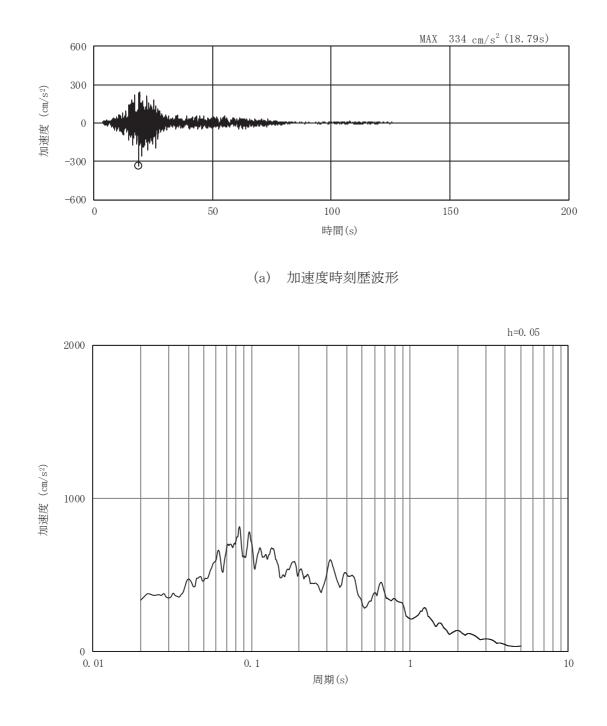
図3-32 土砂部(断面①)の入力地震動の加速度時刻歴波形及び加速度応答スペクトル(21/28) (水平成分: Sd-F1)
