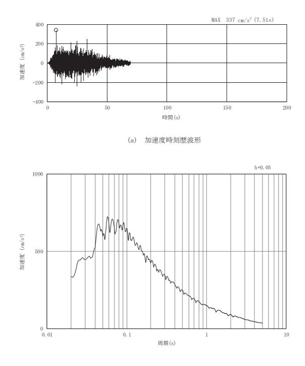
図3-59 土砂部(断面③)の入力地震動の加速度時刻歴波形及び加速度応答スペクトル(20/28) (鉛直成分: Sd-D3)
