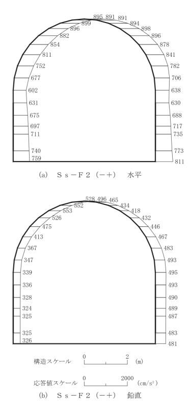
図 4-214 最大加速度分布図(解析ケース④)(52/56)
