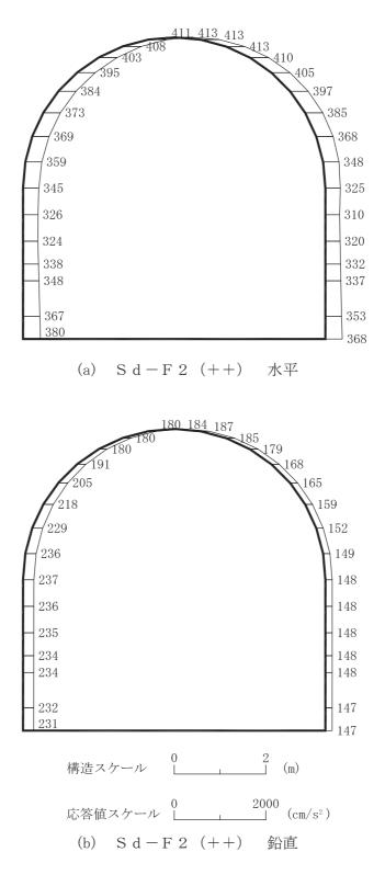
図 4-71 最大加速度分布図 (解析ケース①) (9/56)
