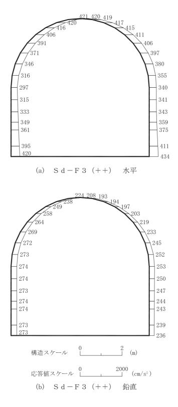
図 4-271 最大加速度分布図 (解析ケース④) (53/56)
