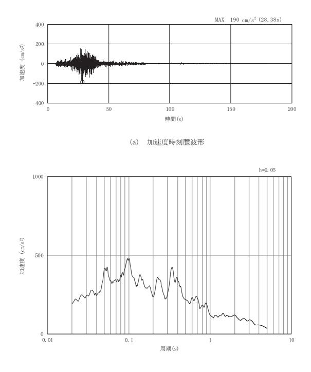
図3-63 土砂部(断面③)の入力地震動の加速度時刻歴波形及び加速度応答スペクトル(24/28) (鉛直成分: Sd-F2)
