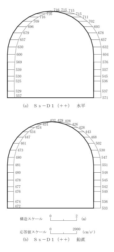
図 4-119 最大加速度分布図(解析ケース⑥)(1/16)
