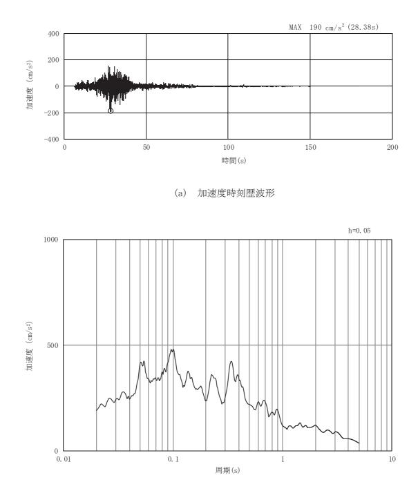
図3-35 土砂部(断面①)の入力地震動の加速度時刻歴波形及び加速度応答スペクトル(24/28) (鉛直成分: Sd-F2)
