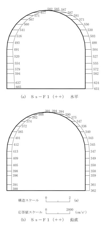
図 4-197 最大加速度分布図(解析ケース③)(35/56)
