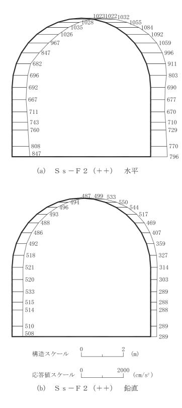
図 4-29 最大加速度分布図 (解析ケース②) (9/42)
