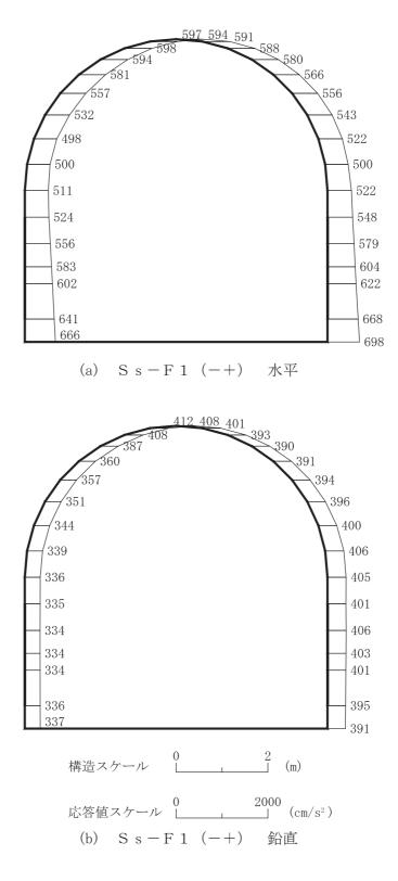
図 4-42 最大加速度分布図 (解析ケース③) (22/42)
