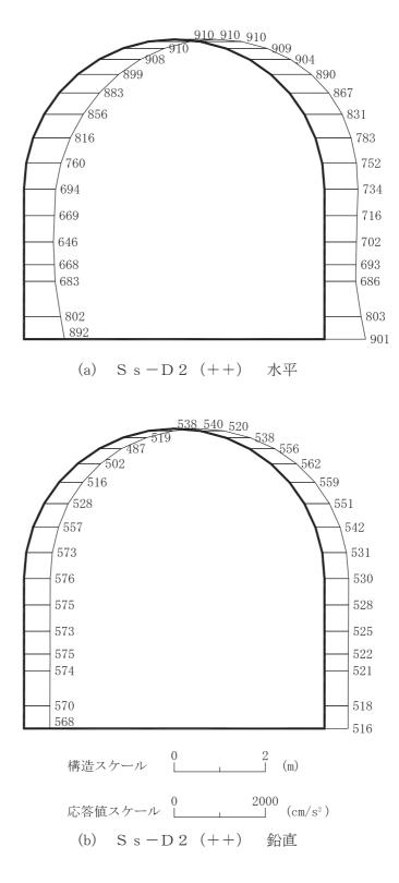
図 4-23 最大加速度分布図(解析ケース②)(3/42)
