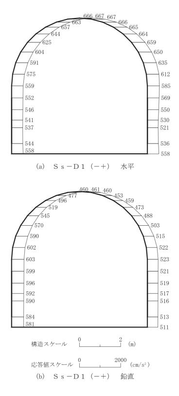
図 4-276 最大加速度分布図 (解析ケース⑧) (2/14)
