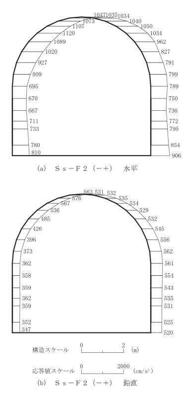
図 4-30 最大加速度分布図(解析ケース②)(10/42)
