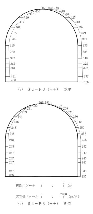
図 4-87 最大加速度分布図 (解析ケース②) (25/56)
