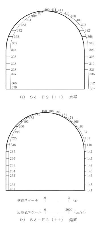
図 4-99 最大加速度分布図(解析ケース③)(37/56)
