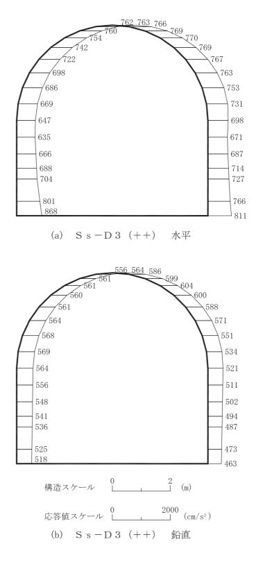
図 4-167 最大加速度分布図 (解析ケース①) (5/56)
