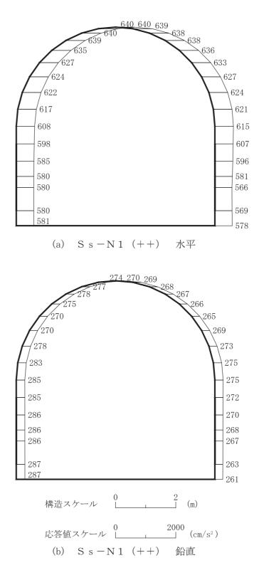
図 4-131 最大加速度分布図(解析ケース⑥)(13/16)
