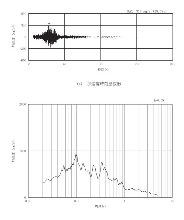
図3-62 土砂部(断面③)の入力地震動の加速度時刻歴波形及び加速度応答スペクトル(23/28) (水平成分: Sd-F2)
