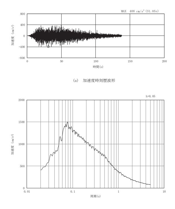
図3-13 土砂部(断面①)の入力地震動の加速度時刻歴波形及び加速度応答スペクトル(2/28) (鉛直成分: Ss-D1)
