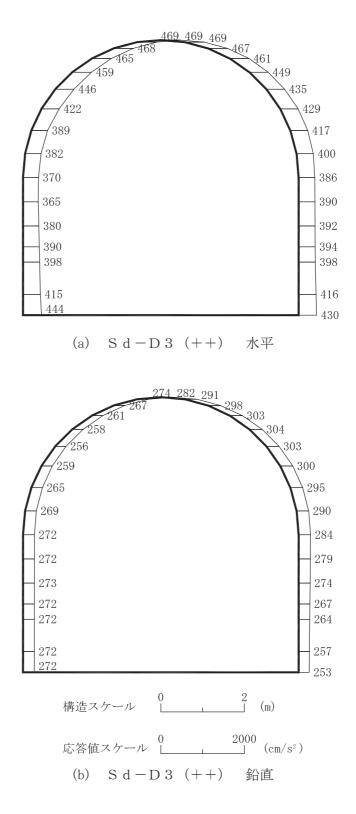
図 4-237 最大加速度分布図 (解析ケース②) (19/56)
