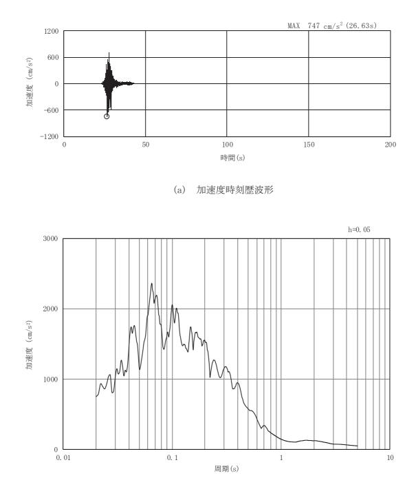
図3-78 岩盤部(断面⑤)の入力地震動の加速度時刻歴波形及び加速度応答スペクトル(11/28) (水平成分:Ss-F3)
