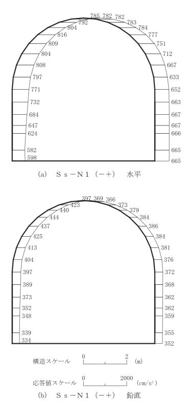
図 4-62 最大加速度分布図 (解析ケース④) (42/42)
