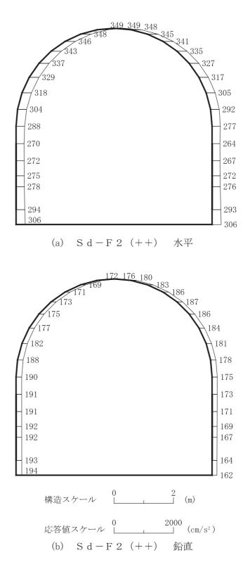
図 4-157 最大加速度分布図 (解析ケース⑧) (9/14)
