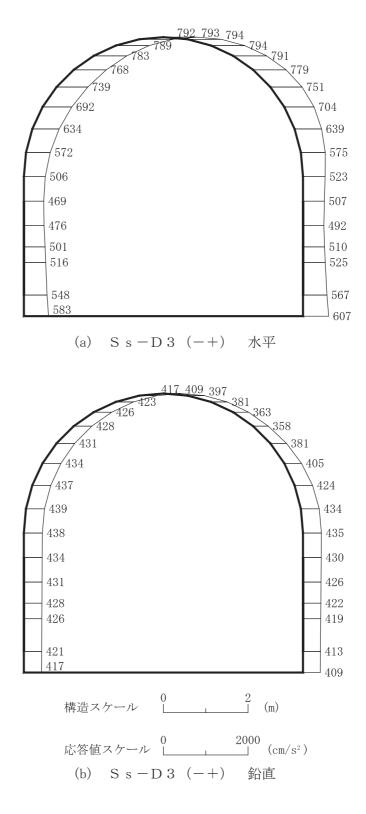
図 4-140 最大加速度分布図(解析ケース⑧)(6/14)
