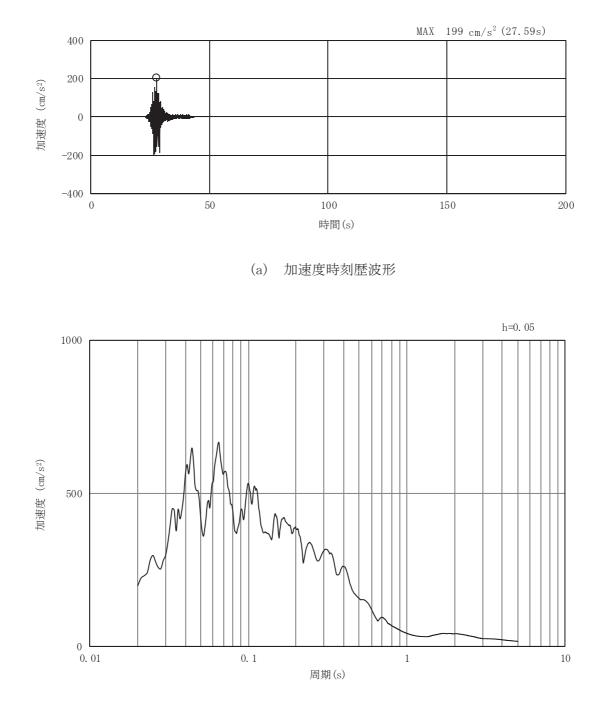
図3-93 岩盤部(断面⑤)の入力地震動の加速度時刻歴波形及び加速度応答スペクトル(26/28) (鉛直成分:Sd-F3)
