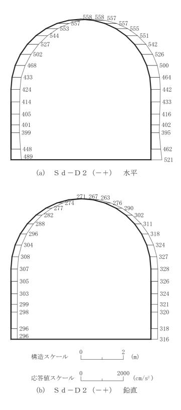
図 4-94 最大加速度分布図 (解析ケース③) (32/56)
