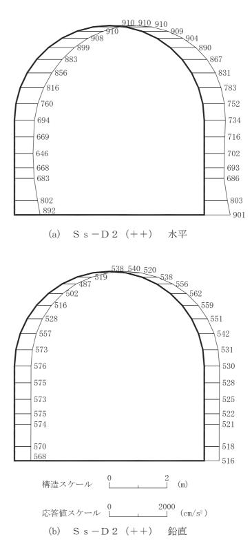
図 4-15 最大加速度分布図 (解析ケース②:曲げ・軸力系の破壊に対する最大照査値ケース)(15/20)
