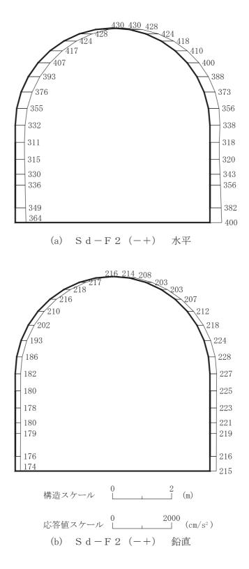
図 4-114 最大加速度分布図(解析ケース④)(52/56)
