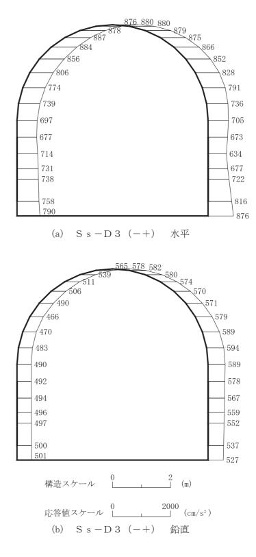
図 4-40 最大加速度分布図(解析ケース③)(20/42)
