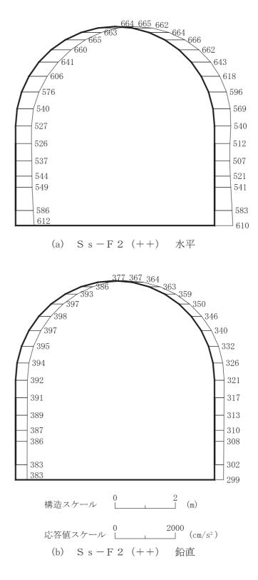
図 4-143 最大加速度分布図 (解析ケース⑧) (9/14)
