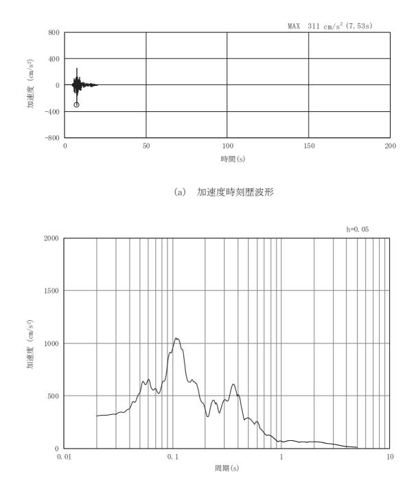
図3-53 土砂部(断面③)の入力地震動の加速度時刻歴波形及び加速度応答スペクトル(14/28) (鉛直成分:Ss-N1)
