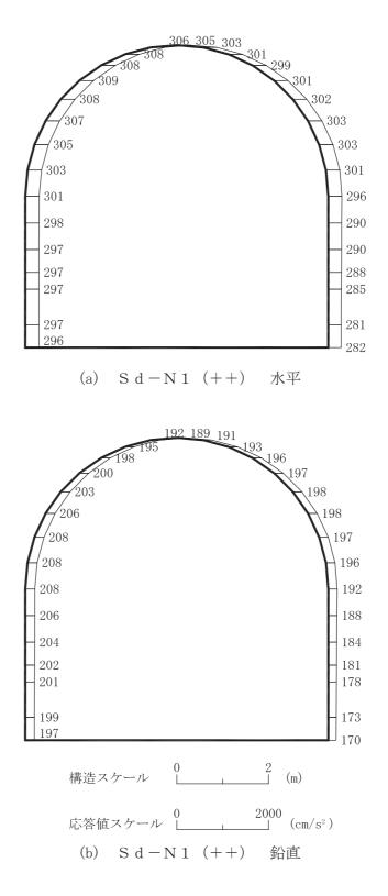
図 4-245 最大加速度分布図(解析ケース②)(27/56)
