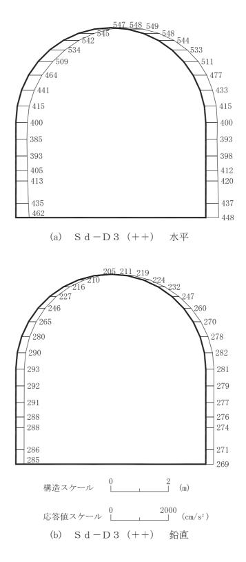
図 4-109 最大加速度分布図 (解析ケース④) (47/56)
