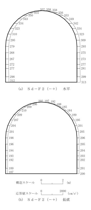
図 4-158 最大加速度分布図(解析ケース⑧)(10/14)
