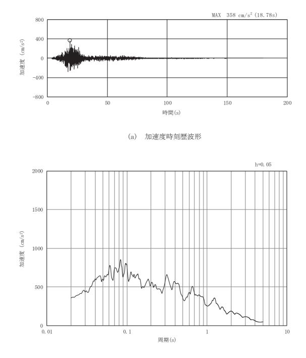
図3-19 土砂部(断面①)の入力地震動の加速度時刻歴波形及び加速度応答スペクトル(8/28) (鉛直成分:Ss-F1)
