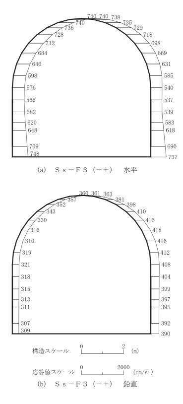
図 4-130 最大加速度分布図(解析ケース⑥)(12/16)
