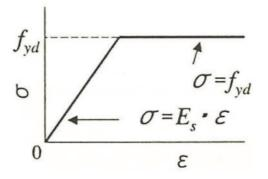
図 3-10 鉄筋の応力-ひずみ関係 (コンクリート標準示方書[構造性能照査編](土木学会,2002 年制定)より引用)
