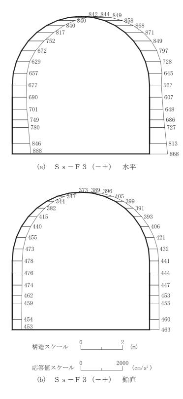
図 4-60 最大加速度分布図 (解析ケース④) (40/42)
