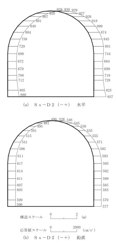
図 4-52 最大加速度分布図(解析ケース④)(32/42)
