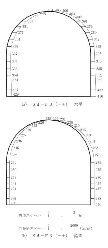
図 4-230 最大加速度分布図 (解析ケース①) (12/56)
