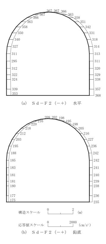
図 4-256 最大加速度分布図(解析ケース③)(38/56)
