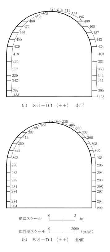
図 4-77 最大加速度分布図 (解析ケース②) (15/56)
