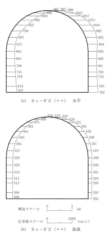
図 4-43 最大加速度分布図 (解析ケース③) (23/42)
