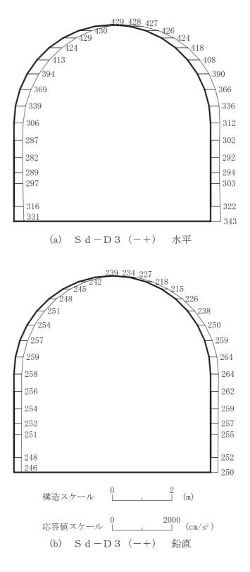
図 4-154 最大加速度分布図(解析ケース⑧)(6/14)
