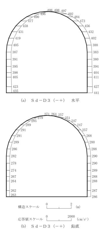
図 4-266 最大加速度分布図(解析ケース④)(48/56)
