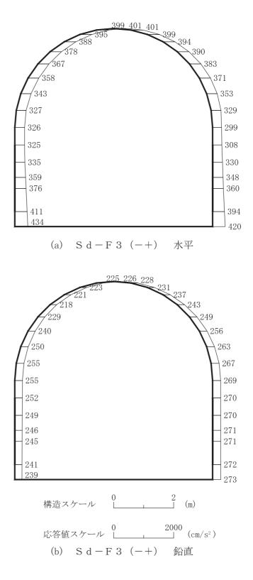
図 4-258 最大加速度分布図(解析ケース③)(40/56)
