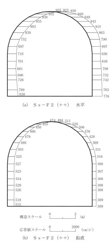
図 4-213 最大加速度分布図(解析ケース④)(51/56)
