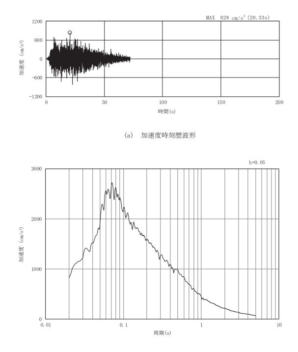
図3-14 土砂部(断面①)の入力地震動の加速度時刻歴波形及び加速度応答スペクトル(3/28) (水平成分: Ss-D2)
