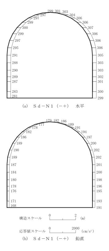
図 4-246 最大加速度分布図(解析ケース②)(28/56)
