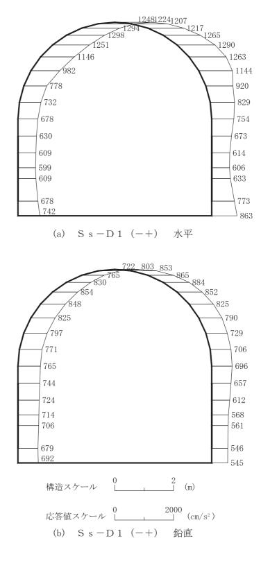
図 4-50 最大加速度分布図 (解析ケース④) (30/42)
