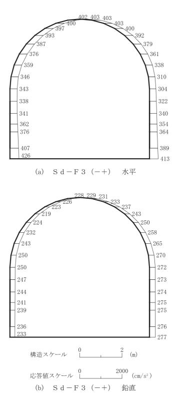
図 4-244 最大加速度分布図 (解析ケース②) (26/56)
