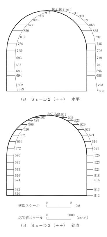
図 4-51 最大加速度分布図 (解析ケース④) (31/42)
