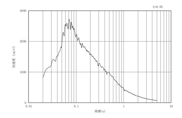
図3-42 土砂部(断面③)の入力地震動の加速度時刻歴波形及び加速度応答スペクトル(3/28) (水平成分: Ss-D2)
