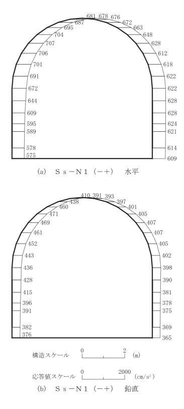
図 4-190 最大加速度分布図(解析ケース②)(28/56)
