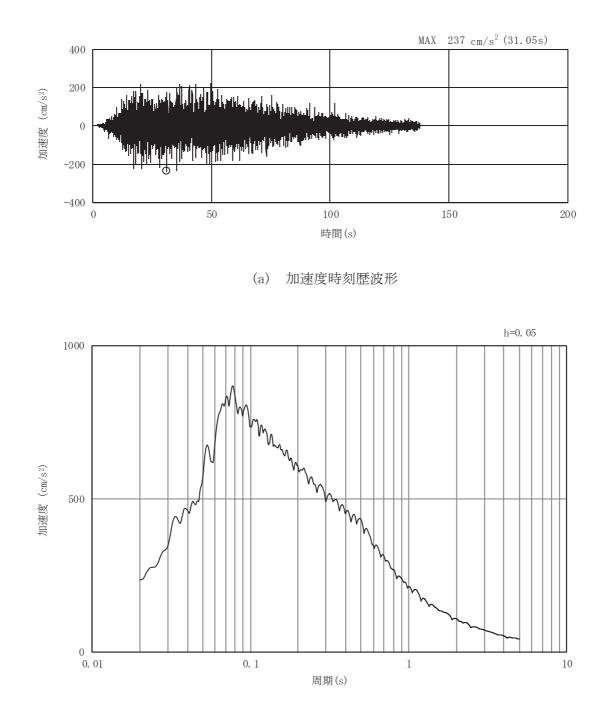
図3-55 土砂部(断面③)の入力地震動の加速度時刻歴波形及び加速度応答スペクトル(16/28) (鉛直成分: Sd-D1)
