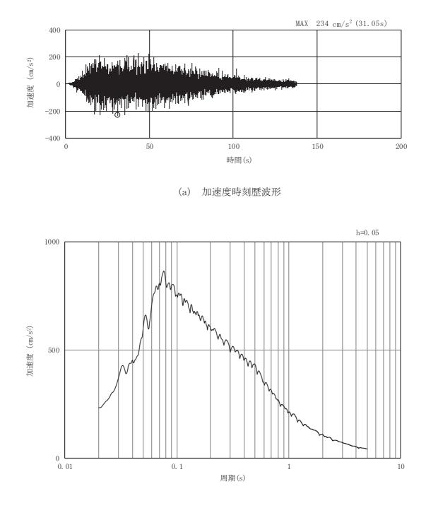
図3-83 岩盤部(断面⑤)の入力地震動の加速度時刻歴波形及び加速度応答スペクトル(16/28) (鉛直成分:Sd-D1)
