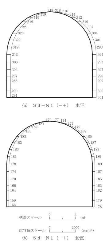
図 4-90 最大加速度分布図(解析ケース②)(28/56)
