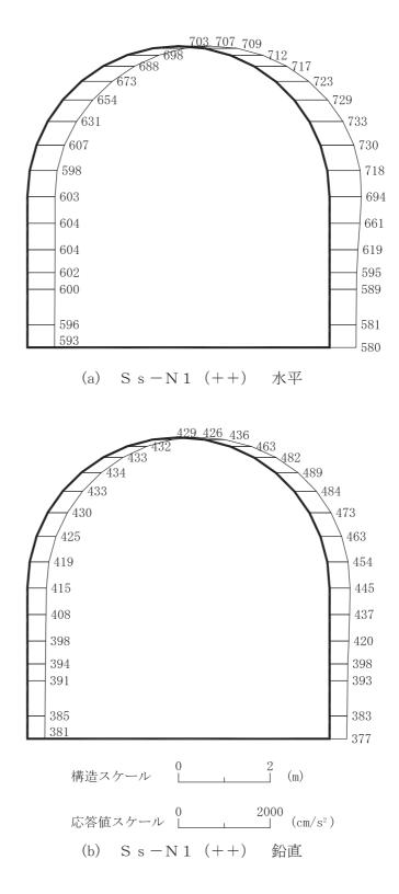
図 4-203 最大加速度分布図(解析ケース③)(41/56)
