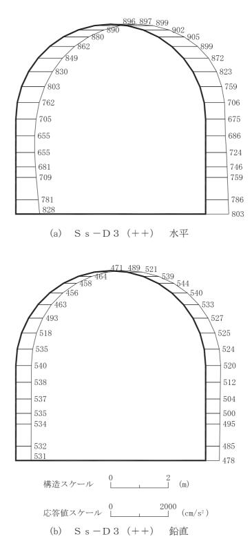
図 4-25 最大加速度分布図(解析ケース②)(5/42)
