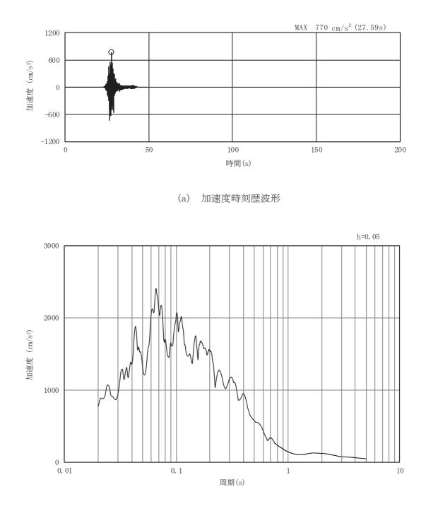
図3-50 土砂部(断面③)の入力地震動の加速度時刻歴波形及び加速度応答スペクトル(11/28) (水平成分:Ss-F3)
