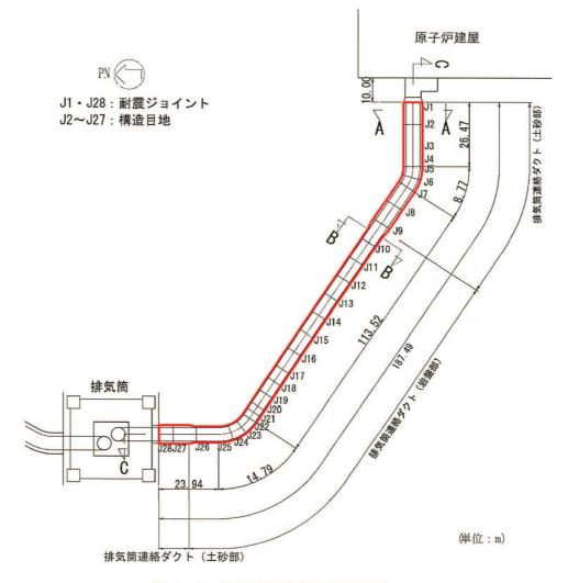
図 2-2 排気筒連絡ダクト平面図
