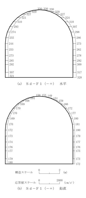
図 4-226 最大加速度分布図(解析ケース①)(8/56)
