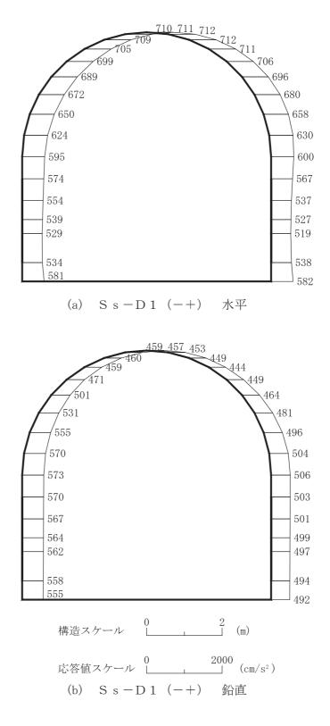
図 4-120 最大加速度分布図(解析ケース⑥)(2/16)
