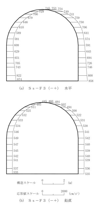
図 4-174 最大加速度分布図 (解析ケース①) (12/56)
