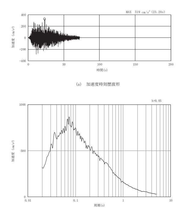
図3-29 土砂部(断面①)の入力地震動の加速度時刻歴波形及び加速度応答スペクトル(18/28) (鉛直成分: Sd-D2)
