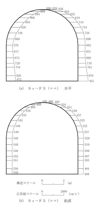
図 4-31 最大加速度分布図(解析ケース②)(11/42)
