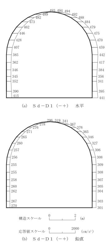
図 4-92 最大加速度分布図(解析ケース③)(30/56)
