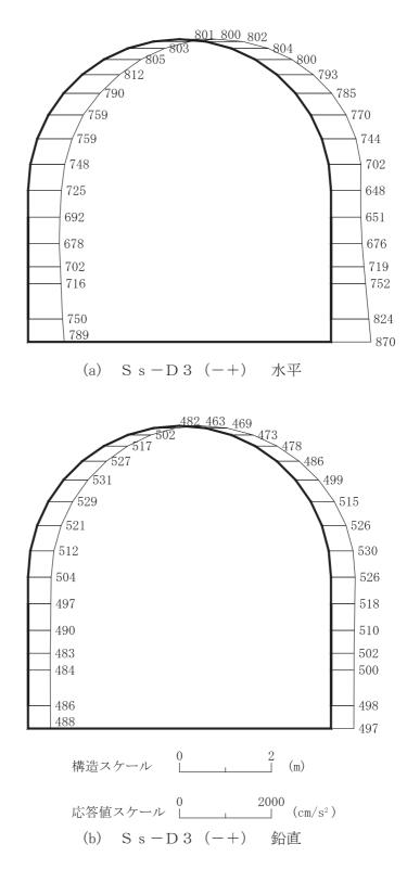
図 4-210 最大加速度分布図 (解析ケース④) (48/56)
