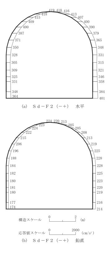
図 4-72 最大加速度分布図 (解析ケース①) (10/56)
