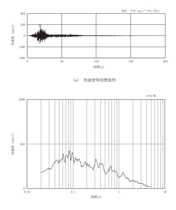
図3-61 土砂部(断面③)の入力地震動の加速度時刻歴波形及び加速度応答スペクトル(22/28) (鉛直成分:Sd-F1)
