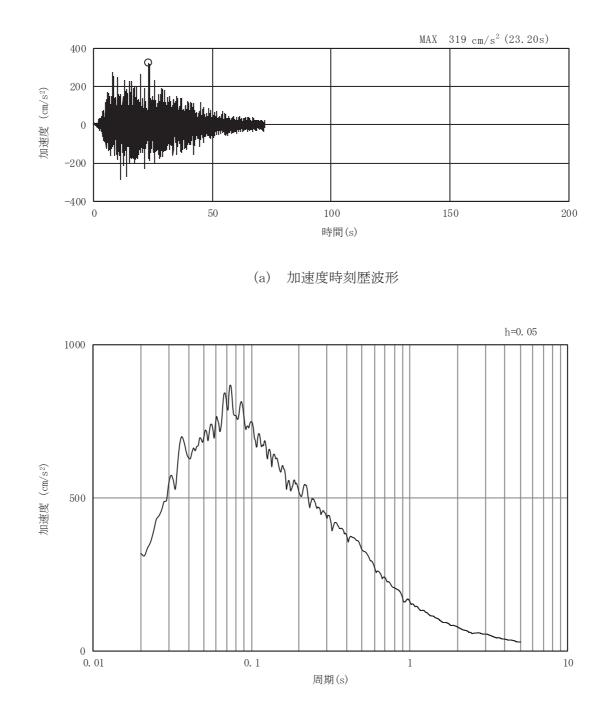
図3-57 土砂部(断面③)の入力地震動の加速度時刻歴波形及び加速度応答スペクトル(18/28) (鉛直成分: Sd-D2)
