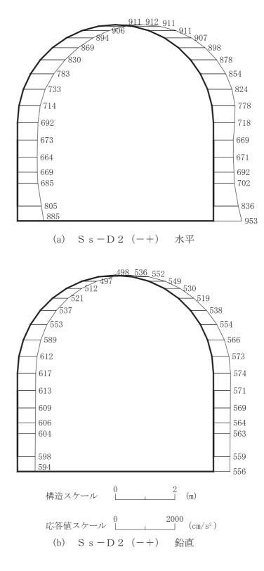
図 4-38 最大加速度分布図(解析ケース③)(18/42)
