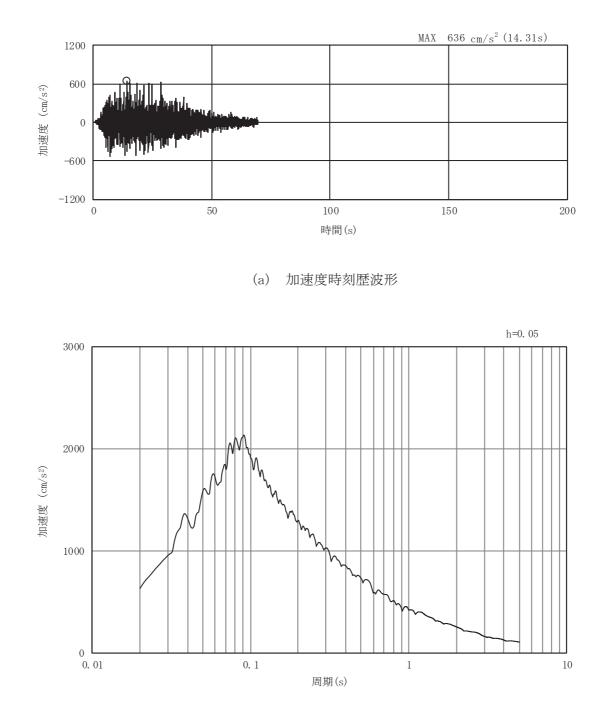
図3-44 土砂部(断面③)の入力地震動の加速度時刻歴波形及び加速度応答スペクトル(5/28) (水平成分: Ss-D3)
