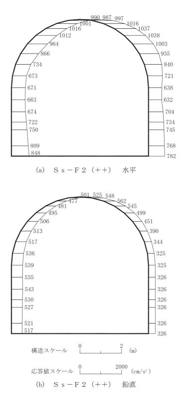
図 4-199 最大加速度分布図 (解析ケース③) (37/56)
