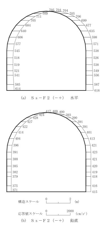
図 4-128 最大加速度分布図(解析ケース⑥)(10/16)
