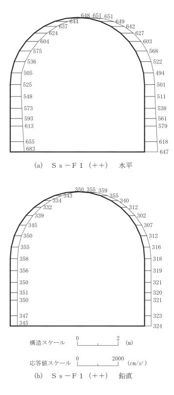
図 4-55 最大加速度分布図 (解析ケース④ (35/42))
