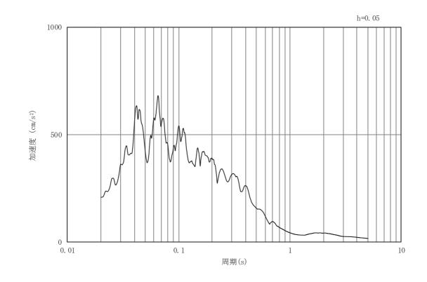
図3-37 土砂部(断面①)の入力地震動の加速度時刻歴波形及び加速度応答スペクトル(26/28) (鉛直成分: Sd-F3)
