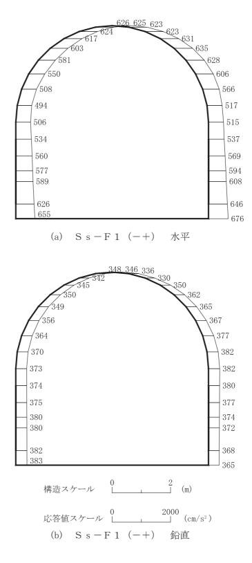
図 4-212 最大加速度分布図(解析ケース④)(50/56)
