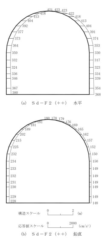
図 4-113 最大加速度分布図 (解析ケース④) (51/56)
