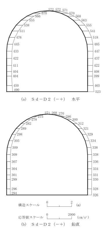
図 4-80 最大加速度分布図 (解析ケース②) (18/56)
