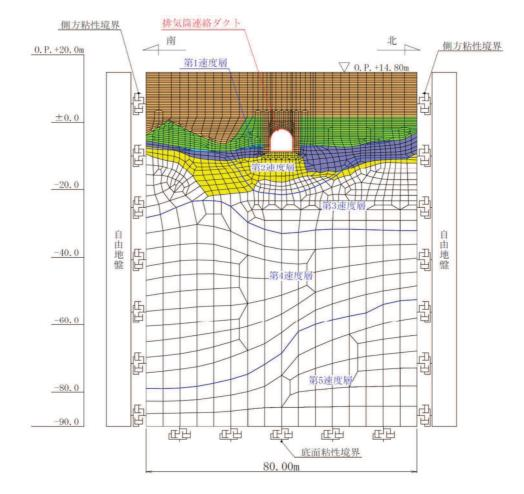
図 3-97 排気筒連絡ダクトの地震応答解析モデル図(土砂部(断面③))
