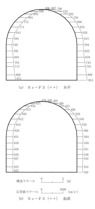
図 4-201 最大加速度分布図(解析ケース③)(39/56)
