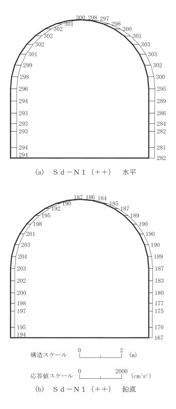
図 4-273 最大加速度分布図 (解析ケース④) (55/56)
