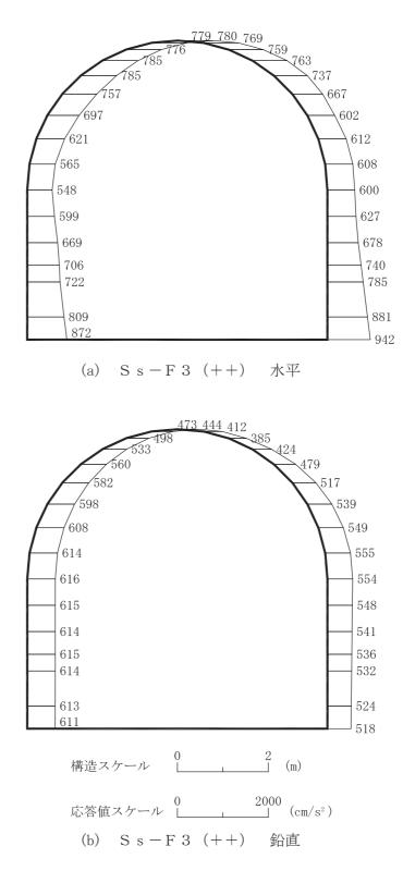
図 4-173 最大加速度分布図(解析ケース①)(11/56)
