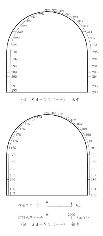
図 4-118 最大加速度分布図(解析ケース④)(56/56)
