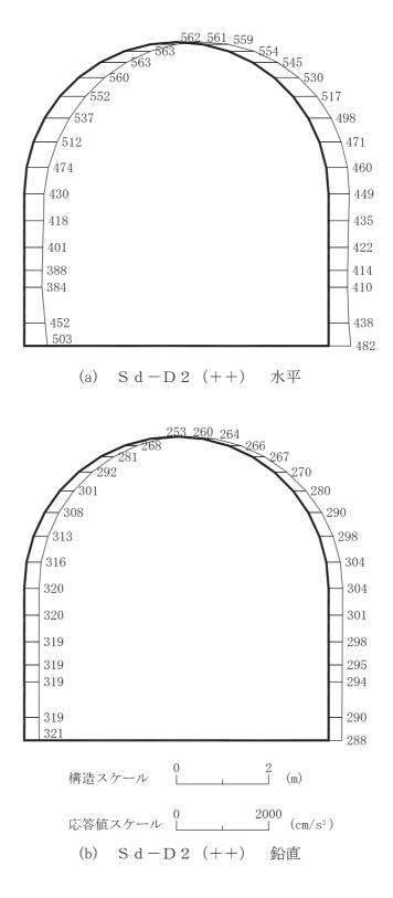
図 4-79 最大加速度分布図 (解析ケース②) (17/56)
