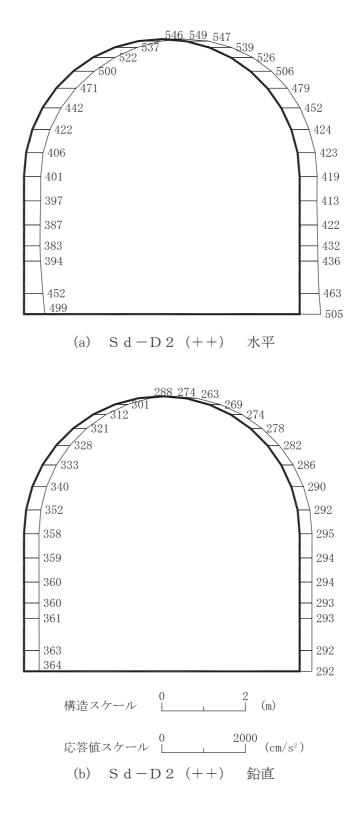
図 4-235 最大加速度分布図(解析ケース②)(17/56)
