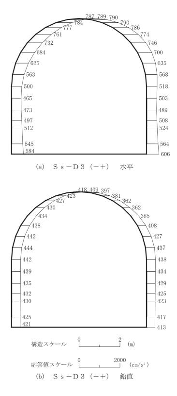
図 4-124 最大加速度分布図 (解析ケース⑥) (6/16)
