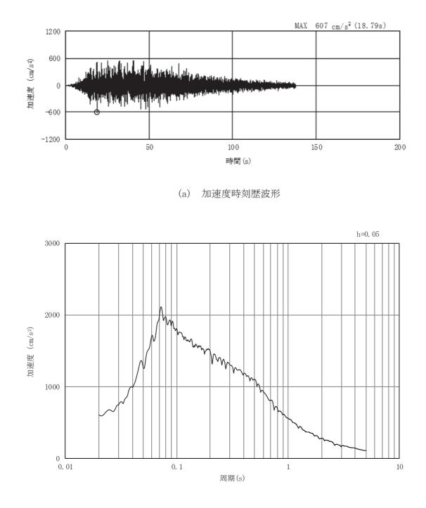
図3-68 岩盤部(断面⑤)の入力地震動の加速度時刻歴波形及び加速度応答スペクトル(1/28) (水平成分:Ss-D1)
