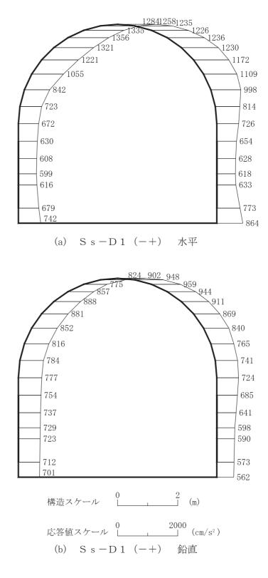
図 4-22 最大加速度分布図(解析ケース②)(2/42)
