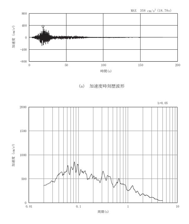
図3-47 土砂部(断面③)の入力地震動の加速度時刻歴波形及び加速度応答スペクトル(8/28) (鉛直成分:Ss-F1)
