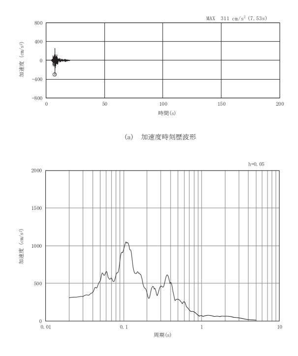
図3-25 土砂部(断面①)の入力地震動の加速度時刻歴波形及び加速度応答スペクトル(14/28) (鉛直成分:Ss-N1)
