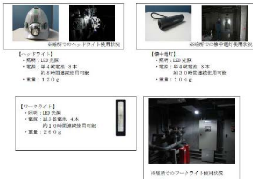
図4 可搬型照明の仕様及び使用状況
