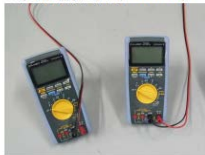
可搬型計測器
