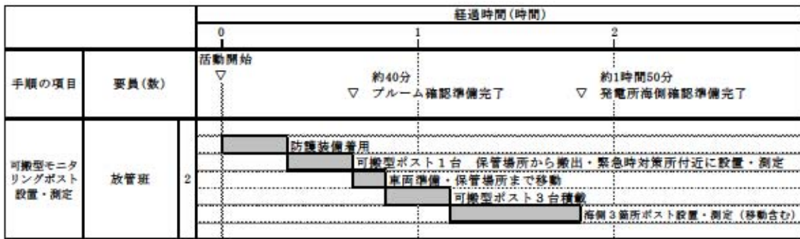
第1.17.5図：可搬型モニタリングポスト設置・測定 タイムチャート (発電所海側及び緊急時対策所付近への設置)
