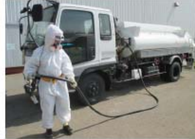
可搬型タンクローリー給油用ホース引出し (屋外 T.P. 31m)
