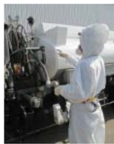
可搬型タンクローリー給油用ホース引出し (屋外 T. P. 31m)
