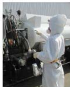
可搬型タンクローリー給油用ホース引出し (屋外 T.P. 31m)
