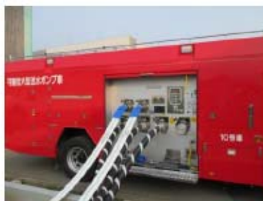
可搬型大型送水ポンプ車 周辺のホース敷設 (屋外 T. P. 10m)
