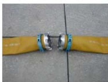
可搬型ホース (150A) 接続口
