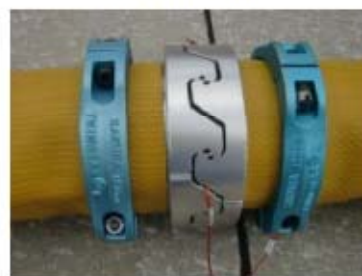
可搬型ホース(150A)接続後
