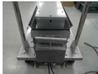
可搬型エリアモニタ 検出器側
