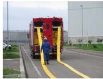
ホース延長・回収車による可搬型ホース敷設 (屋外 T. P. 10m)
