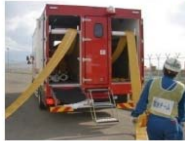
ホース延長・回収車による可搬型ホース敷設 (屋外 T. P. 31m)
