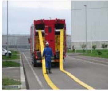
ホース延長・回収車による 可搬型ホース敷設 (屋外 T. P. 10m)
