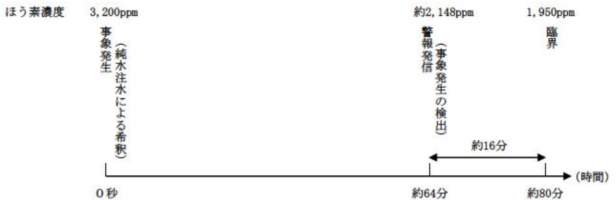
第7.4.4.4図 反応度の誤投入時の臨界到達時間評価結果
