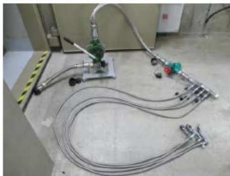
潤滑油供給器及び継手類一式 (タービン動補助給水ポンプ室に常設)
