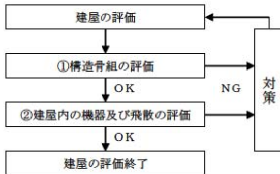
図 4.4 竜巻防護施設に波及的影響を及ぼし得る建屋の評価フロー
