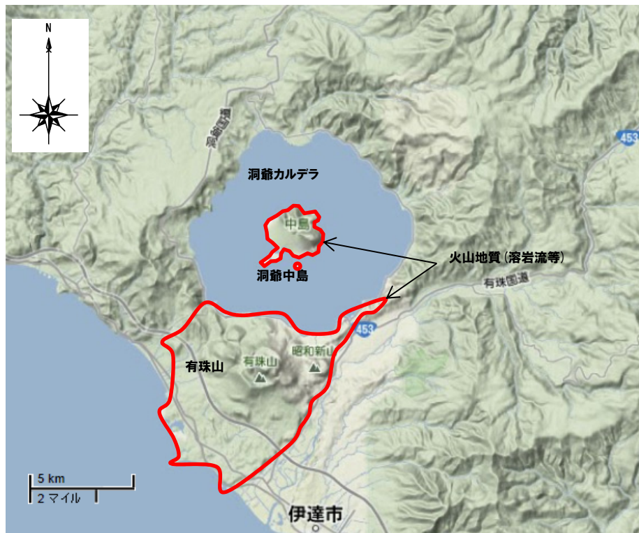
洞爺中島及び有珠山の火山地質分布 (火山地質については中野ほか編 (2013) をトレース)
