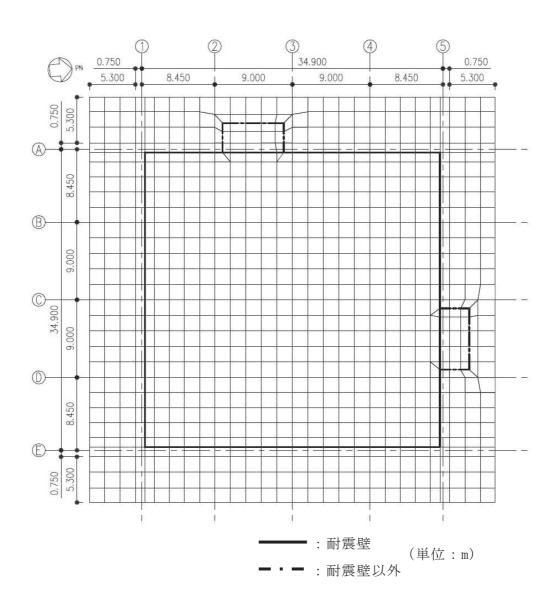
図 4-3 基礎版の解析モデル図
