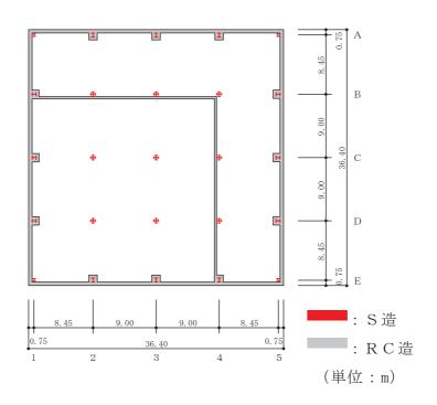
図 2-2(4) 緊急時対策建屋の概略平面図 (0. P. 69. 4m)
