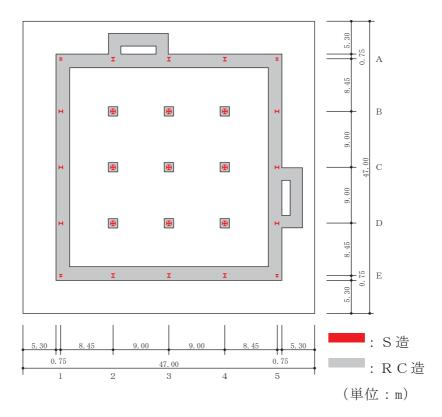
図 2-2(1) 緊急時対策建屋の概略平面図 (0. P. 51. 5m)
