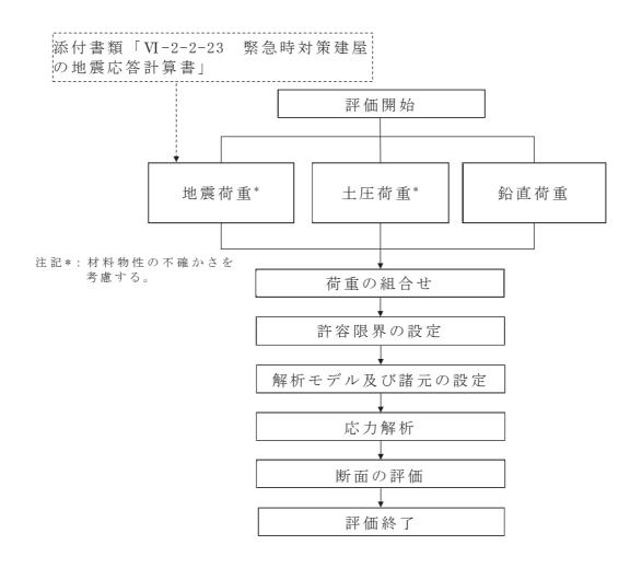
図 4-1 応力解析による評価フロー
