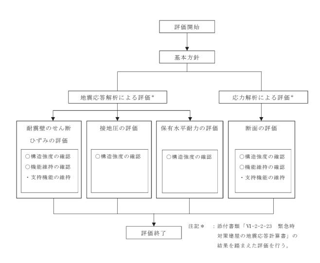
図 2-4 緊急時対策建屋の評価フロー
