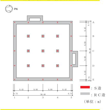
図 2-2(2) 緊急時対策建屋の概略平面図 (0. P. 57. 3m)
