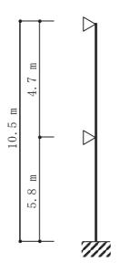
図3-3 ケーブルピット部壁の解析モデル図
