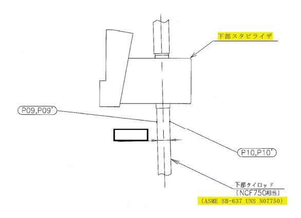
C 部詳細 : 応力評価点 [ ]: 材 料
