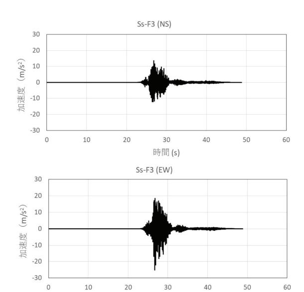
図3-3(6) 時刻歴加速度波形 (ケース1 (基本ケース), Ss-F3)
