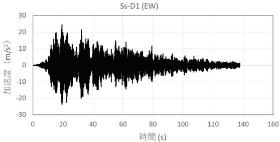
図3-3(1) 時刻歴加速度波形 (ケース1 (基本ケース), Ss-D1)
