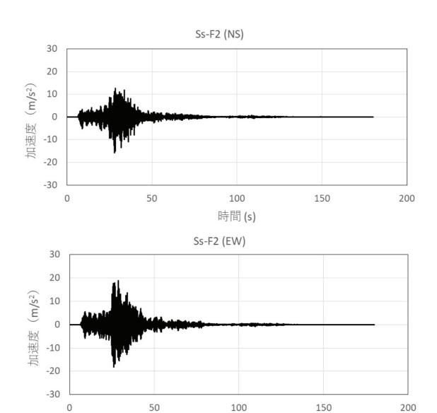
図3-3(5) 時刻歴加速度波形 (ケース1 (基本ケース), Ss-F2)
