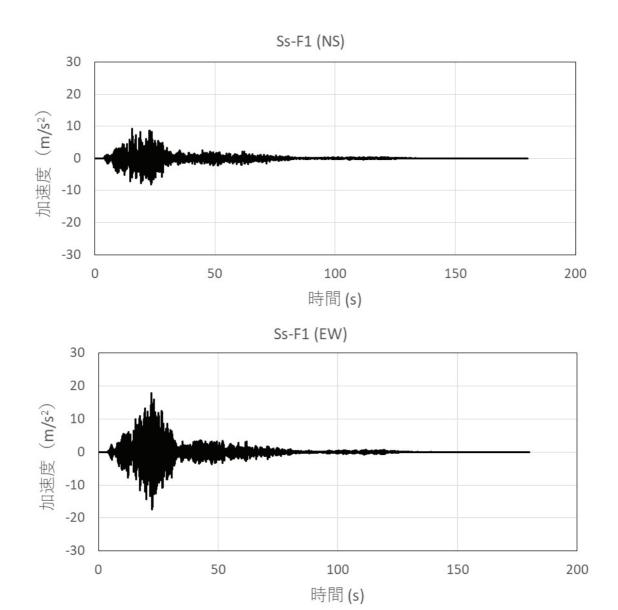
図3-3(4) 時刻歴加速度波形 (ケース1 (基本ケース), Ss-F1)
