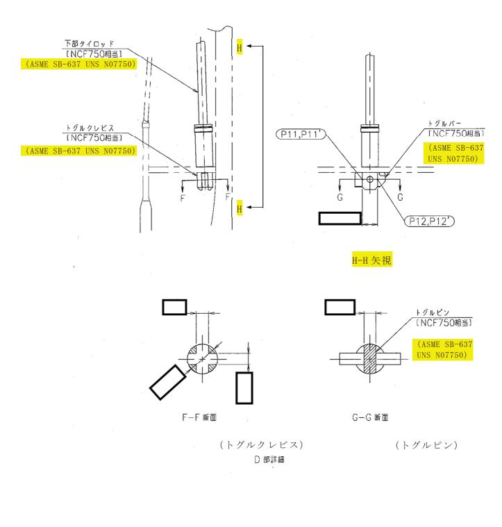
図 1-1(5) 形状・寸法・材料・応力評価点(単位: mm)
