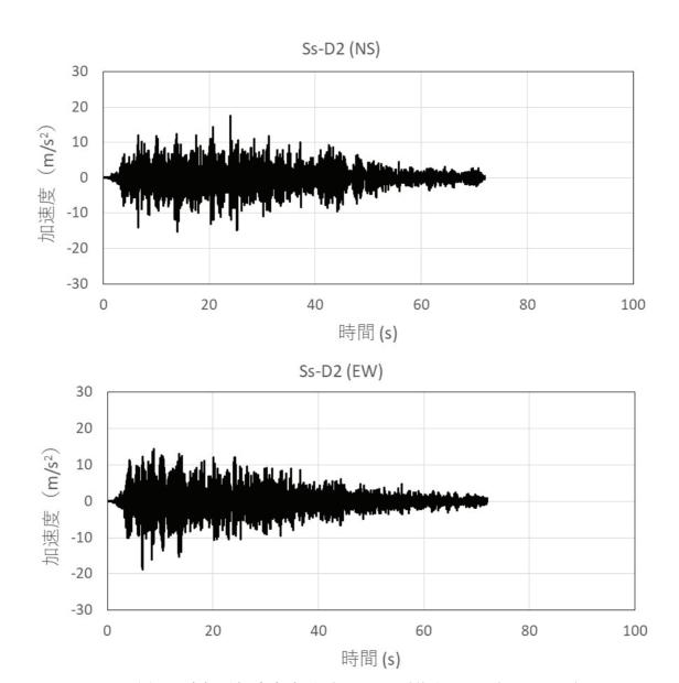
図3-3(2) 時刻歴加速度波形 (ケース1 (基本ケース), Ss-D2)
