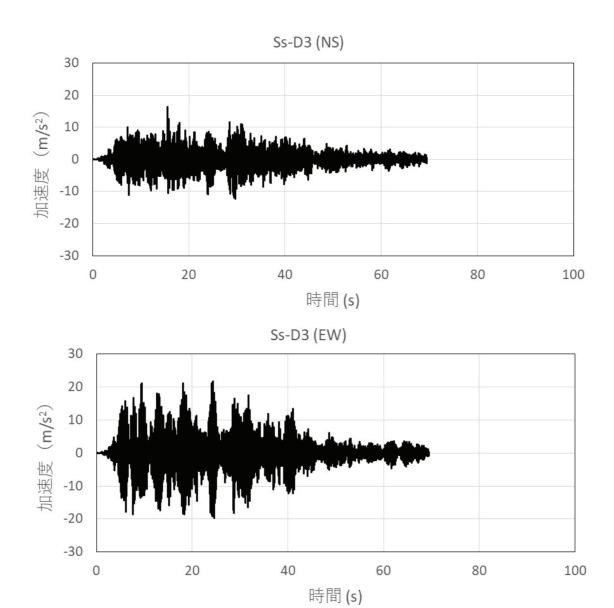
図3-3(3) 時刻歴加速度波形 (ケース1 (基本ケース), Ss-D3)
