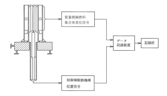
図 4-2 計測装置の概要
