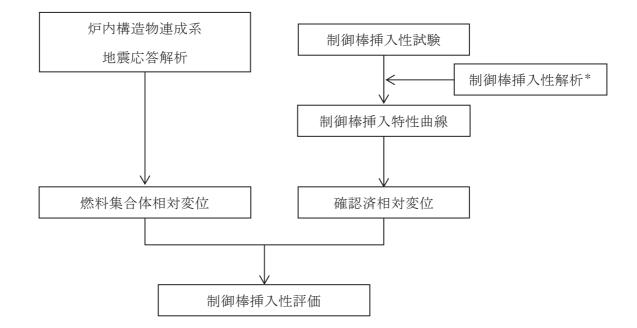
注記\*:制御棒挿入性試験の保守性を確認するため、制御棒挿入性解析を実施。
