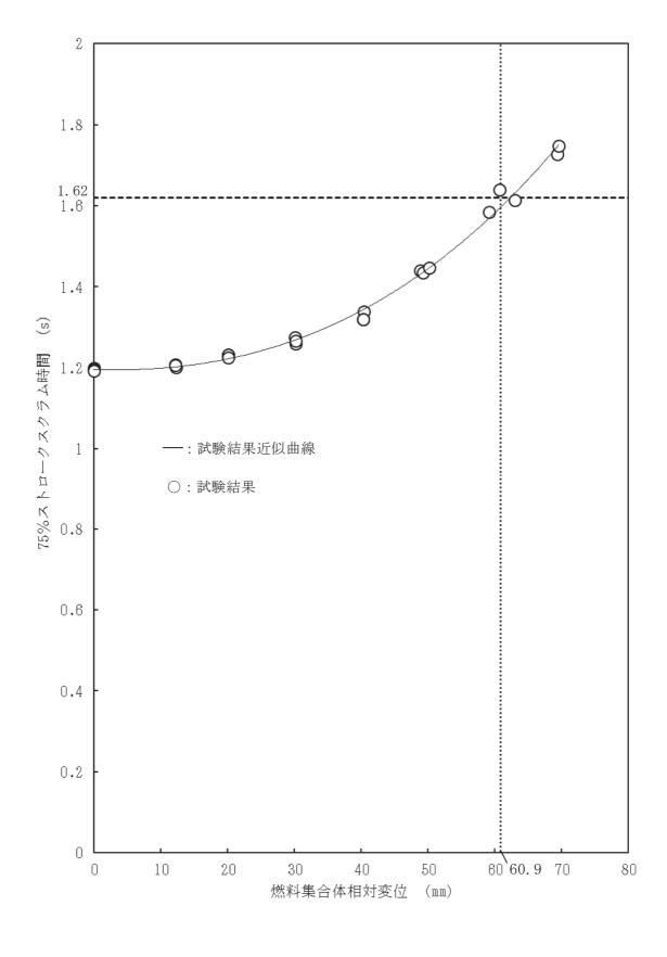
図 4-3 燃料集合体相対変位のスクラム時間に及ぼす影響
