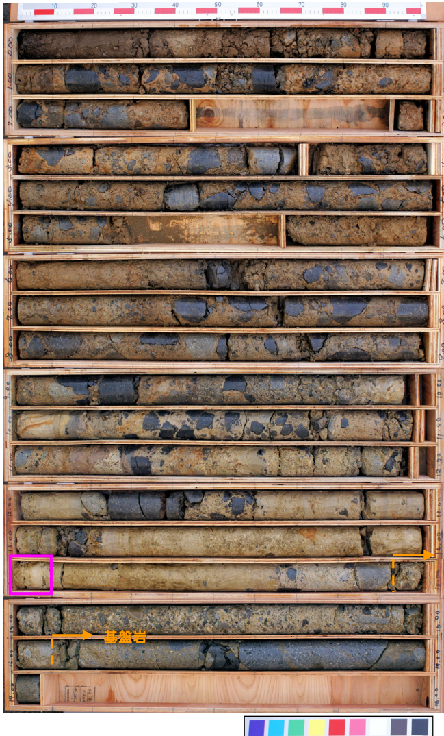
□ : 洞爺火山灰確認位置 (14.0m~14.1m) EL19.1m~19.0m
