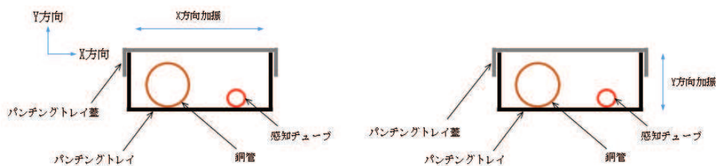
図 4-2 パンチングトレイ内断面図
